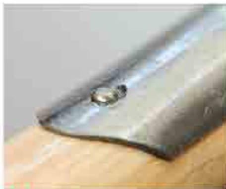
UNSAUBER: Bei SHW stören scharfe Kanten und ein unsauberer Niet.
