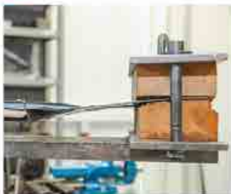
ABGEKNICKT: Das Blatt des Billig-Spatens gab bei Belastung nach.
