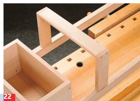
19 Den Bügel durch beide Zapfensen-kungen mit dem Bügel-halter verleimen und verschrauben.
