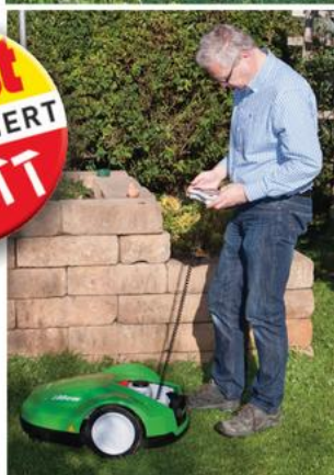
Der Roboter bezieht seine Energie aus einem Li-Ion-Akku, der automatisch geladen wird.
