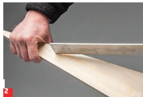
2 Alu auf Holz: Auch das hält gut, ist aber nicht untrennbar – die Verbindung trennt sich sauber, das Holz reißt nicht aus.
