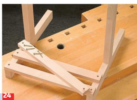
21 Dann runden Sie auch die Streben entsprechend dem Halter vorne ab und brechen die Kanten.
