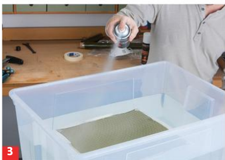
3 Nach etwa 3 Minuten die Folienoberfläche sacht mit dem Aktivatorspray einnebeln.
