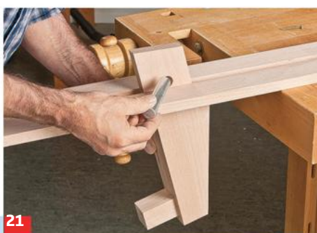
18 Gleiter von oben mittig bis in das 20er Loch hinein durchbohren und senken, dann auch den Rundstab mittig bohren.
