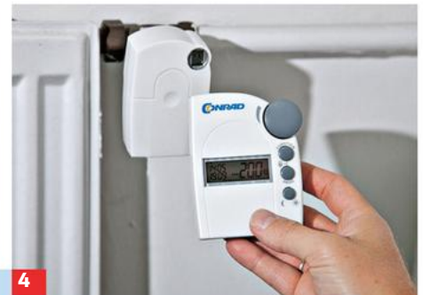
2 ... Installateur und Eingriff in den Wasserkreislauf möglich. Batterien versorgen die Empfänger mit Energie.
