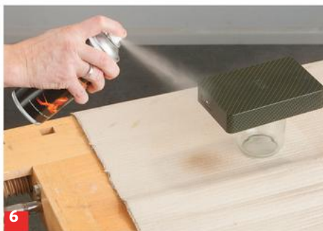
6 Nach intensivem Abspülen mit klarem Wasser trocknen lassen und versiegeln.
