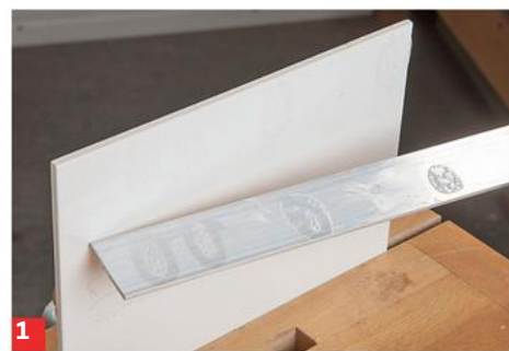
1 Aluleiste auf Fliese: Mit Kleberabstand von 10 cm und nicht zu dicken Klebesträngen hält die Verbindung gut.
