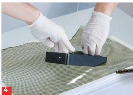
4 Das Objekt in einem schrägen Winkel (Vorderseite voran) durch die Folie tauchen.
