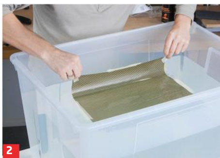
2 Folie zuschneiden, Rand umkleben und seitenrichtig (!) auf das Wasser (31 °C) legen.
