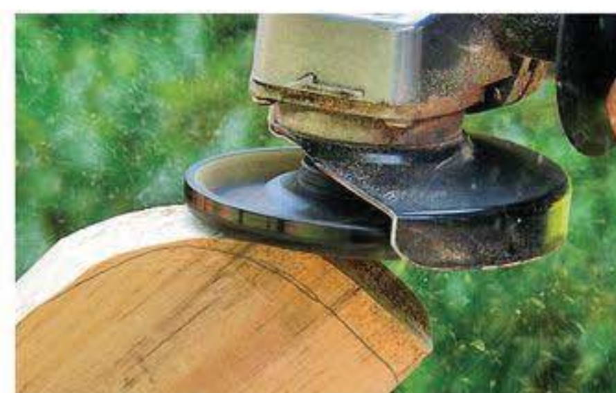
Mit der Frässcheibe lassen sich konvexe und konkave Formen herstellen.
