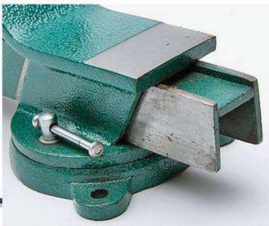
UNSCHÖN: Einige Modelle (hier von HM Müller) zeigen Oberflächenfehler.
