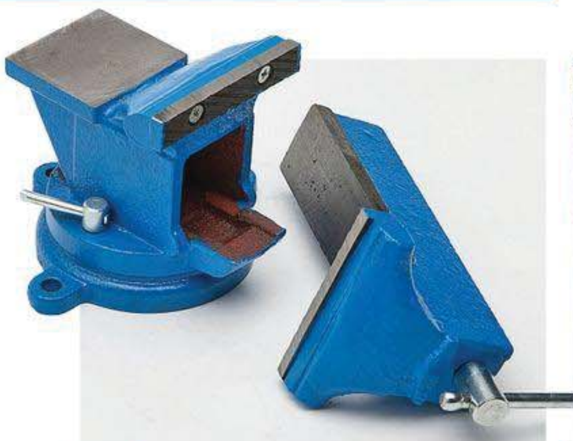
GEFÄHRlich: Ohne Spindelsicherung kann die Vorderbacke herausfallen.
