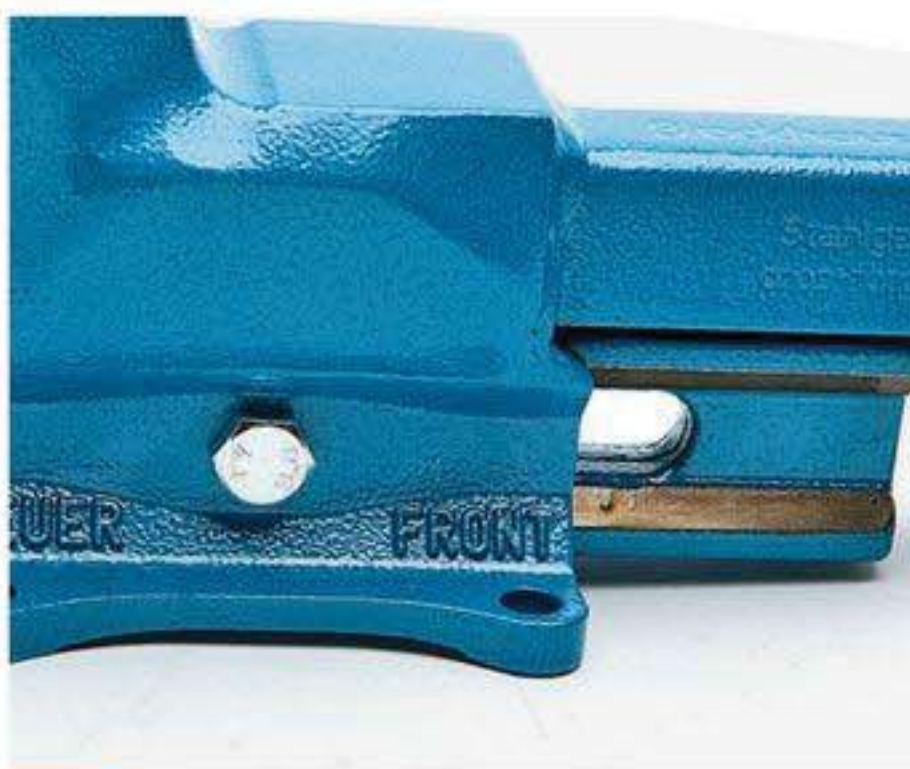
SICHER: Bei Heuer Brockhaus sichert ein Langloch die Vorderbacke.
