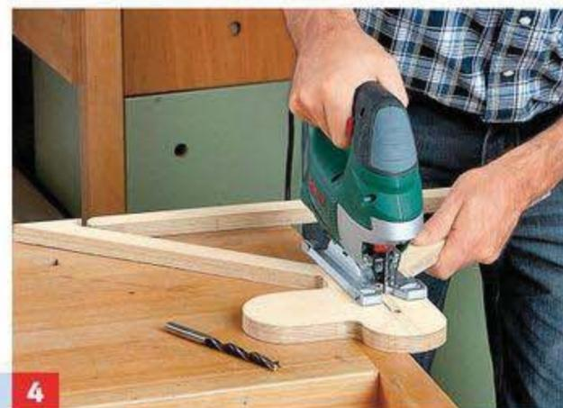
Jetzt ein 10-mm-Loch oberhalb der Dreieckspitze bohren und vom Schirminneren einen entsprechenden Schlitz schneiden.
