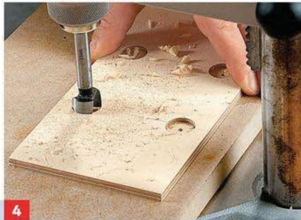
**4** ... das Sensorloch markieren. Mit einem 20-mm-Forstnerbohrer bohren Sie etwa 3 mm tiefe Sacklöcher für die Magneten.
