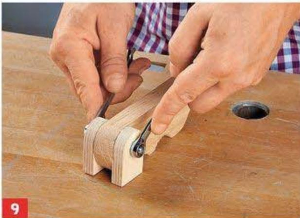
**9** Gewindestange (M6) durchschieben, Unterlegscheiben auflegen und selbstsichernde Muttern – nicht zu fest – anziehen.
