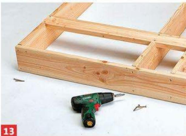
**13** Von unten bekommt der Gerätehalter noch einen "Boden". Löcher vorbohren, anzwingen und verschrauben.
