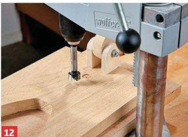
**12** Mit dem Forstnerbohrer werden gleichzeitig zum Hebel zwei verschieden große Sacklöcher gebohrt. Hier sollen ...
