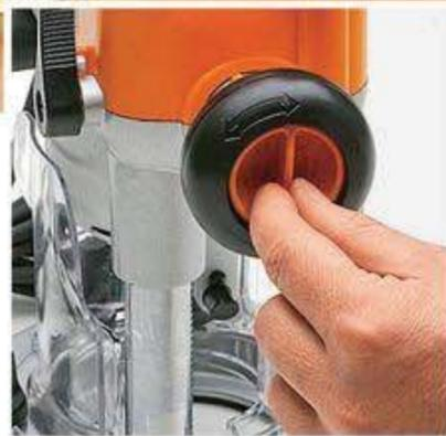
**MONTAGESTELLUNG:** Zum Fräserwechsel wird der Frästisch weit eingefahren.
