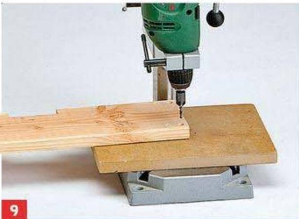
**9** Bohren und senken Sie dann die Löcher zum Verschrauben.
