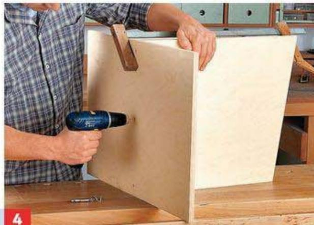
**4** Zwingen Sie Boden und Mittelteil zusammen. Vorbohren und verschrauben. Dann verbinden Sie auch die weiteren ...
