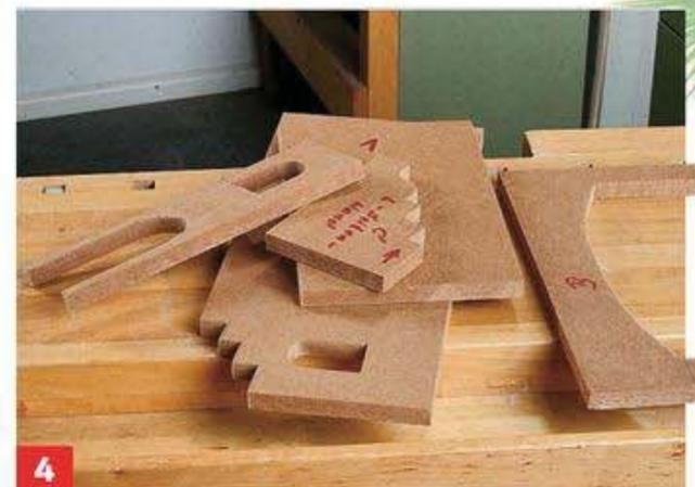
**4** ... schneiden Sie die entsprechenden Wände, Deckel und die Türrahmen-Aufdopplung inklusive der Ausschnitte zu.
