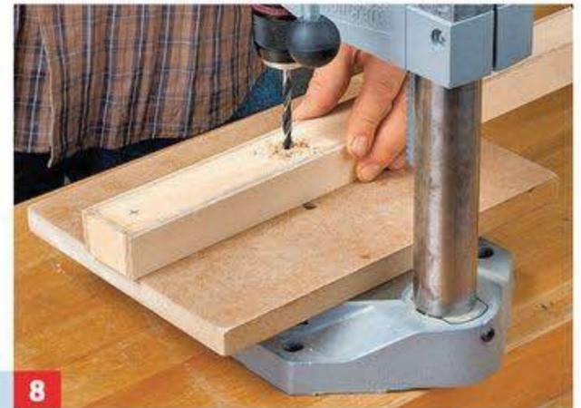
**8** Markieren und bohren Sie die äußeren Befestigungslöcher durch die fünf Sperrholzlagen sowie drei Kabellöcher.
