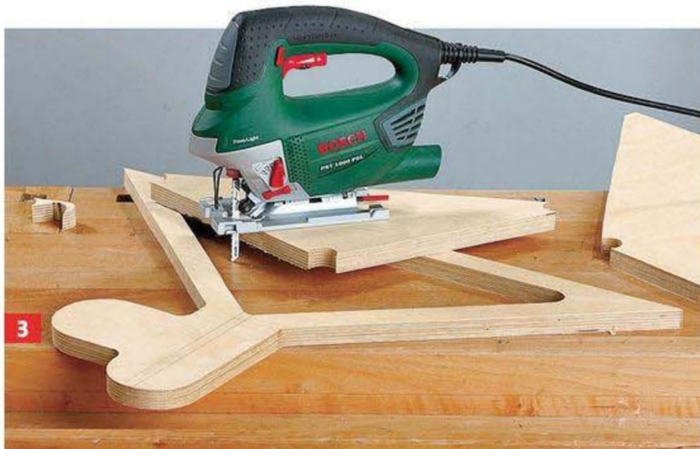
Mit der Stichsäge zuschneiden. Das Sägeblatt sollte immer außerhalb des Anrisses geführt werden, damit das Holz nicht ausreißt.
