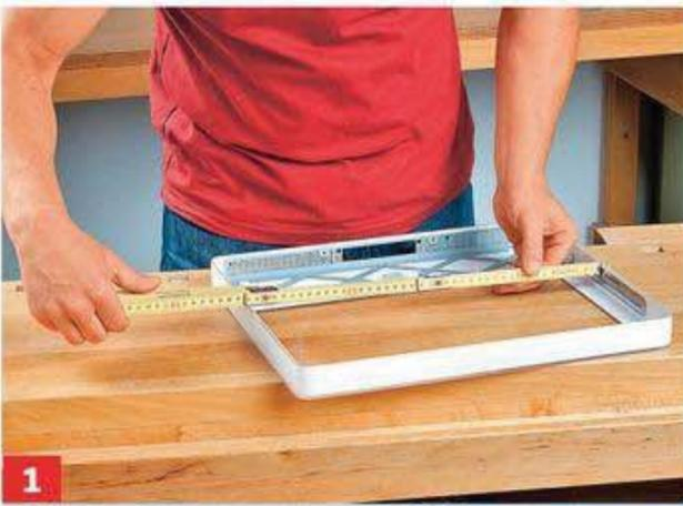
**1** Messen Sie das lichte Maß (Höhe und Breite) der Rückwand exakt anhand der Rahmenverkleidung aus.
