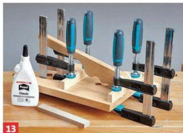
**13** ... die Nüsse Halt finden. Dann wird der äußere Rahmen aus 25 mm hohen Multiplexstreifen mit der Grundplatte verleimt.
