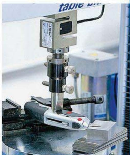
**Belastungstest:** Alle Messer wurden nach Norm getestet – hier bei der Prüfung quer zum Messerquerschnitt.
