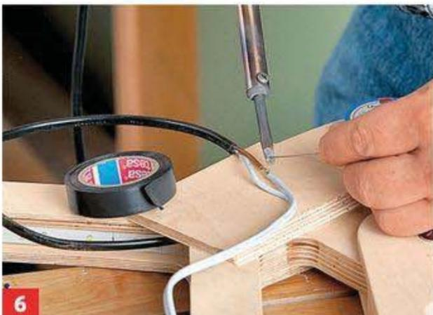
**6** Dabei die Litzen leicht versetzt einzeln durchtrennen, mit der Schlauchleitung verlöten und einzeln isolieren.
