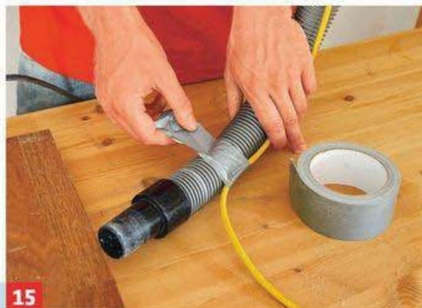
**15** Der (verlängerte) Saugschlauch lässt sich auch mit einem Verlängerungskabel zum Anschluss des Werkzeugs versehen.
