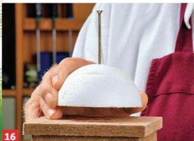
Eine Styropor-Halbkugelschale (ggf. plan abschneiden) mit Holzleim aufkleben und mit einer langen Schraube fixieren.
