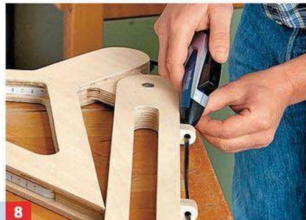
**8** ... zum LED-Streifen mit Heißkleber fixiert. Auch die Schlauchleitung – mit Spielraum an den Gelenken – so fixieren.
