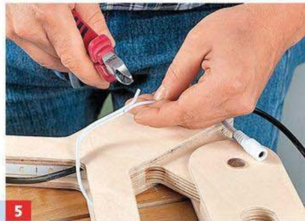
**5** Das LED-Kabel in einer scharfen Schlaufe zurück zur Schirmspitze führen und etwa mittig des Schirmkopfs durchschneiden.
