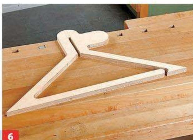
So sieht die Mittellage des Schirms nun aus. Der LED-Streifen wird später durch den Schlitz unten rechts herausgeführt.
