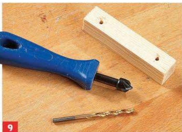
**9** Zwei durchbohrte und gesenkte Quadratleisten stellen später den Anschluss an die Wand sicher.
