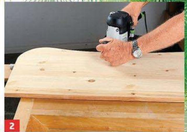
**2** Den Sägeschnitt mit Schleifpapier glätten, dann mit der Oberfräse und dem Konturfräser die Seiten und die Front verzieren.
