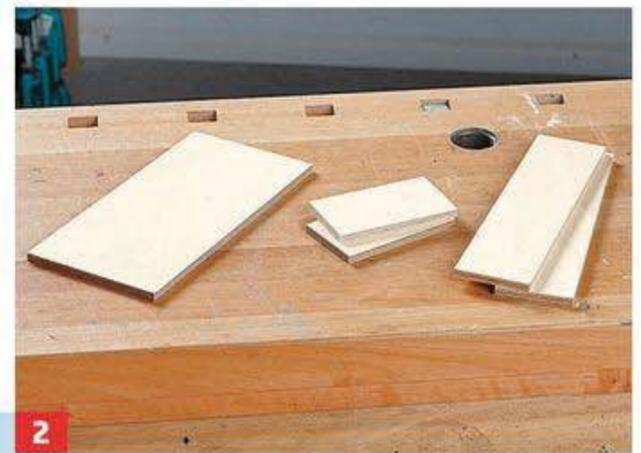
**2** Mehr braucht es für das Docking-Gehäuse nicht: eine Front, Deckel/Boden und zwei Seitenteile.
