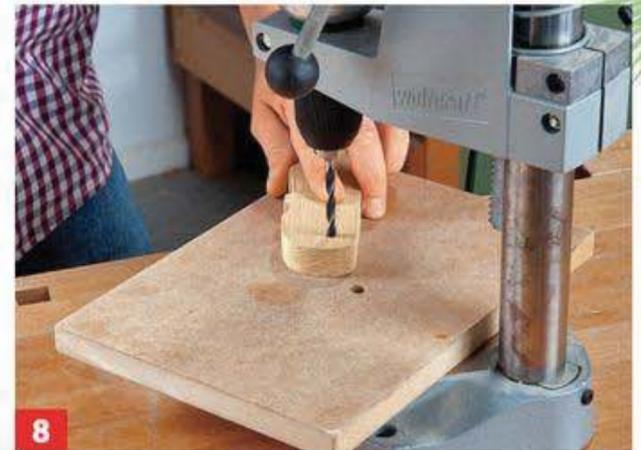
**8** ... mit der Bohrspitze. Anschließend an dieser Stelle das Loch bohren.
