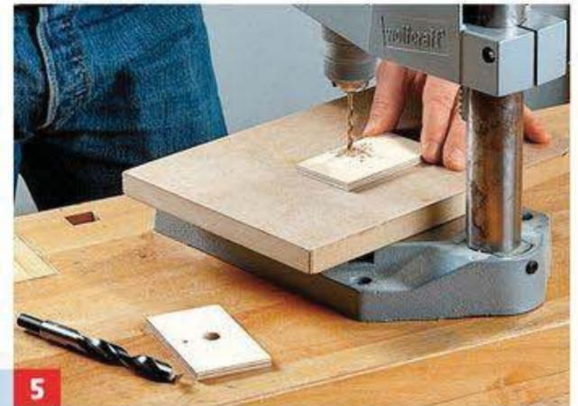
**5** Jetzt die Montagelöcher (etwa 3 mm) und das Sensorloch (13 mm) bohren.
