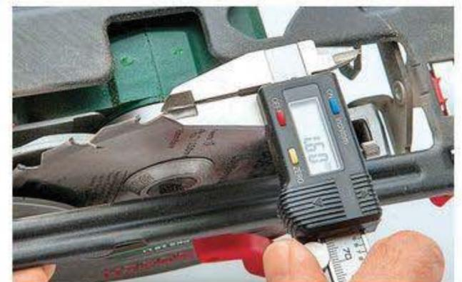
**HAUCHDÜNN:** Mit nur knapp 1,6 mm Stärke ist das Sägeblatt ausgesprochen schlank.
