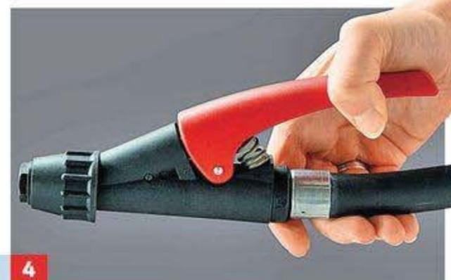
4 ... einsatzbereit. Bei Betätigen der Pistolenarmatur tritt nun das Löschmittel aus der Düse aus.
