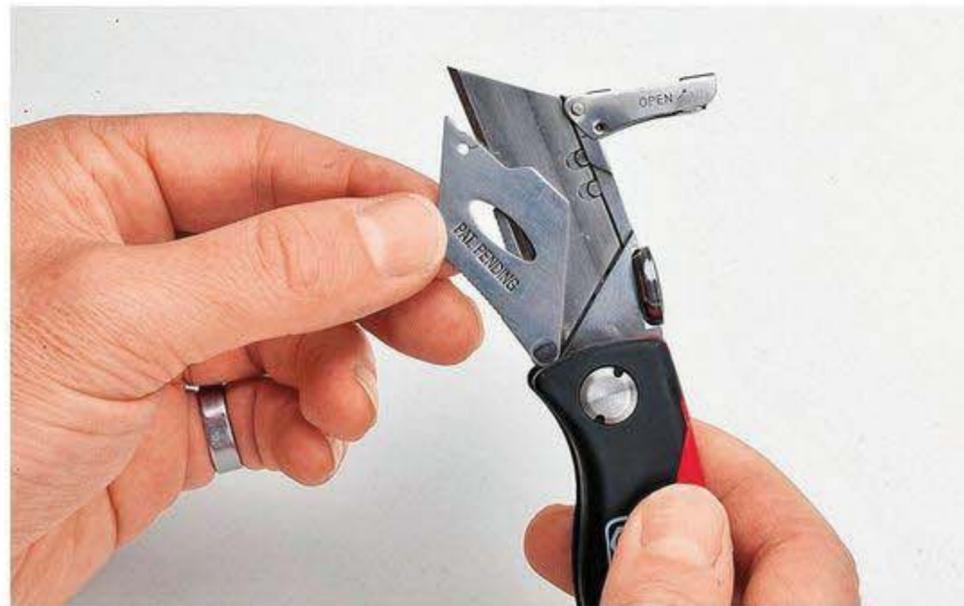
**SCHNEID-GEFAHR:** Bei *Bessey* und *Conmetall* ist der Klingentausch recht knifflig.
