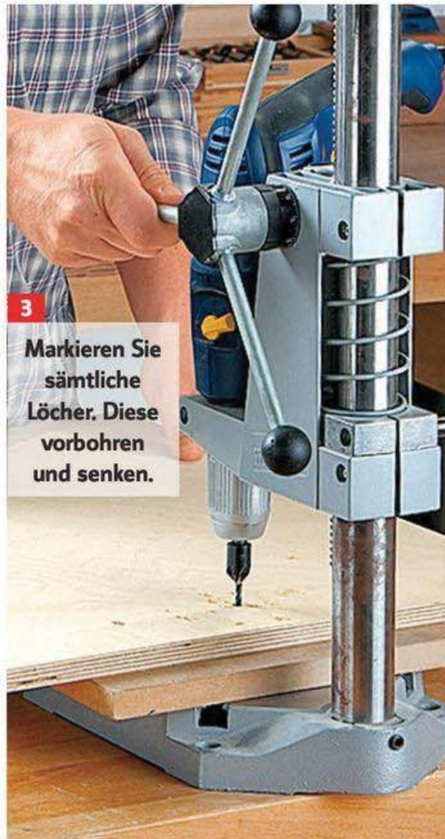
**3** Markieren Sie sämtliche Löcher. Diese vorbohren und senken.
