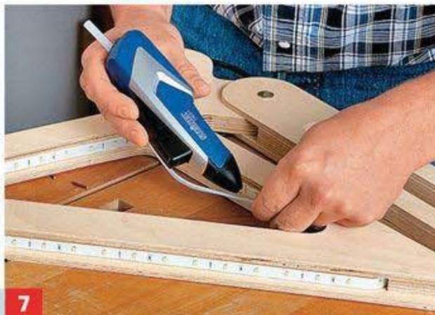
**7** Die schwarze Leitung stramm ziehen; die Isolier-Stelle liegt nun verdeckt im Holz. Das weiße Anschlusskabel wird parallel ...
