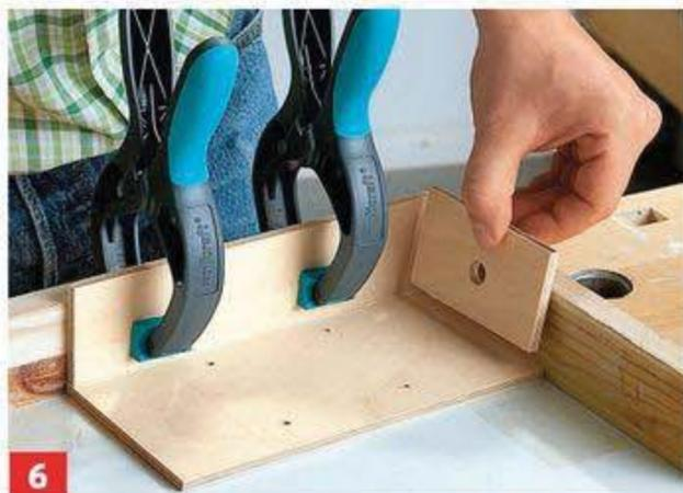
**6** Verleimen Sie die Anschluss-Box in einer Gehrungslade und fixieren daran die Bauteile mit Leimklammern.
