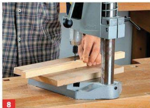
**8** ... zuschneiden. Löcher auf den Leisten anzeichnen und vorbohren. Dann werden die Leisten an den Seitenwänden und ...
