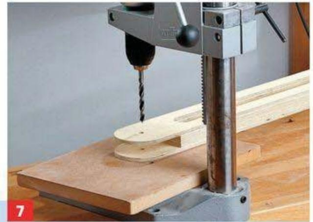
**7** Die Laschen im Mittelpunkt des Gelenk-„Kreises“ im Durchmesser der Mutternhülse (12 bzw. 14 mm) durchbohren.
