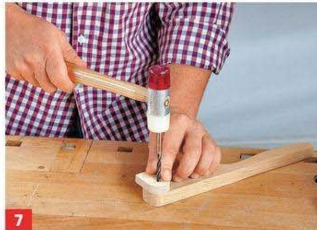
**7** Um die Bohrung vom Lagerbock auf den Hebel zu übertragen, legen Sie die Teile aufeinander und markieren das Loch ...
