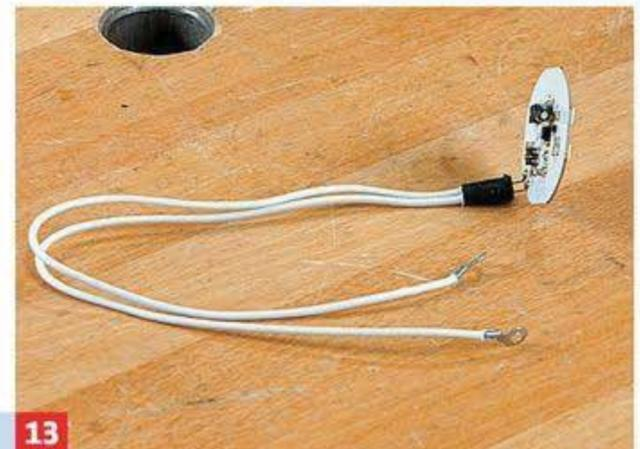
**13** Die Anschlusskabel der G4-Fassung mit Ringschuhen versehen, das Leuchtmittel einstecken und behutsam umbiegen.
