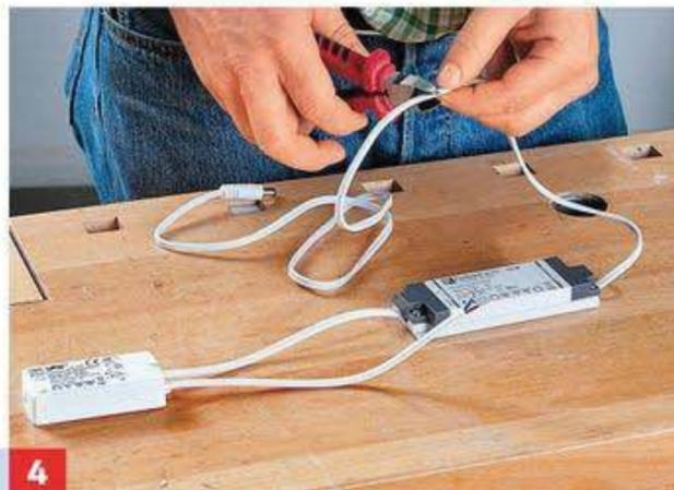
**4** ... Reststück der Zuleitung an beiden Enden mit Aderendhülsen ausstatten und am Eingang des Schalters anklebmen.
