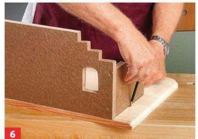
**6** Richten Sie diesen Wand-Winkel an der hinteren Kante auf der Grundplatte aus und markieren darauf die Umrisse.
