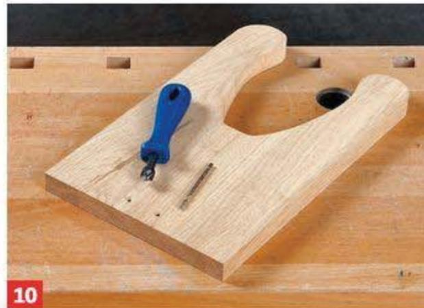
**10** Bohren und senken Sie die Löcher zur Befestigung der beiden Achslager von der Rückseite auf der Grundplatte.
