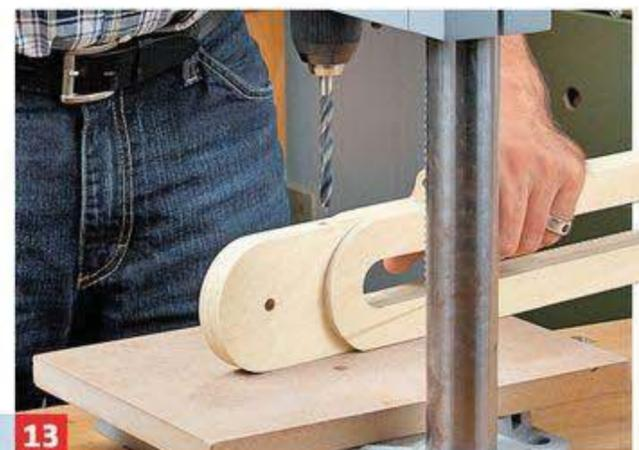
**13** Damit die Leitung von innen nach außen geführt werden kann, wird die Gelenkzunge des unteren Arms durchbohrt.
