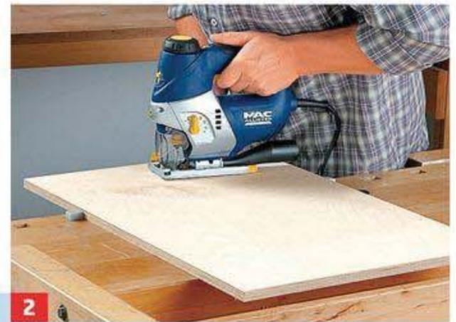
**2** ... um 7 cm ab. Schneiden Sie anschließend alle Teile mit der Stichsäge zu.
