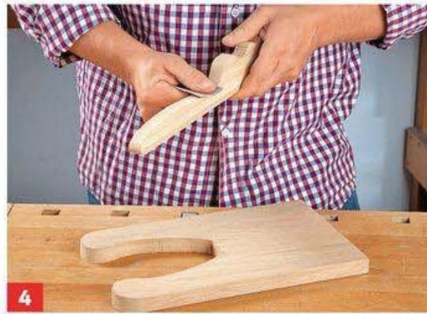
**4** Anschließend beide Teile mit Schleifpapier glätten und die Kanten brechen.
