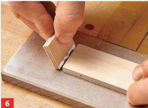
**6** Den schmalen Deckelkasten mit Hilfe des Nageltricks (abgekniffene Drahtstifte) und Leim zusammenfügen und mit großen ...
