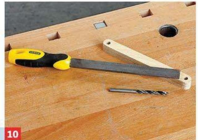
**10** Für eine saubere Leitungsführung werden je Arm drei Multiplex-Hölzer mit dem 8er Bohrer durchbohrt und abgerundet.
