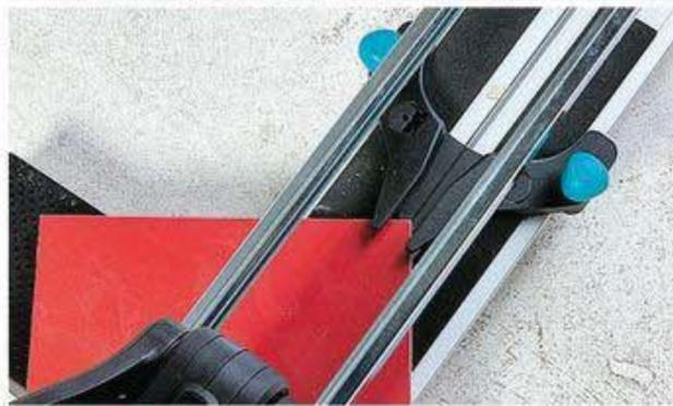
**DIAGONALE:** Ein spezieller Schieber fixiert die Fliese genau an der Ecke.
