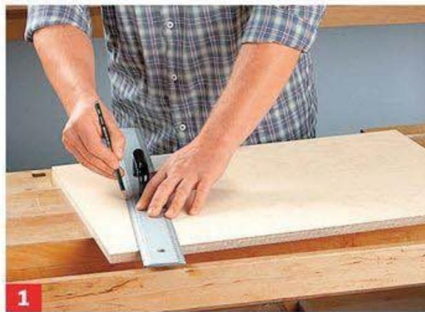
**1** Zeichnen Sie die Bauteile an. Markieren Sie die Schräge der Seitenteile und der Trennwand. Das Dach fällt nach hinten ...
