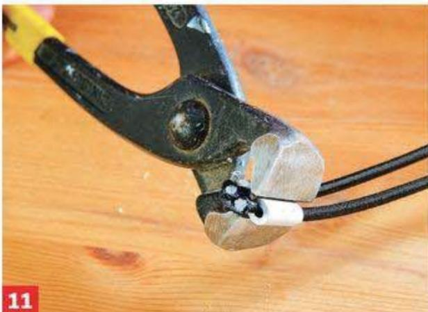
**11** Ein dünnes Expanderseil verpressen Sie mit einer Alu-Presshülse zu einer Schlaufe – oder Sie verknoten einfach die Enden.
