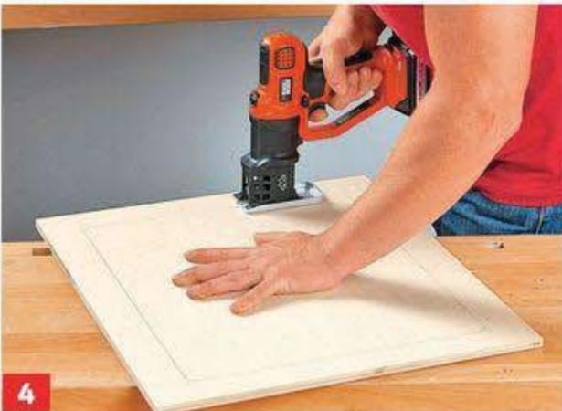
**4** Anschließend schneiden Sie die Platte genau mit der Stichsäge aus.
