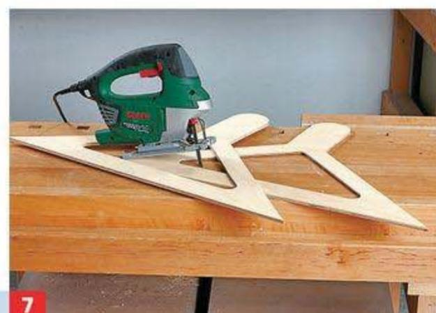
Nun werden die Blenden des Lampenschirms auf 6,5-mm-Multiplex gezeichnet, vorgeritzt und zugeschnitten.
