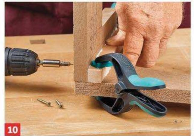
Hinter die Stallfront leimen und schrauben Sie an beiden Seiten Kiefernleisten. Hier wird die Front mit der linken ...
