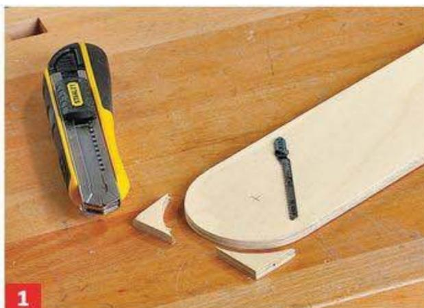
Die Außenlagen der Gelenkarme schneiden Sie aus 6,5-mm-Multiplex mit der Stichsäge und dem Kurvensägeblatt zu.
