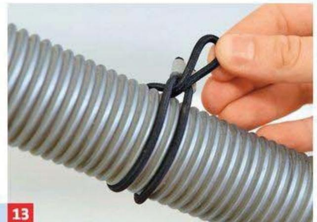
**13** Die Schlaufe sollte so lang sein, dass sie sich gut um den Saugschlauch führen lässt und noch ausreichend Länge ...
