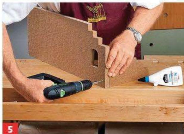
**5** Verleimt wird zunächst die Rückwand mit der treppenförmigen linken Seite. Die Wände mit Schrauben fixieren.
