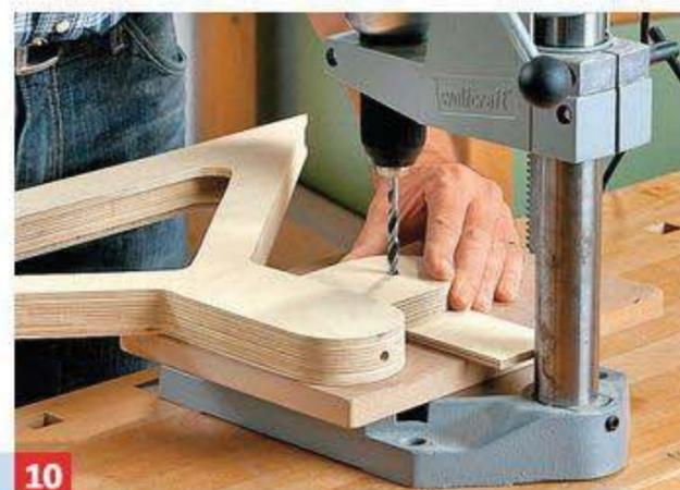
Zum Schluss bohren Sie mittig in die Gelenkaufnahme ein Loch für die Flachkopf-Hülsenmutter (M8 oder M10).
