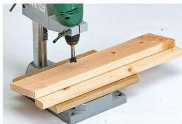
Beim Bohren eine Hilfsleiste unterlegen, damit die Löcher schräg angesetzt werden.
