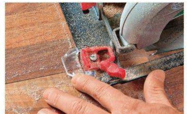
... Sägeschnitt-Fenster das genaue Eintauchen des Blatts z. B. bei Spülenausschnitten.
