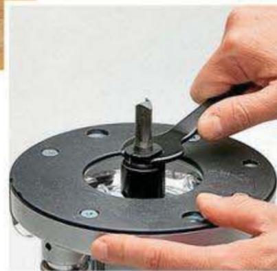
**ZUGÄNLICH:** Die Antriebswelle wird in der Wechsellage automatisch fixiert.
