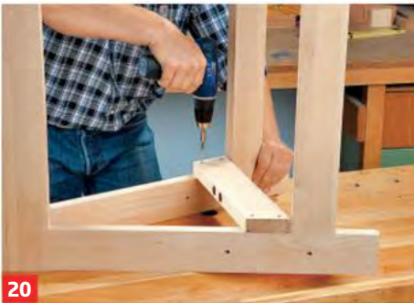
17 Querriegel, die den Bock stabilisieren, innen auf die Zwischenholme legen und die Schrägen der Fußriegel aufzeichnen.
