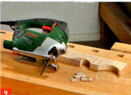
**9** Der Zuschnitt gelingt materialschonender, wenn Sie die Segmente erst lamellenförmig einschneiden und dann entlang ...
