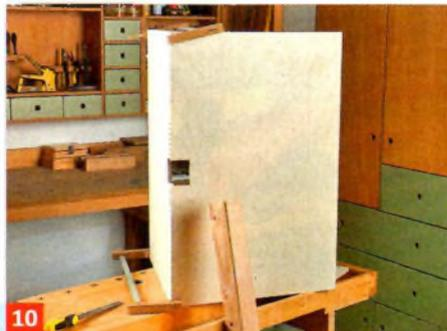
... wenn für die Wassermühle kein Aufsatz geplant ist! Die beiden Dachhälften werden nun gegeneinander gespannt.
