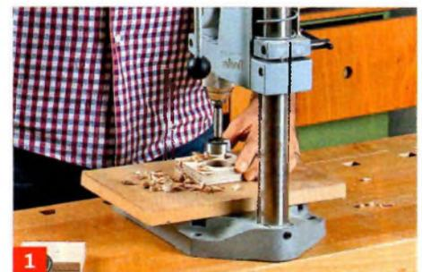
Der Lagerbock für zwei Rillenkugellager besteht ebenfalls aus Multiplex. Durchbohren Sie die beiden Lagerschalen ...
