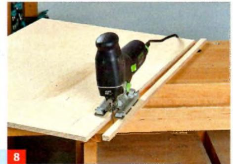
Die beiden Dachhälften überlappen sich. Die Giebel-Schnittkanten werden mit der schräggestellten Stichsäge geschnitten.
