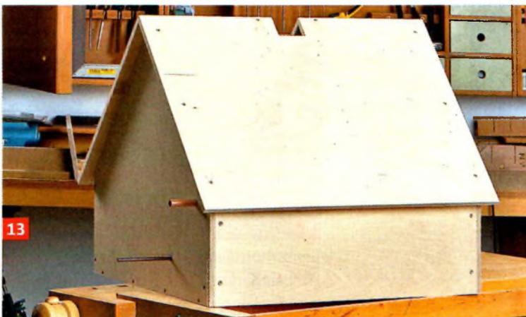
**13** Ist dies erledigt, montieren Sie die zweite Dachhälfte. Klebstoff am Giebel nicht vergessen!
