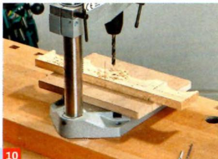
**10** ... der Kontur sägen. Auch die Blende erhält die oben beschriebenen Zapfensenkungen für die folgende Verschraubung.
