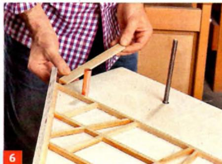
**6** ... die die Ecken verblenden, werden zunächst winklig verklebt und nach dem Trocknen aufgeklebt. Beachten Sie, dass ...
