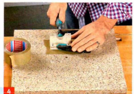
Die beiden unteren Hälften der Lagerschalen kleben Sie zwischen zwei gebohrte und gesenkte Montagehölzer.
