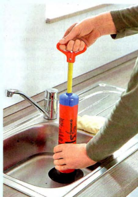
**ZUG UM ZUG:** Saugglocke auf den Abfluss setzen, Wasser ins Becken lassen, Überlauf abdichten – pumpen!
