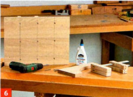
**6** ... 8-mm-Bohrer gebohrt, das Holz dann mit dem 4er Bohrer durchbohrt. Nach dem Vorbohren der Zwischenwände im ...
