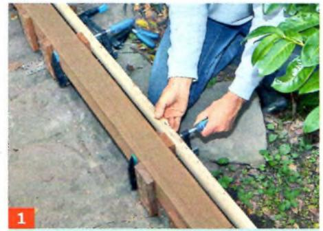
Als Anschlag dient ein Hilfsbrett, das an das hintere Ende des Rahmens angezwängt wird.
