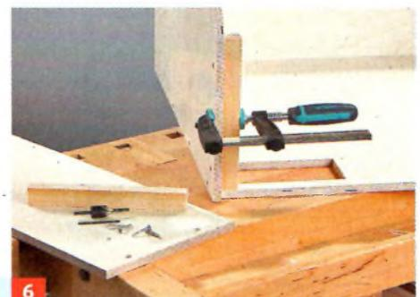
6 ... Platte einkleben und -schrauben. Für die zweite Traufwand zwei Anschlaghölzer aufkleben und verschrauben.
