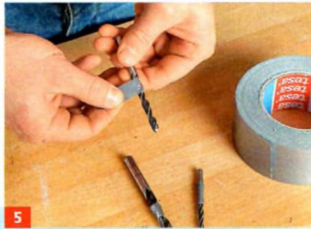
**5** Damit Sie nicht aus Versehen durchbohren, kleben Sie mit Gewebeband einen Tiefenstopp um den Bohrer.
