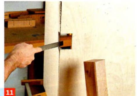
Mit einer Raspel/Feile arbeiten Sie dann die waagerechten Schnitte der Ausklinkung für den Windmühl-Balken nach.
