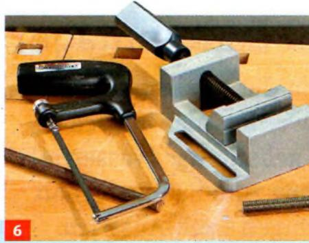
**6** Nun mit der Eisensäge eine M10-Gewindestange (idealerweise rostfrei A2 oder A4) ablängen.
