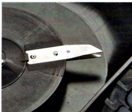
**SCHNEIDEN:** Der Al-Ko-Roboter schneidet mit zwei rotierenden Doppelklingen.
