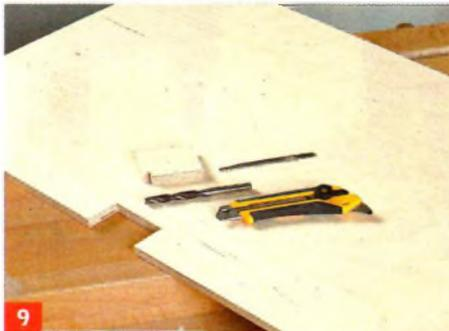
Für die Aufnahme der optionalen Windmühle werden die Dachplatten mittig ausgeklinkt. Dies ist nicht erforderlich, ...
