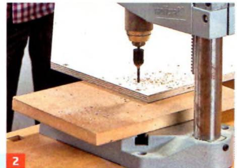
2 Der Boden sowie eine Traufseite werden fest mit den Giebeln verklebt und verschraubt. Die Giebel bohren und senken!
