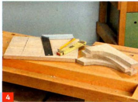
**4** Jetzt markieren Sie die Lage der drei Zwischenwände mit dem Schreinerwinkel auf dem Zwischenboden. Position der ...
