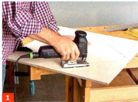
1 Schneiden Sie die Giebel- und die Traufwände mit der Stichsäge zu. Um Aussris zu vermeiden, mit dem Cutter vorritzen!
