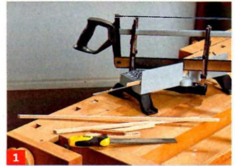
**1** Das Giebeldreieck wird als Fachwerk gestaltet. Die Leisten schneiden Sie am besten mit der Gehrungssäge zu.
