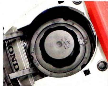
Fast alle Mäher bieten eine zentrale Schnitthöhenverstellung (hier bei *Honda*).
