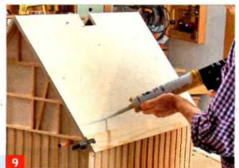
**9** Breite Holzleisten werden für die Dacheindeckung von der Traufe bis hoch zum Giebel quer aufgeklebt.
