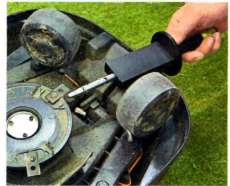
**GEFAHR:** Bei einigen Mähern ist das drehende Messer erreichbar. \*
