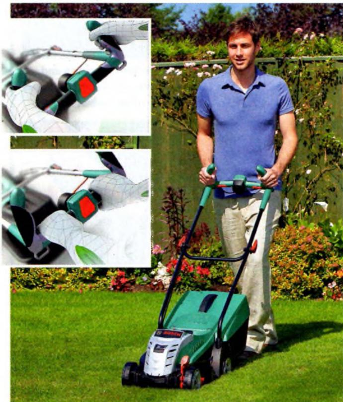
**DER RICHTIGE GRIFF:** Stundenlanges Mähen ermüdet die Hände. Die Rotak-Rasenmäher von Bosch haben ergonomische Griffe, die verschiedene Greifpositionen (kl. Bilder) ermöglichen und damit den Händen mehr Flexibilität beim Führen des Mähers geben.
