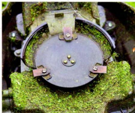
**ZUGESETZT:** Bei Feuchtigkeit verschmutzt das Gardena-Mähwerk.
