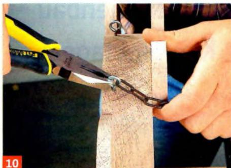
**10** Positionen für die Ringschrauben vorbohren und eindrehen. Daran wird je ein Ende der Gliederkette befestigt.
