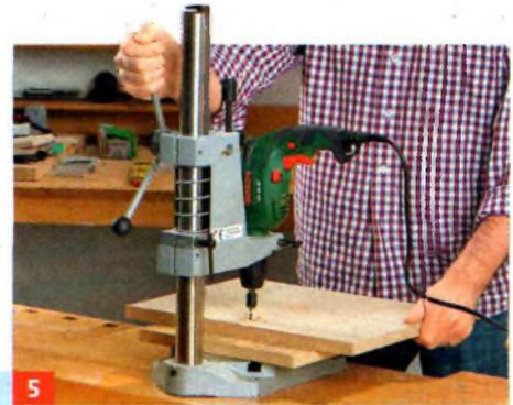
**5** ... Schraubenlöcher festlegen. Sie werden als Zapfensenkung ausgeführt, d. h. bis zur halben Materialstärke wird mit dem ...
