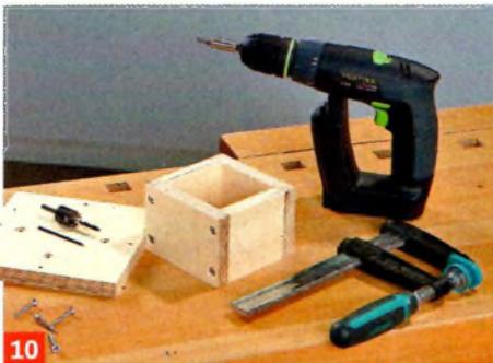
**10** Den Balkenschuh – bestehend aus vier Seiten und einer Grundplatte – verschrauben. Stellen Sie den Schuh, der ...
