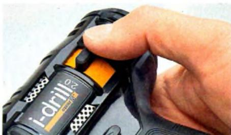
Der Einhand-Getriebebeschalter ist für Rechtshänder bequem erreichbar, muss aber bis zum Anschlag geführt werden!
