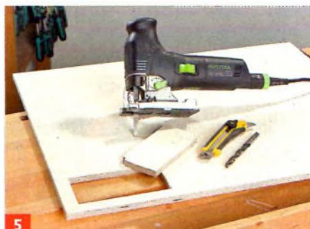
5 Nun die Bodenplatte zuschneiden und das Loch für die Pumpe bzw. den Pumpenanschluss einbringen. Dann die ...
