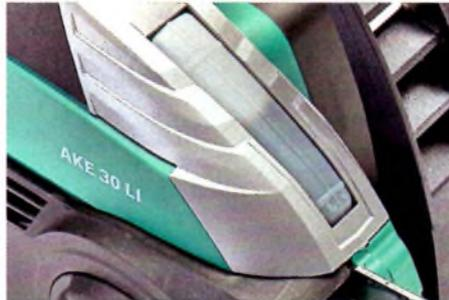
**KETTENÖL:** Per Schauglas lässt sich der Füllstand des Sägekettenöls ohne Öffnen des Tanks kontrollieren.
