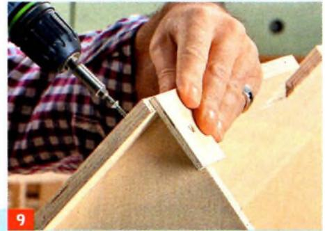
**9** Kleben und schrauben Sie nun die erste Dachfläche auf. Ein Anschlagholz hilft beim Finden der Position. Vorbohren!
