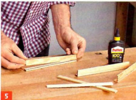
**5** Der untere Teil der Giebelwand und die Traufwände werden optisch als Boden-Deckel-Schalung gestaltet. Die Leisten, ...
