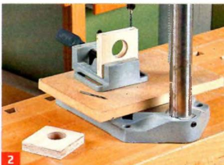
... erst mit dem 35er-Forstnerbohrer, dann werden beide Seiten der oberen Schnittkante gebohrt und gesenkt.
