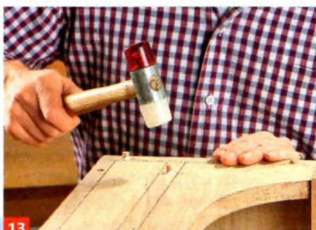
**13** In sämtliche Zapfensenkungen leimen Sie anschließend Holzdübelabschnitte, die die Schraubenköpfe abdecken.
