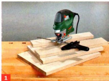
**1** Zunächst erfolgt der Zuschnitt der Bauteile (hier aus 19-mm-Eiche-Leimholz) z. B. mit der Stichsäge.
