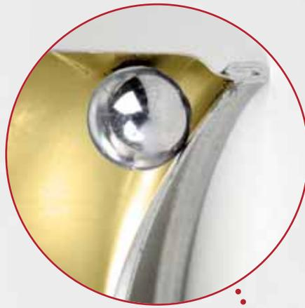
**DIE MISCHKUGEL LIEGT AM BODEN** der Dose und ist für das typische „Klackern“ beim Schütteln einer Lackdose verantwortlich. Sie sorgt dafür, dass sich kein Bodensatz in (Farb-)Sprühdosen sammelt, der Inhalt vor dem Einsatz durchmischt wird. Der Boden ist immer nach oben gewölbt, dient als Not-Ausgleich, wenn die Dose einmal unkontrolliert erhitzt wird.
