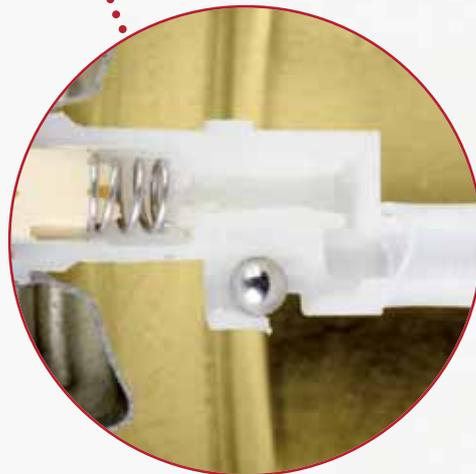
**DIE KLEINE KUGEL** unterhalb des Sprühkopfs verhindert, dass Farbe in den Kopf gelangt, wenn man die Dose um 180 Grad dreht. Dann strömt nur Gas aus und „spült“ den Sprühkopf frei. Wenn Sie Ihre Sprühdose also mehrmals einsetzen wollen - Kopf spülen vor dem Wegstellen nicht vergessen!
