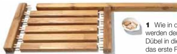
**1** Wie in den Fotos oben rechts gezeigt, werden der PUR-Klebstoff und die befeuchteten Dübel in die aufrechten Holme eingesetzt und das erste Rückenlehnenfeld verklebt.
