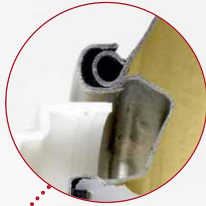
**VENTIL UND TELLER** werden auf die Dose „geclincht“ (aufgestempelt); unter dem Teller befindet sich oft noch eine spezielle Kunststoffdichtung. Zuvor ist das Produkt (Öl, Lack, Reiniger) in die offene Dose gefüllt worden. Das Gas kommt anschließend auf dem gleichen Weg in die Dose, auf dem es sie auch wieder verlässt - über das Ventil.
