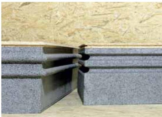
Basis der neuen Dachbodendämmung „Uni-Loft 032“ ist der graue EPS-Dämmstoff, der auch den zukünftigen Anforderungen der Energieeinsparverordnung entspricht. Sie ist mit einem dreifachen Nut-Feder-System ausgerüstet und mit Oberflächen wie OSB, Spanplatte oder einem wischfesten Melaminharz beschichtet. Die nochmals mit Nut und Feder versehene Plattenbeschichtung der Elemente sichert eine hohe Luftdichtigkeit sowie wirkungsvollen Wärmeschutz. Erhältlich in zwei unterschiedlichen Größen und Dicken.
