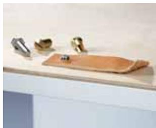
**Ein einfaches Stück Leder** wird hier zum individuellen Griff. Schneiden Sie das Leder am besten mit einem Rollcutter (drehende Messerklinge) zu, und führen Sie im oberen Bereich für die Schraube einen Kreuzschnitt aus. Das Schraubenloch in der (Ikea-)Tür wird entsprechend der Messingschraubhülse aufgebohrt und der Ledergriff montiert.
