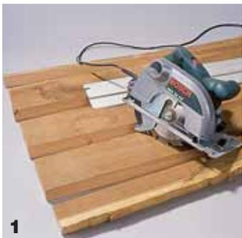
**1** Die Holzbohle mit einer Handkreissäge parallel auftrennen und die Schnittkanten vom Tischler abrichten lassen.
