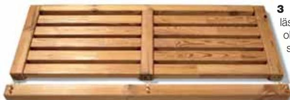
**3** Wird der untere Holm eingeklebt, so lässt sich aufgrund des abgerundeten oberen Querholms eine Zwinge nur schlecht ansetzen. Benutzen Sie daher Zulagen aus Holz, die ein Abrutschen der Zwingen verhindern.
