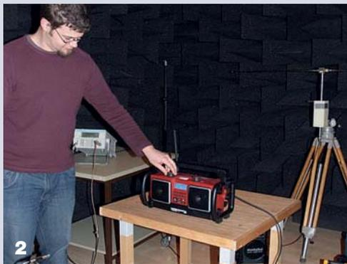
**Gemessen wurde im Spezialraum** Sendesignalgeschützt und mit speziellem schallschluckendem Schaumstoff ausgestattet ist die schwarze Kulisse der Akustikmesshalle des SELBERMACHEN-Testlabors PZT.
