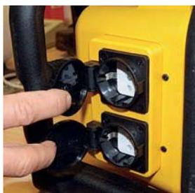
**Steckdose** Externe Netzstecker am Radio ermöglichen das Anschließen elektrischer Werkzeuge direkt ans Radio. Wichtig: Dabei ist die maximale Belastung des Anschlusses zu beachten.
