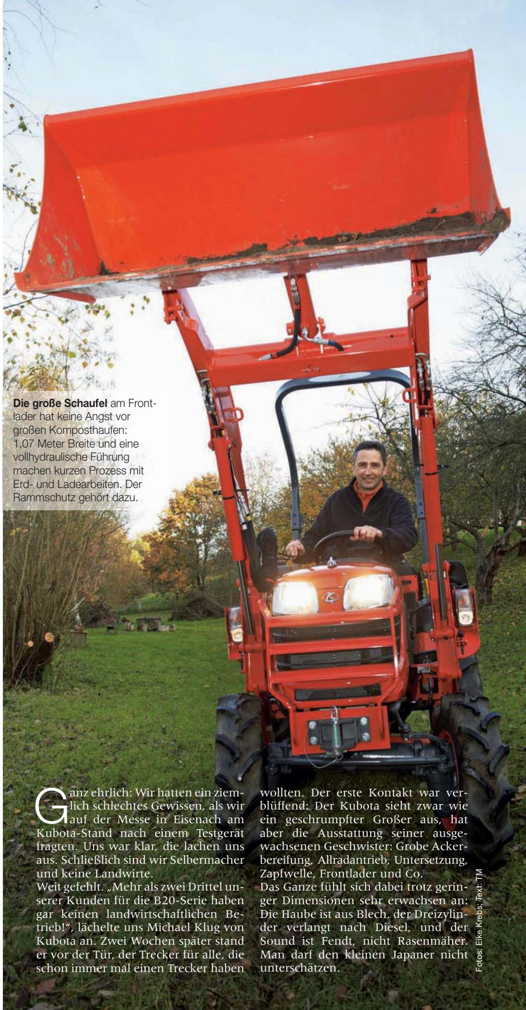
**Die große Schaufel** am Frontlader hat keine Angst vor großen Komposthaufen: 1,07 Meter Breite und eine vollhydraulische Führung machen kurzen Prozess mit Erd- und Ladearbeiten. Der Rammschutz gehört dazu.
