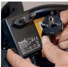
**Versorgung** Der Betrieb erfolgt direkt oder über ein externes Steckernetzteil. Beim Makita müssen Akkus über ein externes Ladegerät aufgeladen werden.
