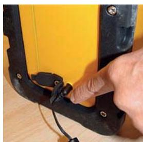
**Sicherheit** Bei Clatronic und Reflexion ist der seitliche Steckerplatz der Stromversorgung nicht ausreichend geschützt. Beim Reflexion ist er beim seitlichen Aufprall in das Gehäuse eingedrückt.
