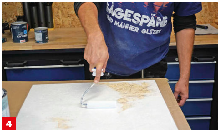
4 Mit der Lackwalze tragen wir die erste Schicht der Grundierung gleichmäßig, aber nicht zu dick auf.
