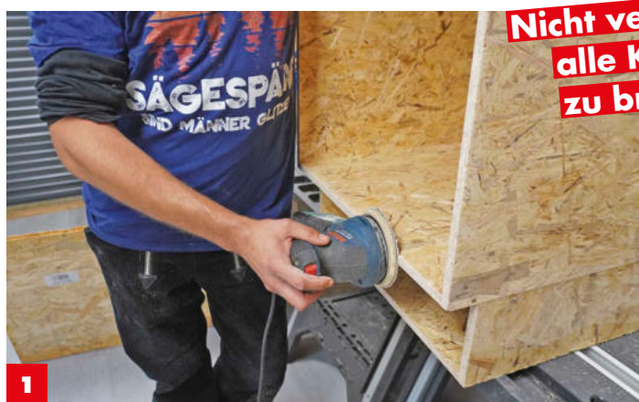
1 Die Kanten und die Flächen von Blenden, Deckel und Seitenwänden schleifen wir mit dem Exzentschleifer .
