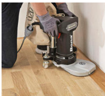
Rändern können Sie mit der Randschleifmaschine ...
