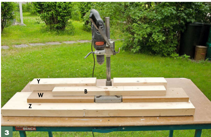
3 Die Bohrlehre aus Grundplatte (Z), Platte (W) und Anschlag (Y) zusammenbauen . Die Bohrmaschine wird vom Bohrständler exakt senkrecht geführt, der Anschlag hält den Abstand zur Kante.
