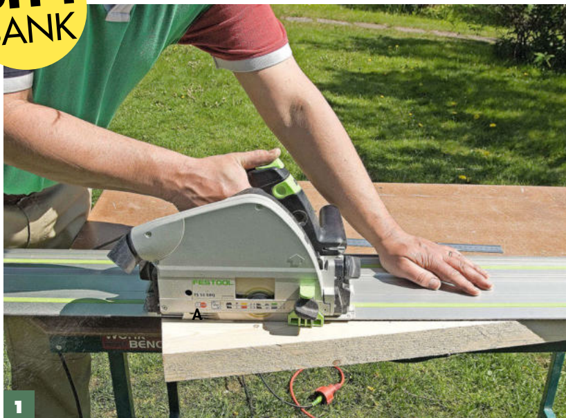
1 Das Hinterbein (A) mit der Handkreissäge abschrägen, so entsteht die Neigung der Rückenlehne . Alternativ geht es mit der Fuchsschwanzsäge.
