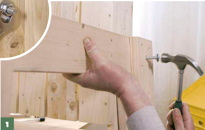
1 Die Fußteile ansetzen, Schlossschrauben vorsichtig per Hammer einschlagen (oben lange/unten kurze) und mit Muttern sichern.
