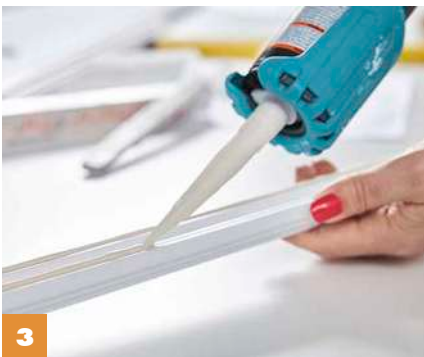
3 Montagekleber auftragen. Darauf achten, dass an den Rändern nicht zu viel Kleber überläuft .
