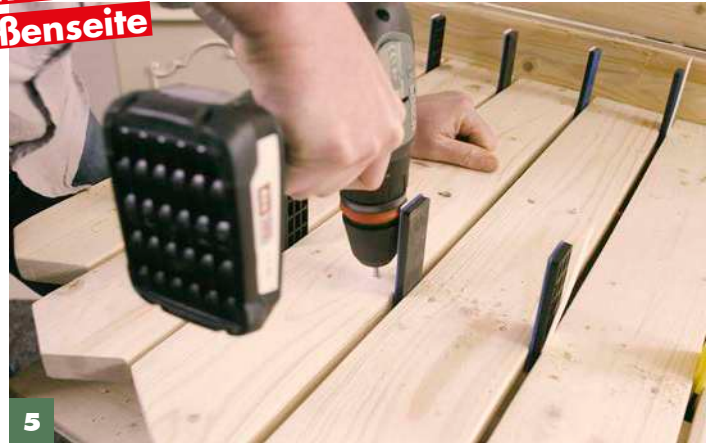
5 Setzen Sie auch hier Abstandshalter ein, bevor Sie die Rückenlehnenlatten vorbohren und fixieren.
