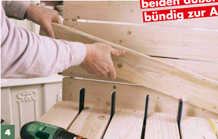
4 Legen Sie ein langes Brett als Orientierungshilfe zum Ausrichten der Unterkanten zwischen Sitzfläche und Rückenlehne.
