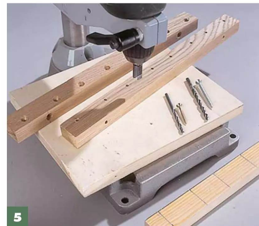
5 Verbindungsleisten unten und oben anschrägen. Danach die Verschraubungslöcher bohren und ansenken.
