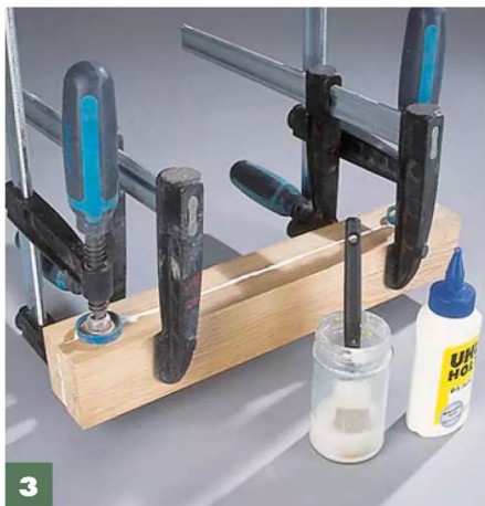
3 Die Pfosten aus zwei 40 cm langen Rechteckhölzern zusammenleimen. Danach auf 58 x 58 mm Querschnitt bescheiden.
