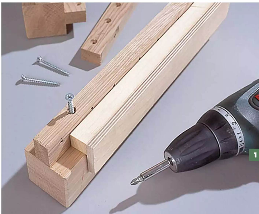
1 Verbindungsleisten an die Pfosten schrauben. Tipp: Mit Hilfsanschlagen werden die 2-cm-Abstände exakt.
