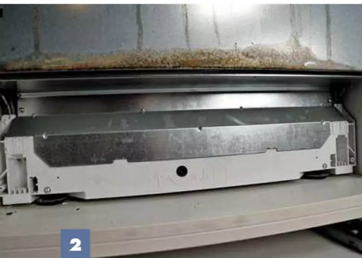
2 Die Blechabdeckung des Gerätebodens ist oben mit zwei Schrauben und unten mit zwei Haltenasen fixiert.
