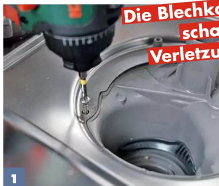
1 Um die Dichtung einzulegen, entfernen Sie die verbliebenen beiden Schrauben , die den Pumpentopf noch halten.
