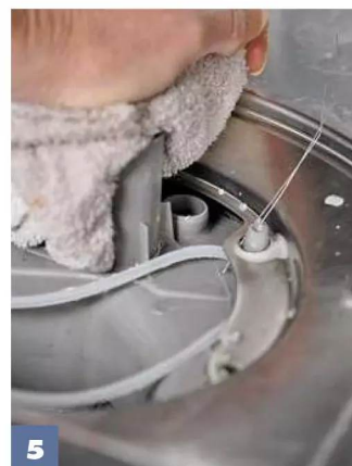
5 Drücken Sie dabei den Pumpentopf so weit nach unten , dass Sie genügend Platz für die Dichtung haben.
