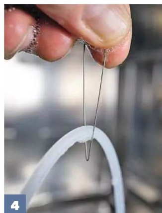
4 Legen Sie den mitgelieferten Drahtbügel um die Dichtung und fädeln ihn wie im nächsten Bild gezeigt von unten ein.
