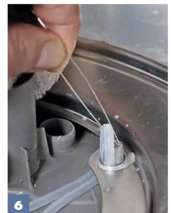
6 Ziehen Sie die Dichtung durch die Öffnung, um sie im nächsten Schritt um den Kunststoffsockel zu legen.
