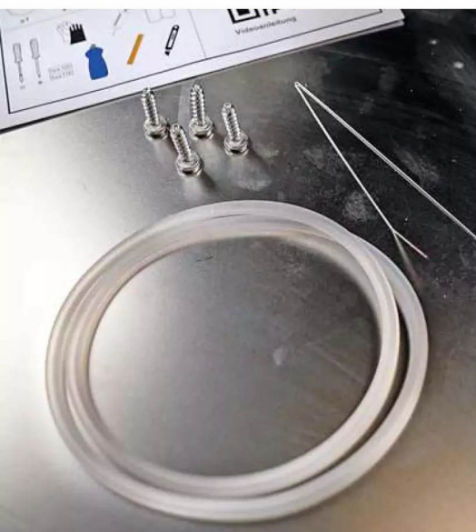
Packen Sie den Reparatursatz aus und legen ihn griffbereit zurecht. Der Drahtbügel dient als Einziehhilfe.
