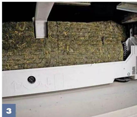
3 Hinter der Abdeckung kommt nun die Dämmmatte zum Vorschein , die nur eingesteckt ist und sich leicht entnehmen lässt.
