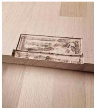
Die Scharniere sind bündig in die Tischplatte eingefräst, damit alles völlig eben ist
