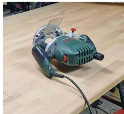
Die Kanten wurden mit der Fräse abgerundet; der letzte Feinschliff erfolgte mit 240er-Körnung
