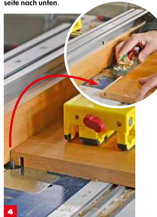
4 Nun verringern Sie die Frästiefe auf halbe Materialstärke und nehmen in mehreren Durchgängen den Überstand zur Brettkeite ab. Die Fräsung säubern.
