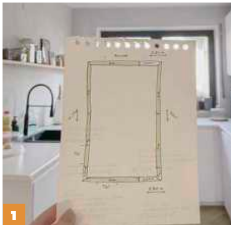
1 Für den Zuschnitt der Stuckleisten fertigten Sara und Tim zunächst eine grobe Skizze des Raumes an.
