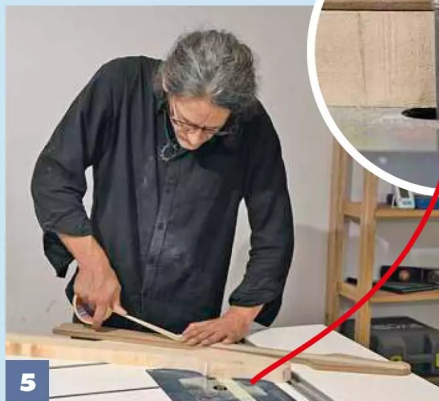
2 Der Umriss wird nun mit 1–2 mm Überstand grob aus dem Rohling gesägt.
