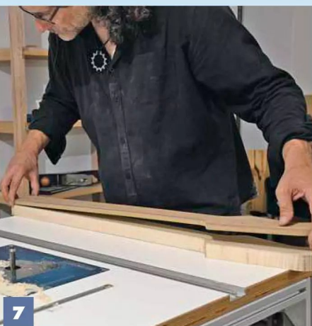
4 An den markierten Stellen arbeitet der Fräser quer zu Faser oder sogar entgegen. Hier besteht die größte Ausrissgefahr.
