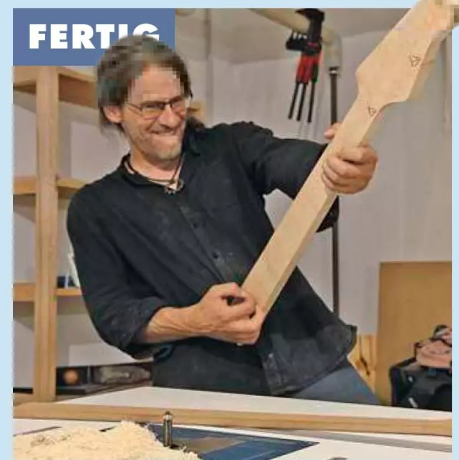
6 Fräsen Sie im ersten Durchgang nur die unkritischen Stellen und tragen Sie den Überstand in kleinen Portionen ab.
