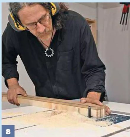
5 Die Schablone mit Sekundenkleber und Abdeckband auf dem Rohling fixieren. Den Fräser auf die Materialstärke setzen.
