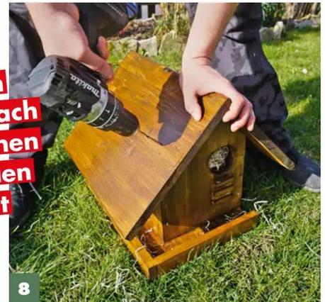
**8** Jetzt noch die **Dachbretter stumpf miteinander verbinden**. Fest aufgeschraubt wird das Dach erst direkt vor dem Aufhängen.
