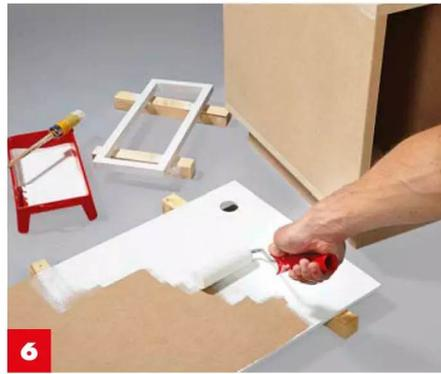
**6** Alle Flächen und Kanten nach Säubern der Oberflächen (leicht feucht abwischen) mit einer **Grundierung beschichten**.
