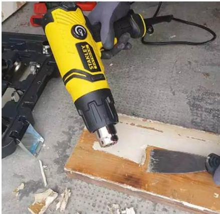
Beim **Lackenfernen** kommt man schnell voran; Pistole und Zubehör werden in einem stabilen Koffer (links) verstaut
