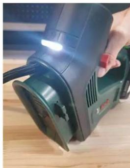
Die **LED-Beleuchtung** geht automatisch beim Starten der Pumpe mit an, leuchtet aber nur, solange gepumpt wird
