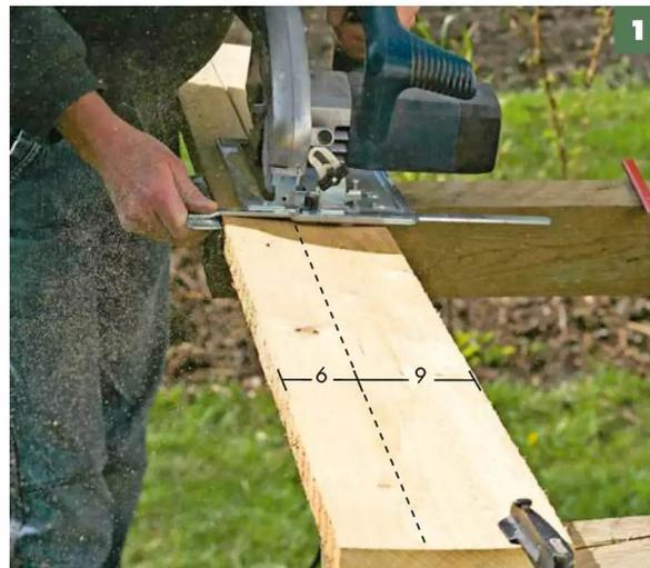
1 Für die Beine des Beets ein Brett der Länge nach zusägen. **Teilen Sie es so, dass Sie zwei Stücke von ca. 6 und 9 cm Breite erhalten.** Dann werden sie auf eine Länge von 70 cm für die hinteren bzw. 60 cm für die vorderen Beine zugesägt.
