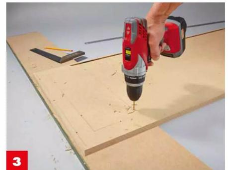
**3** Auf Boden- und Deckplatte **Positionen der angrenzenden Platten** und Punkte für die Schraubenlöcher anzeichnen und bohren.
