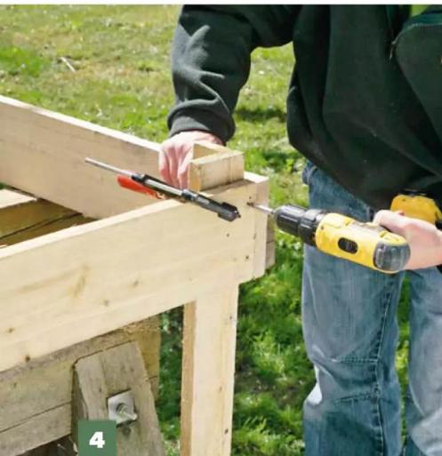
**4** Die unteren Bretter des Rahmens werden nun **vorübergehend mit Zwingen fixiert** und mit Schrauben in vorgebohrten Löchern an den Beinen befestigt.
