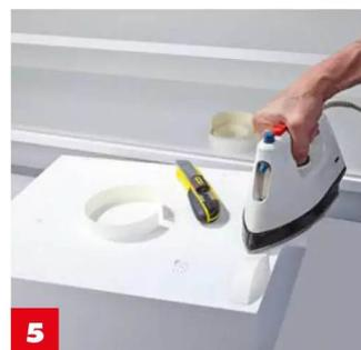
**5** Kantenumleimer auf die Unterseite der Box aufbügeln – als **materialschonende Gleiter**.
