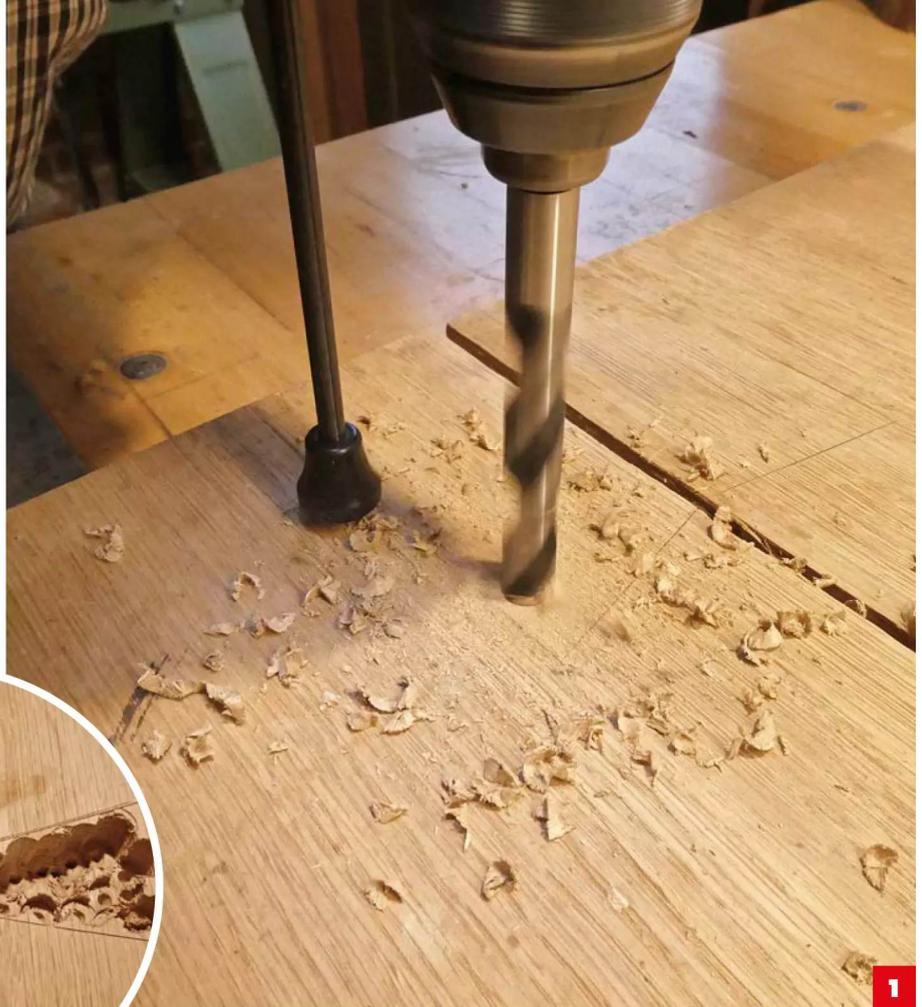
An der Bohrmaschine einen Bohrstopp anbringen oder Klebeband um den Bohrer wickeln, damit die **Löcher 2 mm weniger tief werden als der Block dick ist**. Die letzten 2 mm später mit dem Stemmeisen entfernen.
