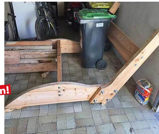
Nach dem Dübeln und Leimen der **Beinauflagen aus je zwei Teilen** folgte die Verschraubung – mit den Lehen und zwei stabilen Längsträgern
