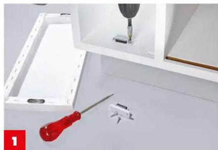
**1** Je zwei **Türmagnete halten die mit Stoff bezogenen Rahmen** in Position. Bohrlöcher in den Rahmen mit einer Ahle vorstechen.
