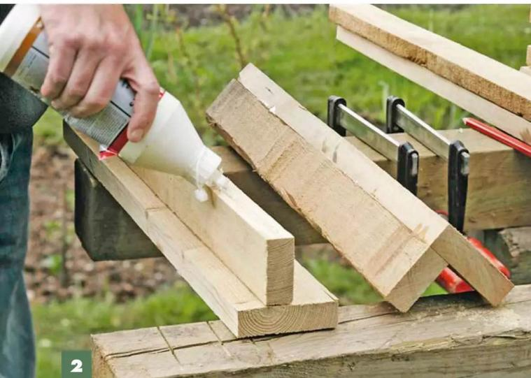
**2** Um die Beine des Frühbeets zu verbinden, erst die schmalen Stücke mit PU-Kleber mit den breiteren **verleimen und anschließend mit Schrauben fixieren**. Vorbohren nicht vergessen!
