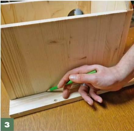
**3** Das Gerüst des Kobels auf die Bodenplatte setzen und **alle Kanten sorgfältig von außen anreißen**.
