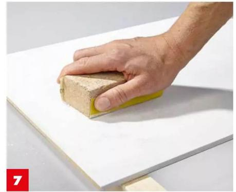
**7** Mit 320er-Korn die **Flächen und Kanten zwischenschleifen**. Schön gleichmäßig wird es mit einem Schleifklotz.
