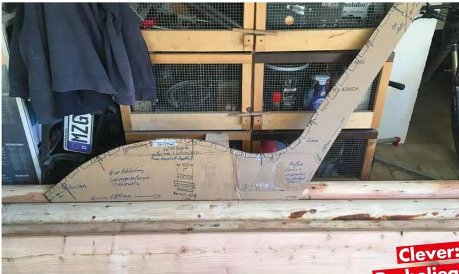
Das **Muster aus Karton** entstand durch vielfaches Probeliegen. Es wurde **auf die Holzbohlen** übertragen
