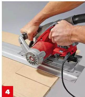
**4** Der Ausschnitt im Korpusdeckel geschieht im ersten Schritt mit der Handkreissäge. Parallel zur schmalen Brettkante ...
