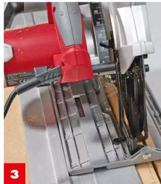
**3** Die Nut in der Bodenplatte 12 mm tief, im Korpusdeckel 15 mm tief sägen – damit sich die Schiebetür einhängen lässt.
