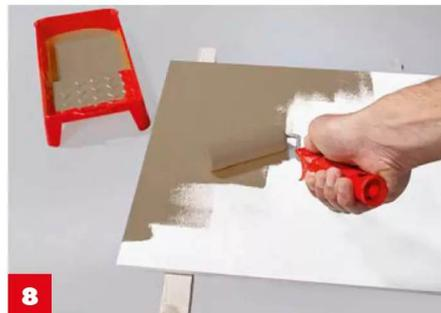
**8** Der Lackauftrag **gelingt mit der Schaumstoffrolle perfekt** (überkreuz verschliffen), Übergänge mit kleinem Pinsel bearbeiten.
