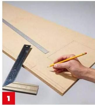
**1** Korpusdeckelplatte mit Klappfach-Ausschnitt und Nut für Schiebetür. Die Nut auch auf der Bodenplatte anzeichnen.
