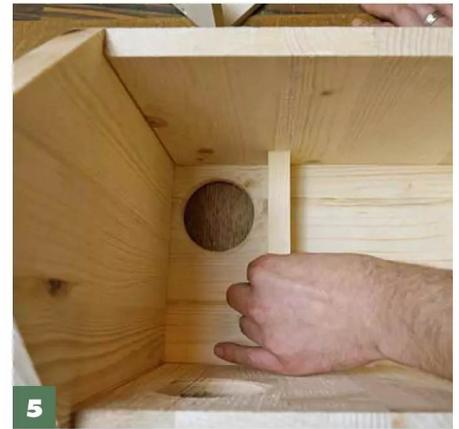
**5** Nach dem Anschrauben des Bodens von unten **wird die Absturzicherung** für Futter, Nistmaterial und Babys **innen angeleimt**.
