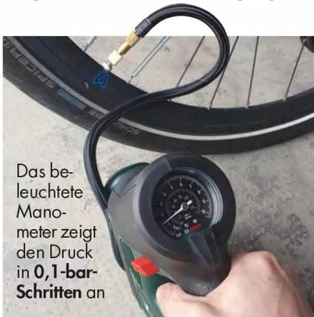
Das beleuchtete Manometer zeigt den Druck in **0,1-bar-Schritten** an
