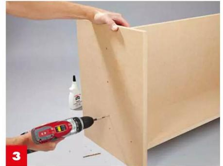
**3** Leimflächen an Regalboden, Rückwand und Seiten **aneinanderfügen, ausrichten** und durch die gebohrten Löcher fixieren.
