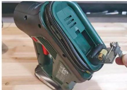
Die wichtigsten **Adapter für Fahrrad, Bälle und Luftmatratzen** sind hinter einer kleinen Klappe untergebracht
