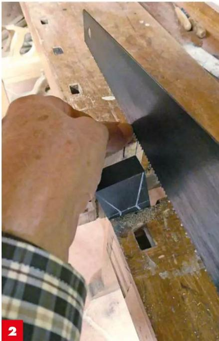
**2** Sägen Sie nun so durch den Stützklotz, dass das Sägeblatt **genau auf die Markierung auf dem Schmetterlingsblock** trifft.
