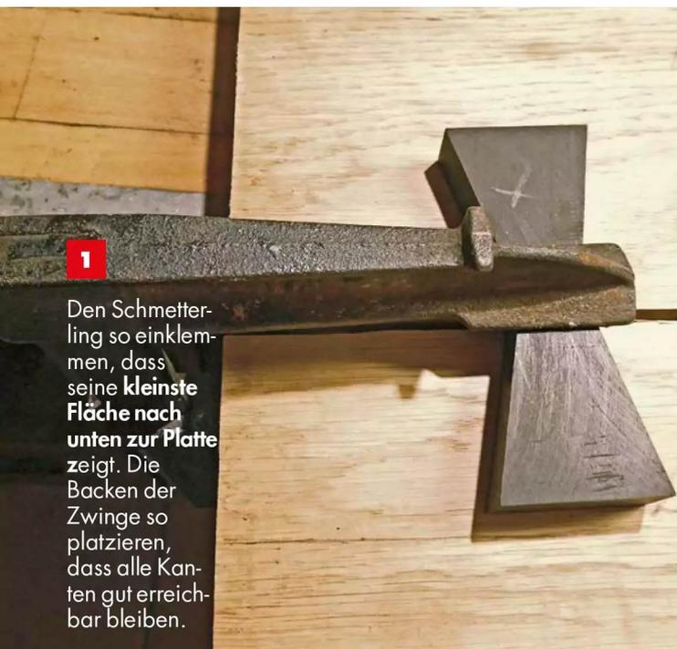
**1** Den Schmetterling so einklemmen, dass seine **kleinste Fläche nach unten zur Platte** zeigt. Die Backen der Zwinde so platzieren, dass alle Kanten gut erreichbar bleiben.
