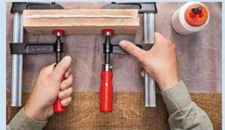
Ein **gleichmäßiger Anpressdruck** ist ausschlaggebend für die Verbindung
