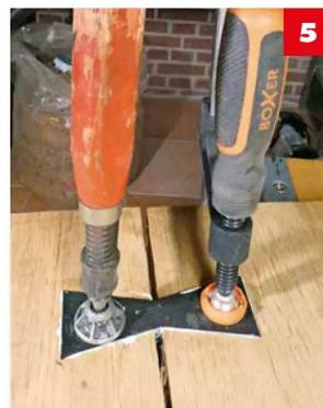
Als Nächstes wird waagrecht in Richtung der Ränder hin ausgestemmt. **Achten Sie darauf, nicht zu weit zu gehen**. Jetzt wechseln Sie zwischen vertikalem und horizontalem Arbeiten, bis das Loch perfekt ist.
