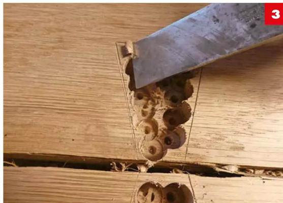
Mit einem breiten Stemmeisen die **Kanten sorgfältig entlang der Markierung abstechen**. Vor dem Einsetzen des Inlays müssen sie absolut lotrecht ausgeführt sein.
