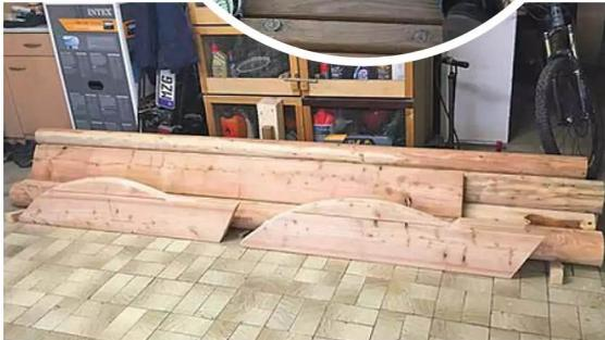
Massive Bohlen und Konstruktionshölzer aus Douglasie und Lärche bilden die stabile, witterungsbeständige Basis der Relaxschaukel
