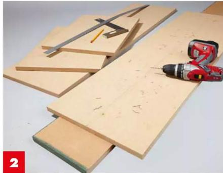
**2** An Rückwand und Seiten den **Verlauf der anliegenden Stirnholzkanten** und die **Bohrpunkte anzeichnen**, Löcher vorbohren.
