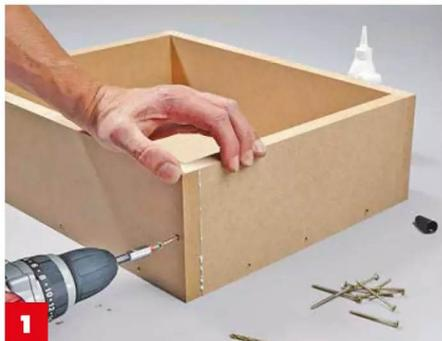
**1** Der kleine Kasten für DVD und CD ist ein simples Bauwerk. **Seiten und Boden sind stumpf gefügt, geschraubt und geleimt.**
