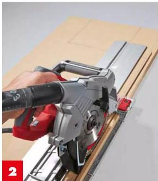
**2** Schiebetür-Nut mit Tauch- oder Handkreissäge setzen. Letztere bis ans Brettende führen, Kante mit Spachtelmasse schließen.
