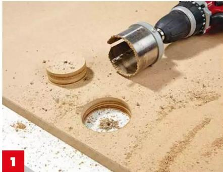
**1** Kabeldurchlässe vom **60-Millimeter-Lochbohrer** in Wänden und Deckplatte reichen auch für „großkalibrige“ Netzstecker.
