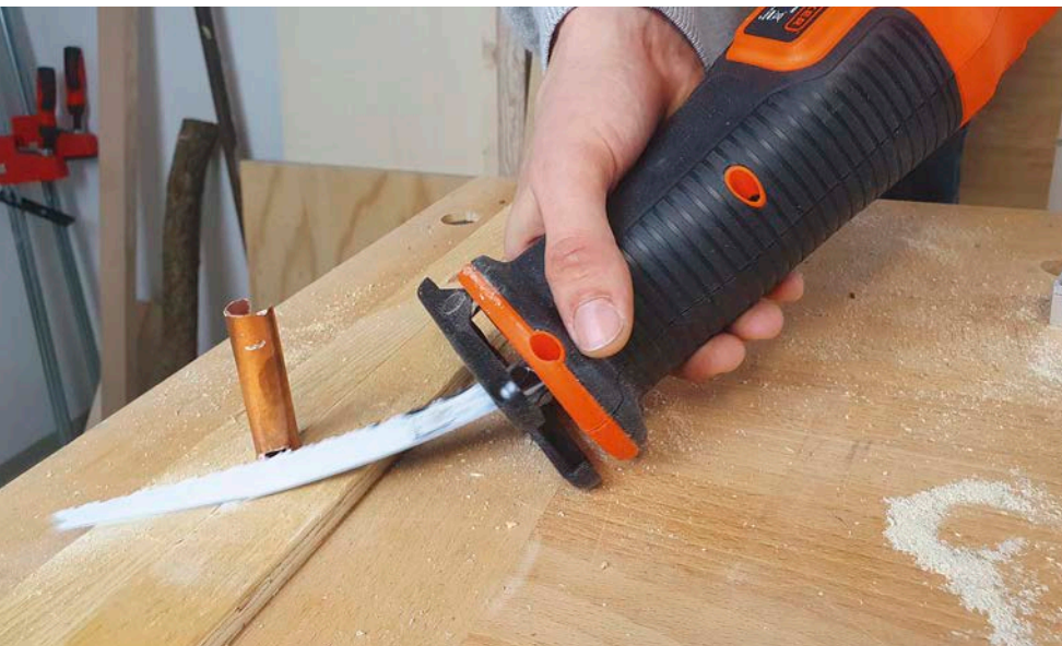
Bündiges Abtrennen: Das schafft man mit keiner anderen Säge so gut wie mit der Säbelsäge. Die langen Sägeblätter (bis zu 20 cm Schnittlänge) sind sehr flexibel
