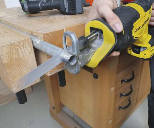
Ein Standard-Wasserrohr (Bild oben) haben wir mit jeder Säge zehnmal abgeschnitten , genauso wie ein Kupferrohr und ein Alu-Profil
