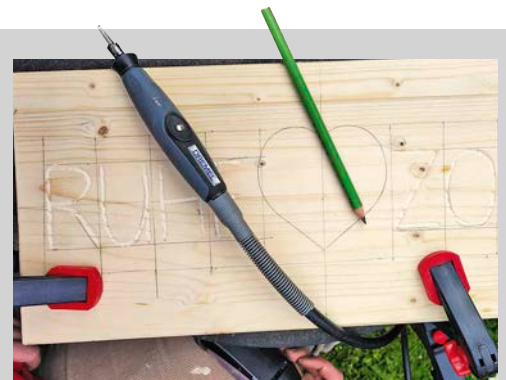
Ein Raster auf das Holz anzeichnen. Den Wunschtext übertragen und mit einem Dremel vorsichtig 2 mm tief eingravieren.
