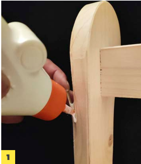
1 Spalten und Risse mit wasserfestem Leim (D3) ausbessern. Nach dem Aushärten mit Schleifpapier glätten.
