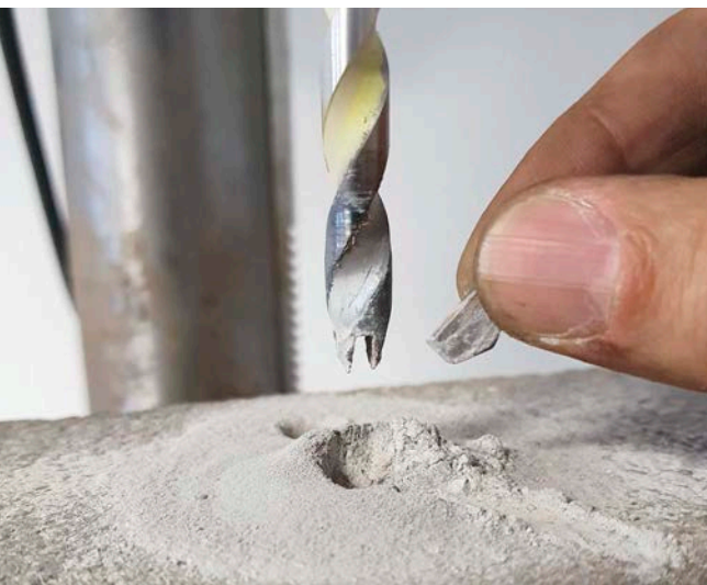
Abgebrochen: Beim 8,5-mm-Bohrer hat sich die Bohrspitze nach zwei Löchern in Beton schon verabschiedet. Beton setzt den Bohrern allgemein sehr zu
