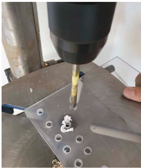
Plexiglas-Löcher werden mit frischen Bohrern sauber. Nach Betonbohren schmilzt das Material unter der stumpfen Spitze
