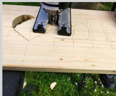
Ausschnitte: Ein Loch zum Eintauchen der Stichsäge bohren. Mit der Stichsäge das Motiv aussägen.
