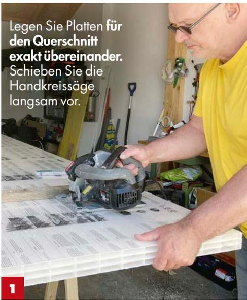
Legen Sie Platten für den Querschnitt exakt übereinander. Schieben Sie die Handkreissäge langsam vor.
