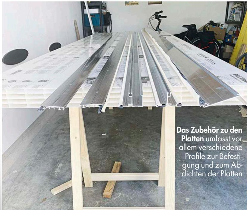
Das Zubehör zu den Platten umfasst vor allem verschiedene Profile zur Befestigung und zum Abdichten der Platten
