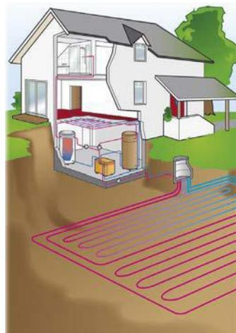
**Erd-Wärmepumpen** nutzen Energie aus dem Erdreich – hier durch Kollektoren
