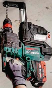
Das Bohrfutter des Kabelgeräts KHE 2845 Q (ca. 275 Euro) kann man werkzeuglos mit einer Hand wechseln
