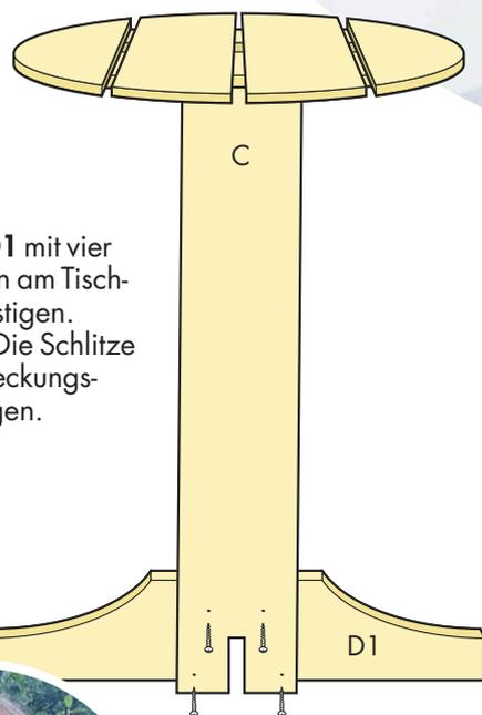
**5** Den Fuß D1 mit vier Schrauben am Tischbein befestigen. Wichtig: Die Schlitzte müssen deckungsgleich liegen.
