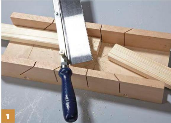
**1** Je Rahmen aus den 43 mm breiten und 22 mm starken Leisten **zwei Teile auf eine Länge von 242 und zwei Teile auf eine Breite von 16 cm** bringen.
