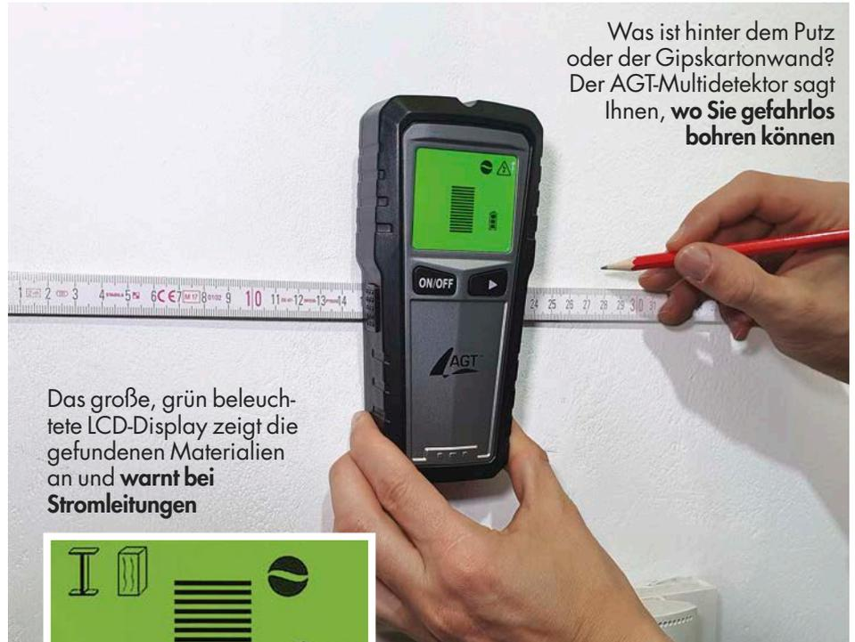
Was ist hinter dem Putz oder der Gipskartonwand? Der AGT-Multidetektor sagt Ihnen, **wo Sie gefahrlos bohren können**
