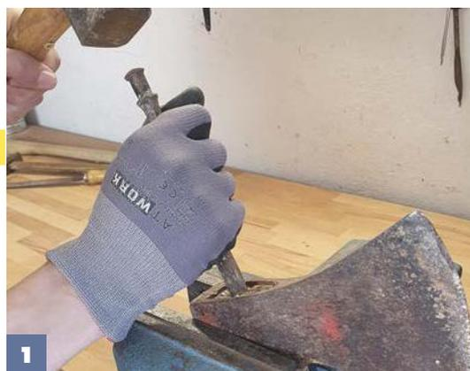
**1** Der Axtkopf wird festgespannt und mit einem Hammer und einem Stück Bewehrungsstahl das Holz aus dem Ohr geschlagen.
