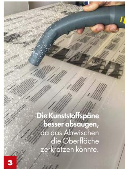
Die Kunststoffspäne besser absaugen, da das Abwischen die Oberfläche zerkratzen könnte.
