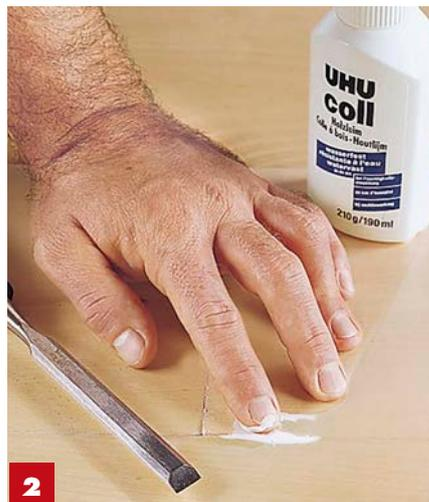
**2** **Abgesplittertes Holz:** Splitter mit Beitel anhebeln, wasserfesten Holzleim darunter verteilen, andrücken.
