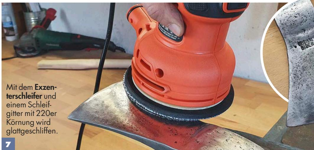
Mit dem **Exzentrerschleifer** und einem Schleifgitter mit 220er Körnung wird glattgeschliffen.
