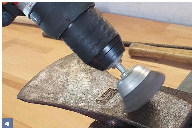
**4** Mit einer Drahtbürste für den Akkuschauber wird der äußere Rost beseitigt. Die Innenseiten des Axtöhrs müssen händisch mit Drahtbürste und Schleifpapier gesäubert werden.
