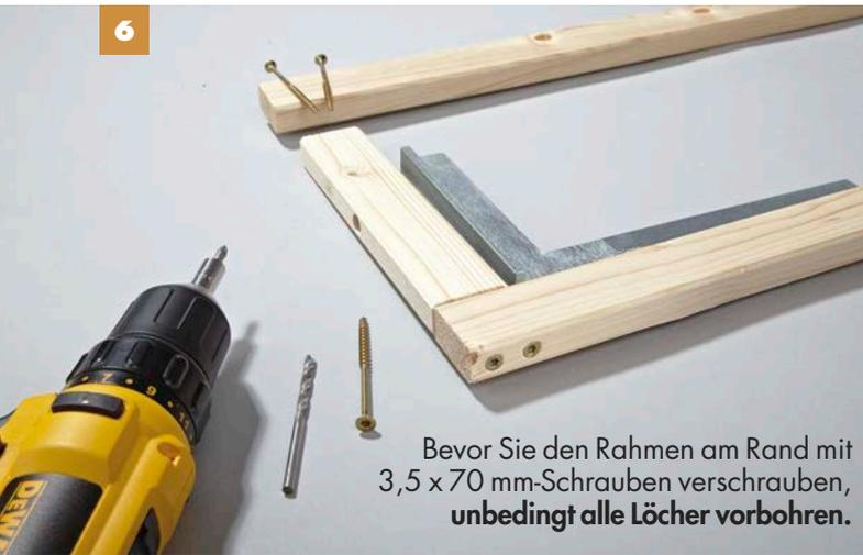
Bevor Sie den Rahmen am Rand mit 3,5 x 70 mm-Schrauben verschrauben, **unbedingt alle Löcher vorbohren.**
