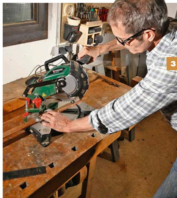
**3** Die Gehrung mit einer Kapp- und Gehrungssäge und einem sehr scharfen Sägeblatt herstellen. Jede Gehrung sägen und nacharbeiten, bis alles passt.
