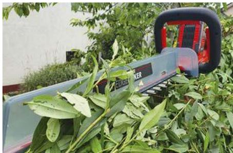
Mit dem **aufsteckbaren Plastikschild** wird das Schnittgut beim horizontalen Schnitt gleich mit abgeräumt
