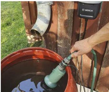
Die **Pumpe wird in die Tonne getaucht** und sinkt auf den Boden. Dann noch den Gartenschlauch anschließen – fertig!
