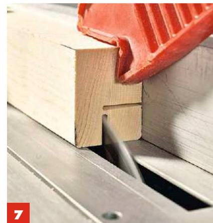
**7** Den zweiten Schnitt an allen sechs Segmenten des Rahmens durchführen.
