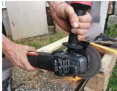
Einfache Trennarbeiten, wie hier bei einem Stahlrohr mit 5 mm Stärke und 2 cm Durchmesser, sind ruckelfrei erledigt.
