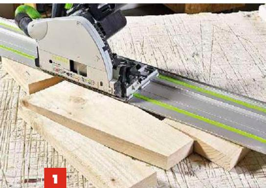
**1** Die Form für die Stütze der Rückenlehne zweimal auf einen je 415 mm langen Dielenabschnitt zeichnen, aussägen.
