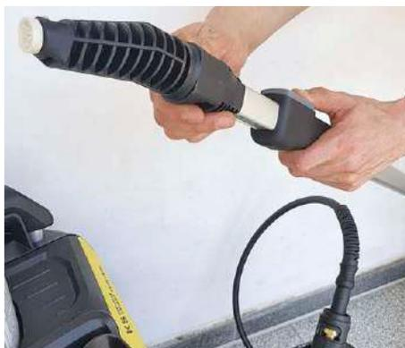
Die Hochdruckdüse am TLA-4-Aufsatz kann man **bis 3,70 m ausziehen**. Düse oder Bürste sind schnell gewechselt.
