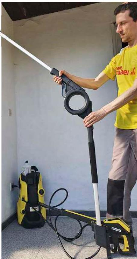
Das Gelenk in der Mitte des Verlängerungsarms kann man **stufenlos bis 180 Grad abwinkeln**.
