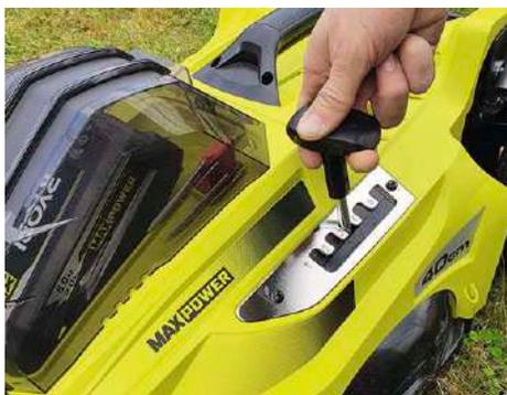
Sehr gut gelöst: Die **Mähhöhe** zwischen 20 und 70 mm wird mit einem sehr **leichtgängigen Hebel** zentral eingestellt
