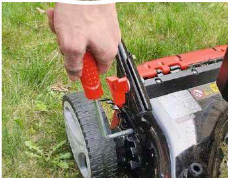
Sehr gut gelöst: Die **Schnitthöhe** wird zentral an einem leichtgängigen Hebel am hinteren rechten Rad eingestellt.
