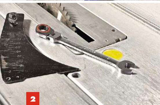
**2** Für den nächsten Arbeitsschritt den Spaltkeil aus der Tischkreissäge entfernen.
