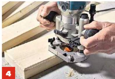
**4** **Mit der Oberfräse** und einem Fasenfräser sämtliche oberliegende, umlaufende Kanten anfasen.
