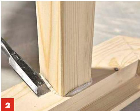
**2** Nach dem Aushärten den überstehenden Leim entfernen. Das Gestell mit 120er-Schleifpapier abschleifen und entstauben.
