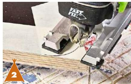
Malerkrepp auf Ecken der Segmente kleben und Rundungen anzeichnen. **Ohne Pendelhub und großen Druck aussägen.**
