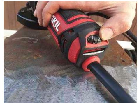
Die Drehzahl ist einstellbar, während der Arbeit reguliert die Konstantleistungselektronik die Arbeitslast.
