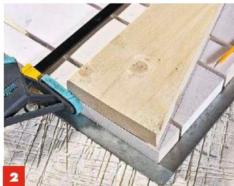
**2** Die Bretter der Lehne rechtwinklig ausrichten, fixieren. Stütze unten bündig anlegen und Schräge übertragen.
