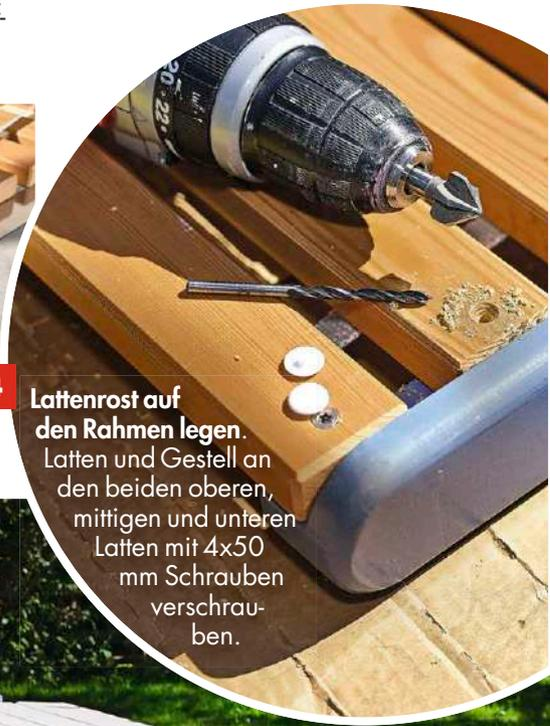
**4** Lattenrost auf den Rahmen legen. Latten und Gestell an den beiden oberen, mittigen und unteren Latten mit 4x50 mm Schrauben verschrauben.
