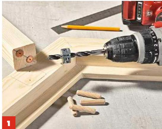
**1** Position der Querstreben an den Seitenteilen markieren und Löcher vorbohren. Dübel einstecken, verleimen und mit Zwingen oder Gurten fixieren.
