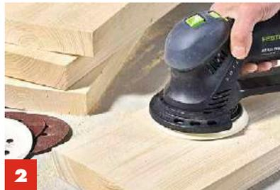
**2** **Ober- und Unterseite aller Stücke** mit 40er- und in einem zweiten Durchgang mit 80er-Schleifpapier glätten.
