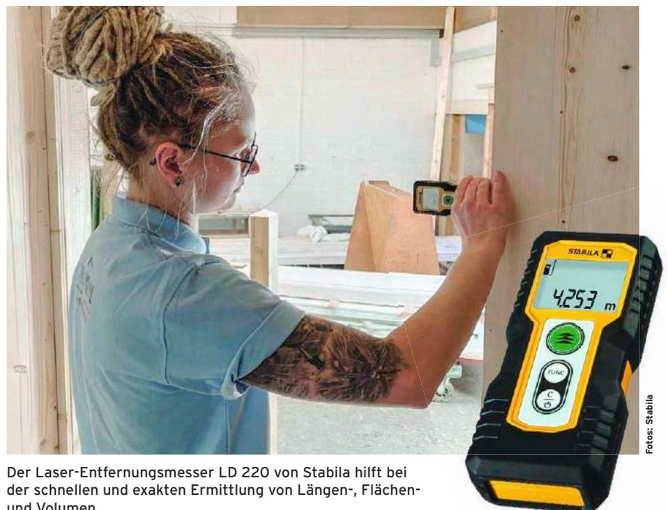
Der Laser-Entfernungsmesser LD 220 von Stabila hilft bei der schnellen und exakten Ermittlung von Längen-, Flächen- und Volumen.
