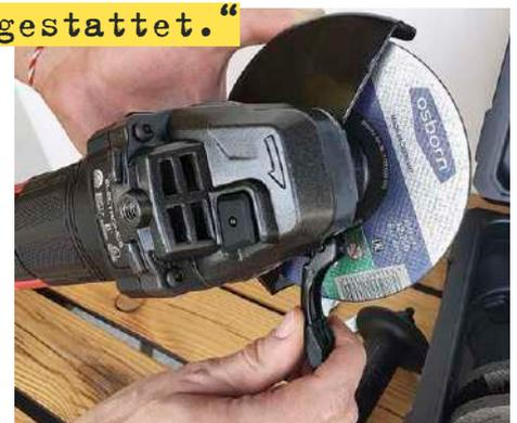
Eine mit Schnellverschluss verstellbare Schutzhaube wie hier ist bei vielen Winkelschleifern immer noch nicht Standard.
