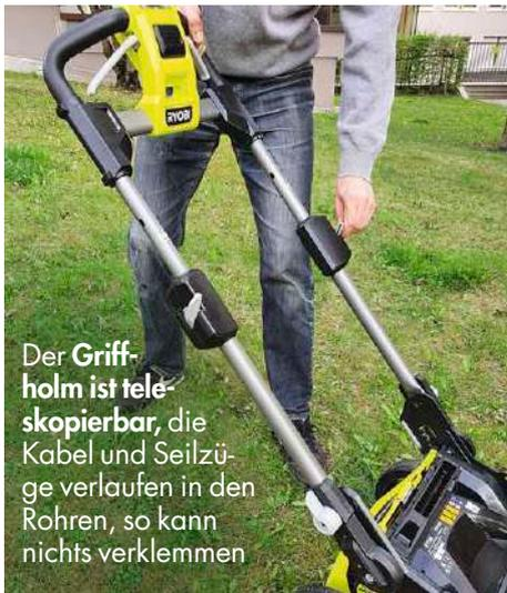
Der **Griffholm** ist **teleskopierbar**, die Kabel und Seilzüge verlaufen in den Rohren, so kann nichts verklemmen
