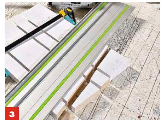
**3** Sägen Sie mit Handkreissäge und Führungsschiene **an der Markierung entlang**.
