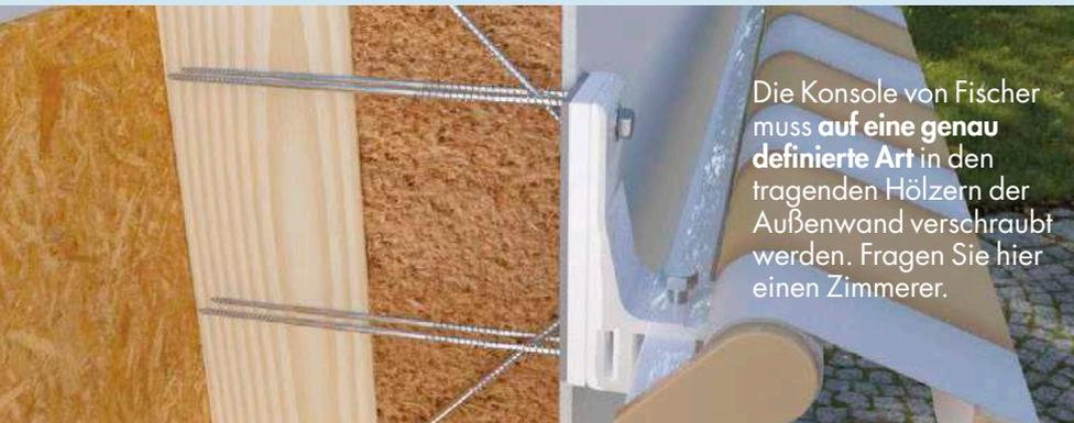
Die Konsole von Fischer muss **auf eine genau definierte Art** in den tragenden Hölzern der Außenwand verschraubt werden. Fragen Sie hier einen Zimmerer.
