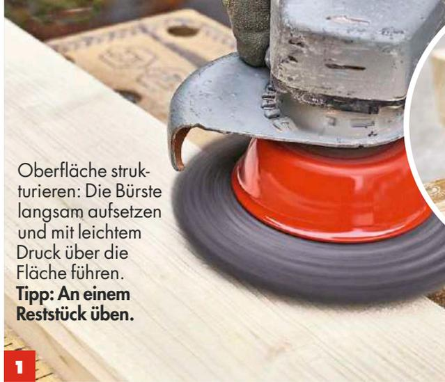
Die Oberfläche kann nach Wunsch **mehr oder weniger stark gebürstet** werden. Je stärker, desto sichtbarer wird die Struktur.
