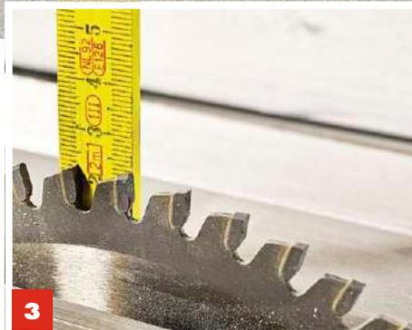
**3** Das Sägeblatt auf eine **Schnitttiefe von 23 mm** einstellen. Daraus ergibt sich später die Breite der Auflagefläche.
