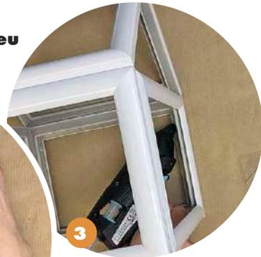
**3** An den **beiden langen Seiten** des Korpus wird je ein Rahmen für das Dach befestigt. **Verkleben** Sie die beiden auch am **Dachfirst**.
