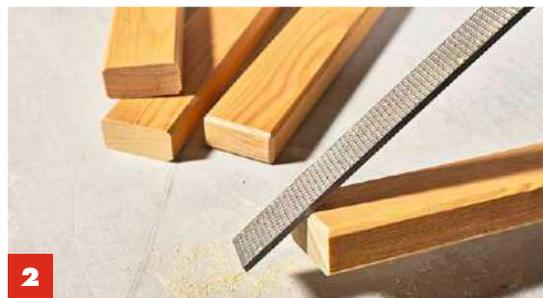
**2** Die Schnittkanten mit einer Raspel und Schleifpapier brechen. Tipp: Die Kanten mit einer Oberfräse anfasen, das geht schneller.
