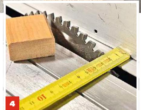
**4** Am **Parallelanschlag 21 mm** einstellen. Das entspricht der Höhe der Lärchenholz Bretter. Probestück sägen.
