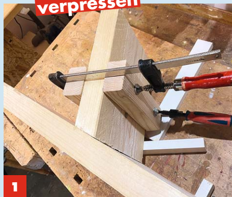
1 Befestigen Sie zwei Lattenabschnitte auf beiden Seiten des zu montierenden Brettabschnittes mit zwei Zwingen.
