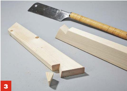
Mit einer **Handsäge** wird anschließend der komplizierte „Keil“ herausgesägt.
