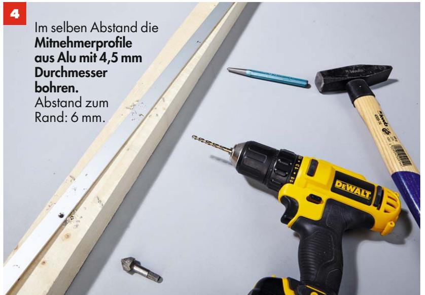
**4** Im selben Abstand die Mitnehmerprofile aus Alu mit 4,5 mm Durchmesser bohren. Abstand zum Rand: 6 mm.
