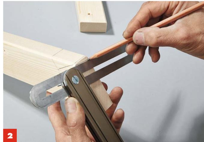
Da die Rückenlehne eine Neigung von 100 Grad besitzt, muss jetzt noch die **Aussparung** mit der 100-Grad-Neigung kombiniert werden. Mit einer Tischlerschmiege wird dann der 100-Grad-Winkel, wie gezeigt, angetragen.
