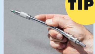
**So erreichen Sie jede Schraube:** Die Schrauben der Lamellenlagerbleche sitzen so dicht an den Lamellen, dass man nur mit einem **flexiblen Bithalter** rankommt (Seite 13, Schritt 2). Diesen gibt es in Längen von 20-30 cm im Onlinehandel und im gut sortierten Baumarkt für rund 10 Euro. Nehmen Sie einen mit **Magnetbithalter**, dann müssen Sie die Schrauben nicht extra festhalten.
