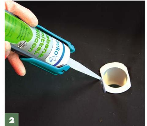
**2** Die Halterung des Stutzens abtrennen und den Stutzen mit lebensmittelechtem Silikon luftdicht auf die Folie kleben.
