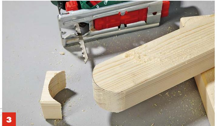
**3** Die Rundungen der Rückenlehnen mit einer Stichsäge mit Kurvensägeblatt entlang der Linie aussägen.
