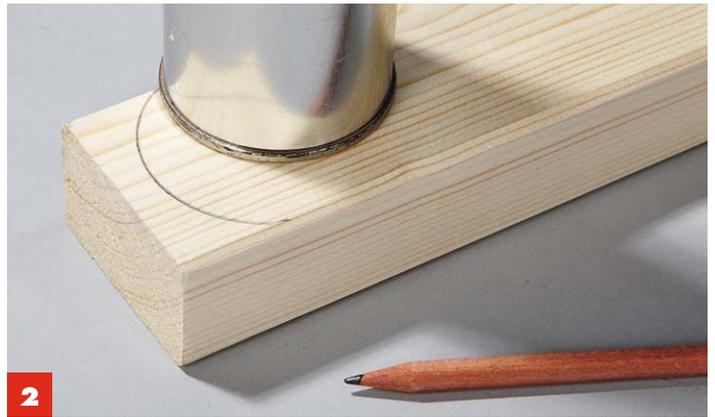
**2** Die Rundungen am oberen Ende der Rückenlehne mithilfe einer Tasse oder einem runden Tischbein anzeichnen.
