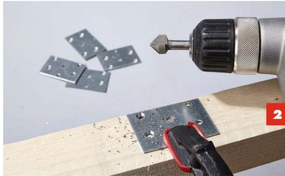
**2** Die äußeren Montagelöcher ansenken, damit später die Schraubenköpfe bündig sind.
