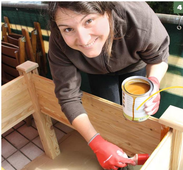
**4** Zum Schutz des Holzes tragen Sie dünn und in Faserrichtung die Außenlasur auf – bei etwa 20 Grad circa 12 bis 14 Stunden trocknen lassen.
