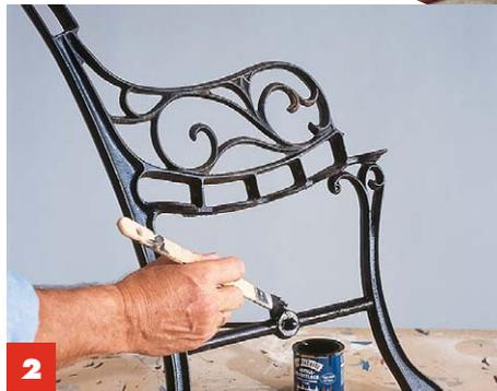
**2** Nach der Reinigung schützen Sie die Teile vor erneutem Rostbefall mit einer **Rostschutzfarbe** (hier von Hammerite).
