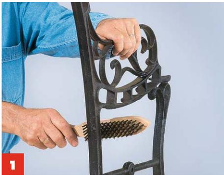
**1** Die gusseisernen Seitenteile der Bank werden mithilfe einer **Drahtbürste** gründlich von Roststellen befreit.
