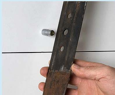
Das Schneidmesser an der **Mittelbohrung** über eine Schraube an der Wand stecken. Auspendeln lassen.
