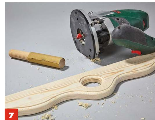
Abschließend alle Kanten mit der **Oberfräse** abrunden und bei Bedarf mit etwas Schleifpapier nachbearbeiten.
