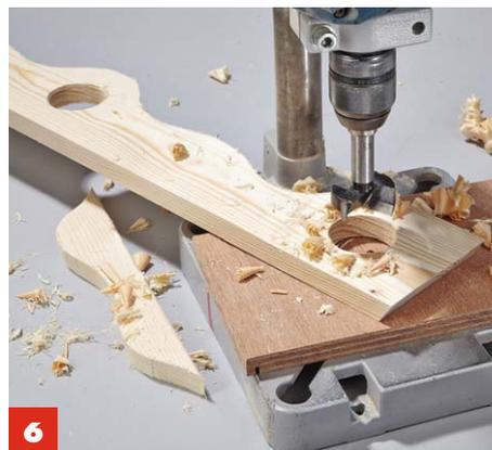
Die einzelnen **Zierlöcher** werden mit einem 45 mm Forstnerbohrer angefertigt. Möglichst einen Bohrständler verwenden.
