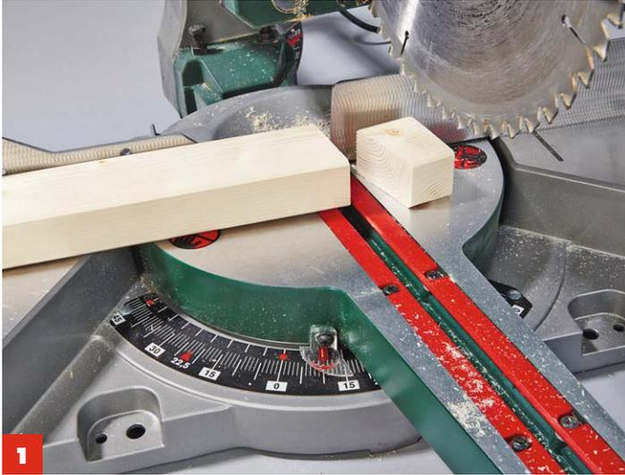
**1** 100-Grad-Schrägung am besten mit einer Kapp- und Gehrungssäge anfertigen.
