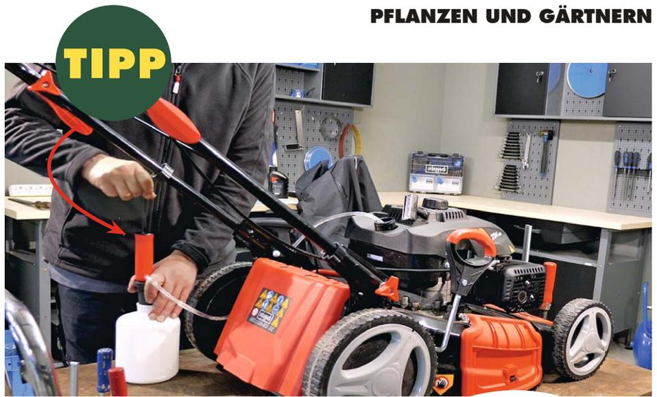
Alter Kraftstoff kann einfach mit einer **Benzin-Handpumpe** abgepumpt und an der Tankstelle abgegeben werden
