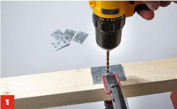
**1** Bewegliche Lamellen: Bauen Sie ein Lager aus Schrauben und Verbinderblechen (40 x 60 mm, Mittelloch 5,5 mm aufbohren).
