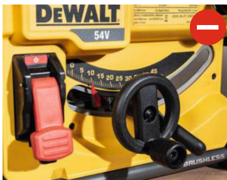
Die Sägeblattneigung verzichtet auf ein Stellrad – präzise Einstellungen des Winkels erfordern etwas Geduld
