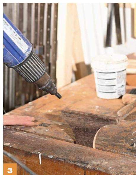
3 ... wässern, nach dem Trocknen mit 240er und 320er Körnung schleifen. Wässern, wieder mit 320er Körnung schleifen. Den Schleifklotz gerade halten und von innen nach außen arbeiten. Mit einem Heißluftfön trocknet's schneller.
