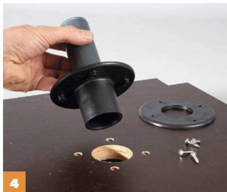
4 Flansch probehalber einsetzen . Er wird in Schritt 5 (S. 63) mit Sechskantschrauben mit der Folie zusammengeschraubt .
