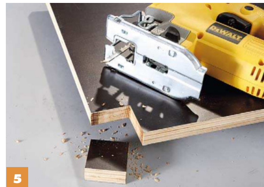
5 Dann die Bodenplatte an den Pfosten ausklinken . Dabei den Pendelhub der Stichsäge auf kleine Stärke (0-1) stellen.
