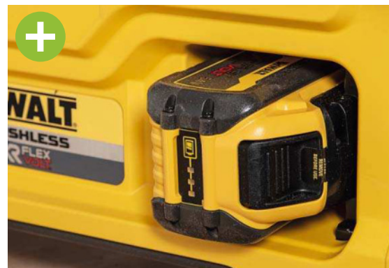
Ein groß dimensionierter Akku mit 54 Volt bringt genügend Ausdauer auch für längere Sägearbeiten mit
