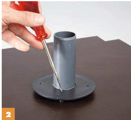
2 Danach werden die Montagebohrungen für den Flansch des PVC-Rohrs mit einer Ahle auf der Siebdruckplatte markiert .
