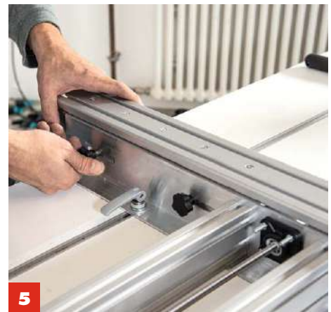
5 Dank der vier M8-Sterngriffschrauben und der Nuten lassen sich die Profile schnell verstellen und wieder arretieren.
