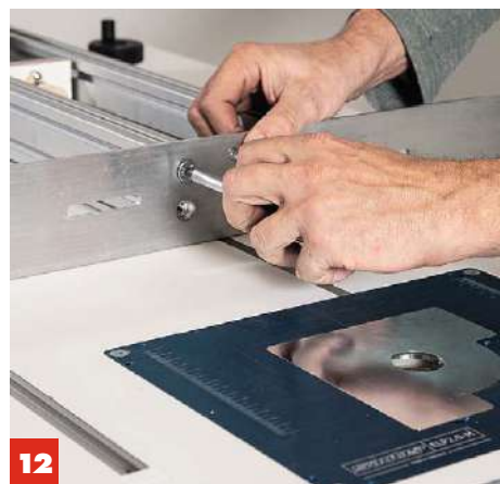
9 Führen Sie die Grundplatte nach hinten und ziehen Sie auf beiden Seiten die jeweils erste Schraube fest an.
