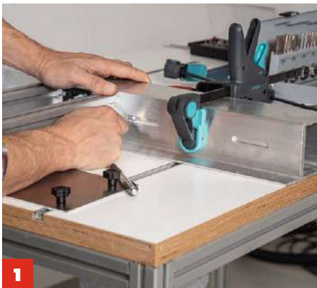
1 Die Rohre mittig ausrichten und fixieren. Nun in den Nuten des L-Profils die jeweiligen „geschlossen“ Positionen kornen.
