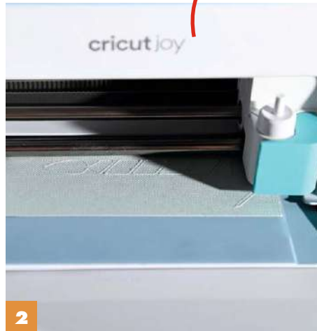
2 Die Matte in Pfeilrichtung einlegen. Der Plotter zieht sie mit seinen Walzen ein und schneidet die Konturen des Designs.
