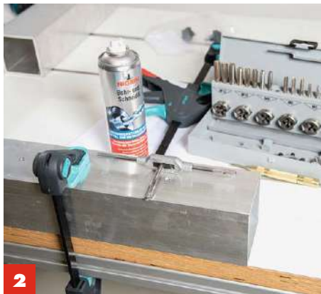
2 In die vier Löcher mit 6,5 mm Kerndurchmesser werden nun die M8-Gewinde für die Sterngriffschrauben geschnitten.
