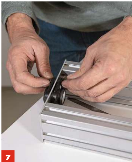
8 Schieben Sie die Führungseinheit auf die Schlitten der Grundplatte . Die lockere Verschraubung hilft beim Ausrichten.
