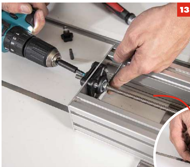
10 Wiederholen Sie diesen Schritt am anderen Ende. Wenn die Führung flüssig läuft , ziehen Sie alle Schrauben fest an.
