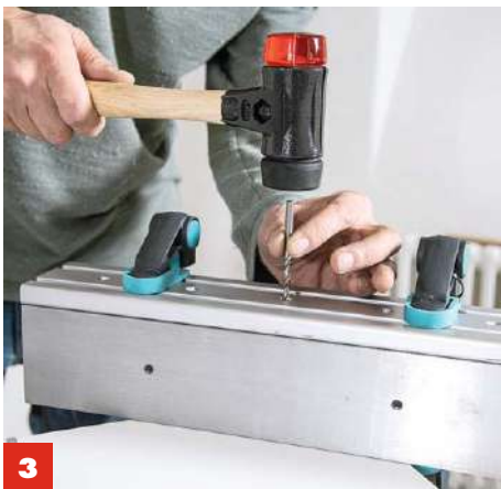
3 Das Querschlittenprofil bohren, senken, und die Bohrungen auf das Quadratprofil übertragen. M5-Gewinde schneiden.
