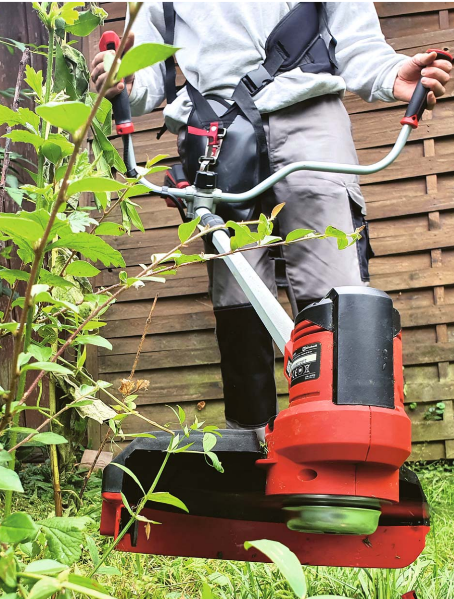
Das Dreizahnmesser schneidet starken Bewuchs, wo der Rasenmäher nicht weiterkommt
