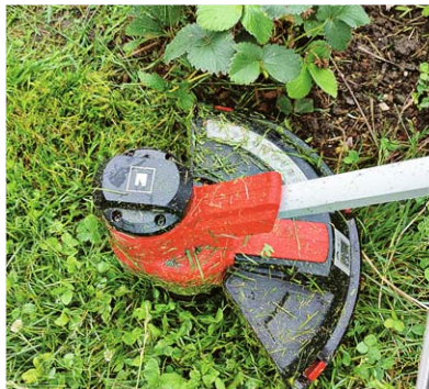
Der Fadenradius beträgt 30 cm, die Haube schützt empfindliche Gewächse
