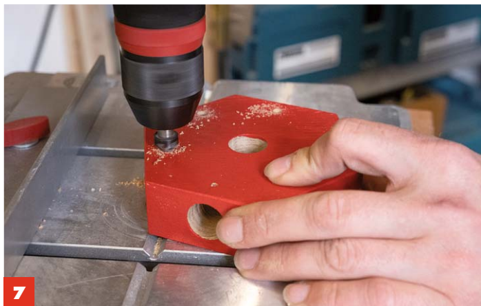
7 Den Kranz vorbohren (je mittig zu den seitlichen Bohrungen) und Bohrlöcher senken . Diese Befestigung verhindert später das Verdrehen der Rotorblätter.
