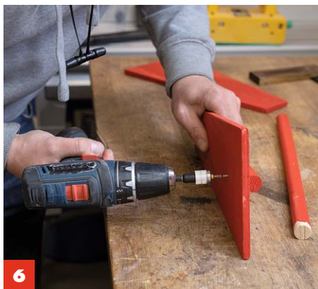
6 Nun etwas Leim auf die Rundhölzer geben und sie über die vorgebohrten Löcher mit den Rotorblättern verschrauben.
