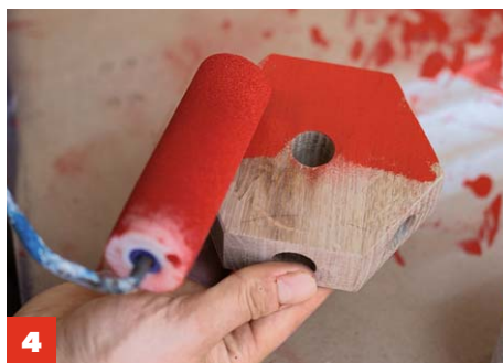
4 Sechs Rundhölzer auf 30 cm ablängen. Rundhölzer, Sechseck und Blätter anschleifen, mit Wetterschutzlack lackieren.
