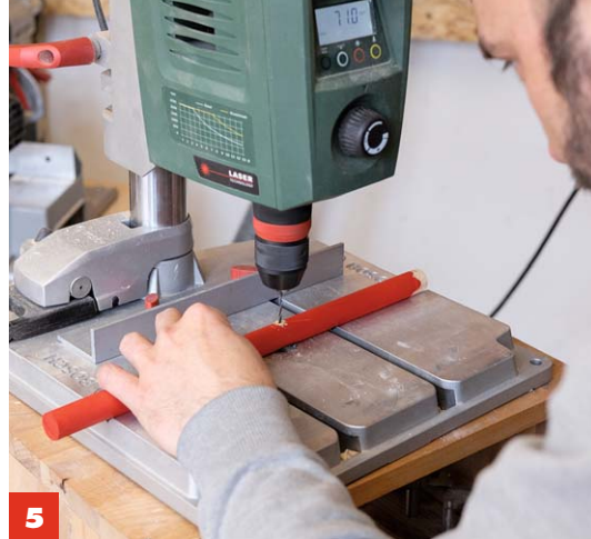
5 Mit 1,5-mm-Holzbohrer vorbohren : 7 cm vom schmalen Ende und mittig (Rotorblätter), 4 und 20 cm von außen (Rundhölzer).
