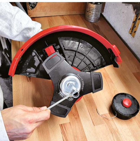
Der Wechsel zwischen Messer und Fadenspule geht mit dem Schraubenschlüssel schnell
