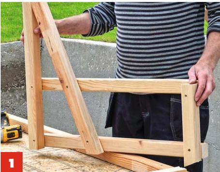
**1** 4x Giebelteile nach derselben Schablone wie für die Sonnenliege **anfertigen**: Bei zwei liegen die Trägerleisten (70,3 cm) am unteren Rand der Schablone, bei zwei spiegelverkehrt am oberen Rand.
