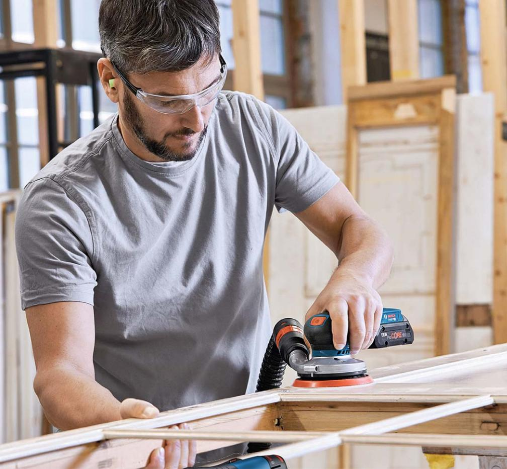
Die **kompakten Schleifer** lassen sich mit einer externen Absaugung kombinieren
