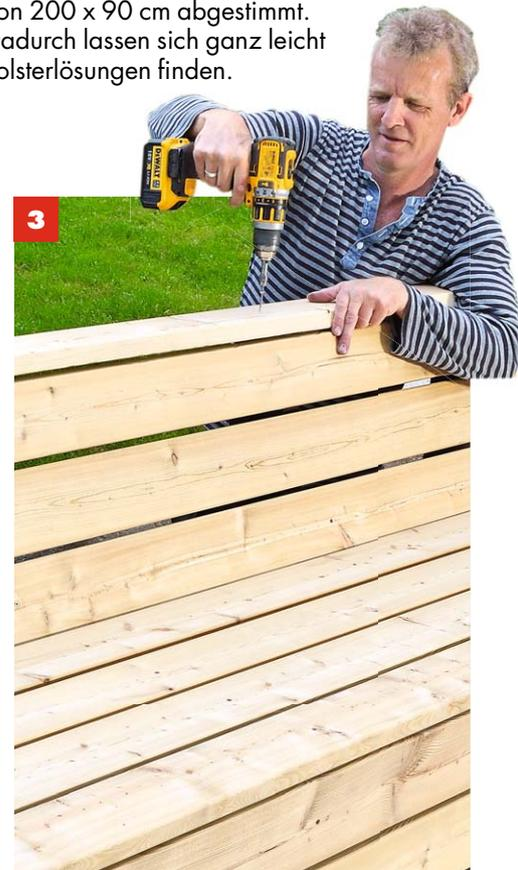
**3** Die **Unterkonstruktion des Sofas verkleiden** Sie mit Deckbrettern und 4,2 x 56 mm großen Edelstahlschrauben. Beachten Sie, dass das oberste Deckbrett der **Rückenlehne auf 22,5°** Gehrung zugesägt ist.
