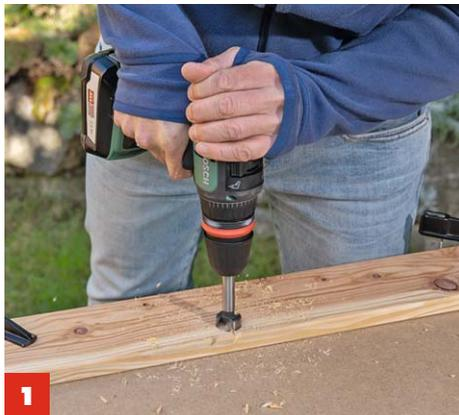
**1** Auf Höhe der Mitte von Brett C 25 mm vom Rand nach innen rücken, ein Loch mit dem 25er-Forstnerbohrer bohren.
