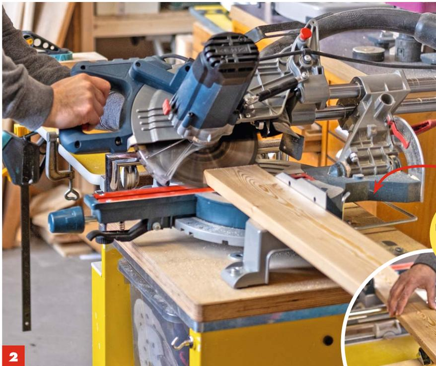
Die Kappsäge auf 45° einstellen und die in Schritt 1 zugeschnittenen Teile der Beplankung auf beiden Seiten auf Gehrung sägen.
