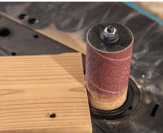
Suboptimal: Durch die **Abkantung am Bandschleifer** wird die untere Kante des Werkstücks rund geschliffen
