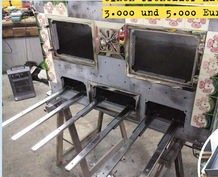
Kugelgelagerte Schubladenzüge sorgen für eine hohe Seitenstabilität und präzise Führung
