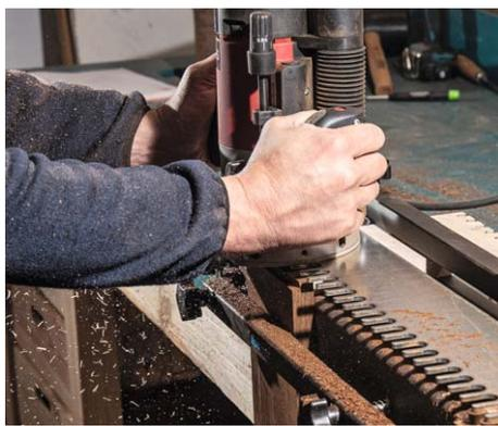
Quick, aber dirty: Da man seitlich in das Werkstück einfährt, **funktioniert die Staubabsaugung nur mäßig**
