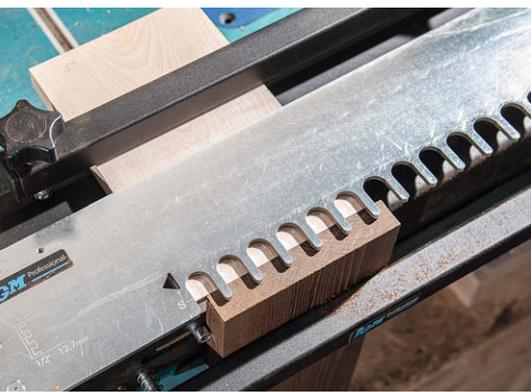
**Spezielle Fräskämme** dienen der Führung der Oberfräse. Meist lassen sich sogar beide Werkstücke gleichzeitig fräsen
