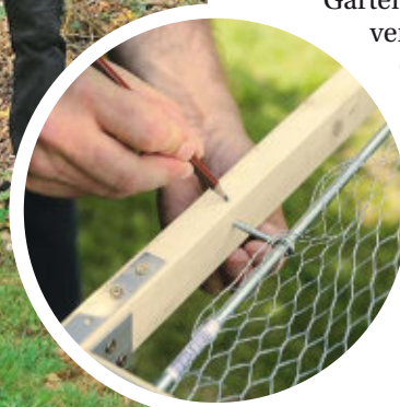
Das Netz mit Hakenschrauben am Rahmen spannen und befestigen
