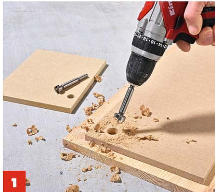
**1** In die **Seitenteile und Rückwand** Montagelöcher (20 mm) und ein Loch für die Stromzufuhr (15 mm) bohren.
