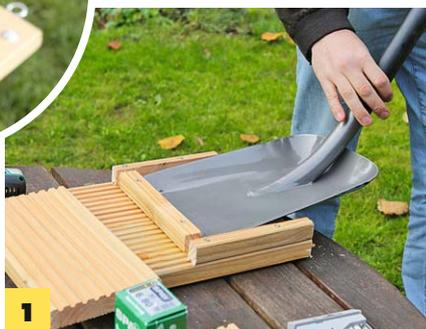
**1** Seiten- und Deckbretter für das Einschubfach **ablängen**, Kanthölzer festschrauben mit einer Schaufel als Maß.
