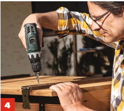
**4** Nun können **die Scharniere und der Sturmhaken** montiert werden. Vorbohren nicht vergessen!
