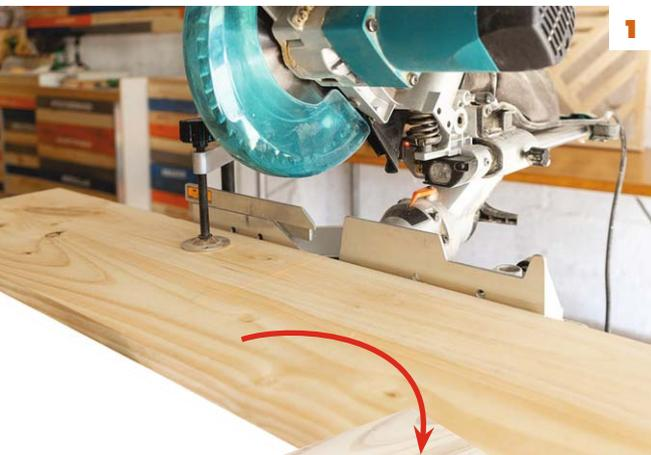
**1** Mit der **Kapp-, Kreis- oder Stichsäge** mehrere unterschiedlich große Teile aus der Kiefernplatte fertigen.
