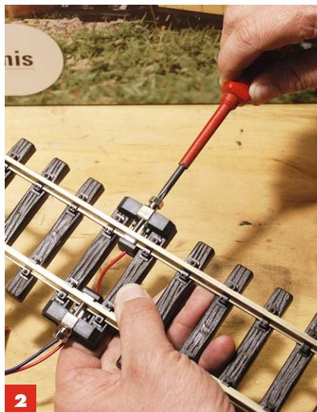
**2** Die zusammengefügt Gleiskontakte mit einem Kreuzschlitz-Schraubendreher gegen Vibrationen fixieren.
