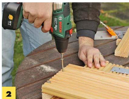
**2** **Montieren:** zwei Schrauben pro Brett. Kanthölzer als Stütze für die Schaufel unter das Einschubfach leimen.
