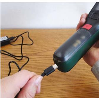
Universal-Anschluss: Die Bosch Easy Pump wird mit **USB-C Kabel aufgeladen**
