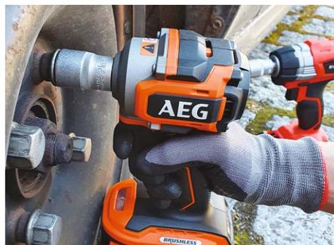
Radmuttern: Selbst die härtesten Lösedrehmomente sind mit dem AEG kein Problem
