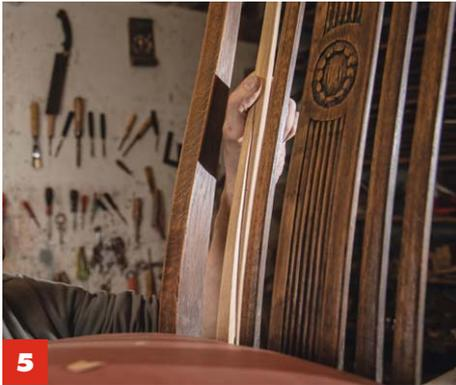
**5** Nun liegt der Zapfen bündig an und die Leimfuge lässt sich über die komplette Länge schließen. So soll es sein!
