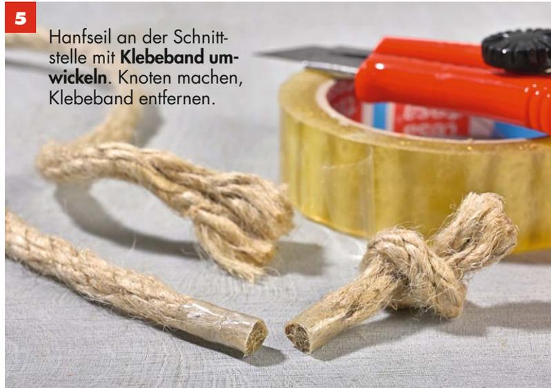
**5** Hanfseil an der Schnittstelle mit **Klebeband umwickeln**. Knoten machen, Klebeband entfernen.
