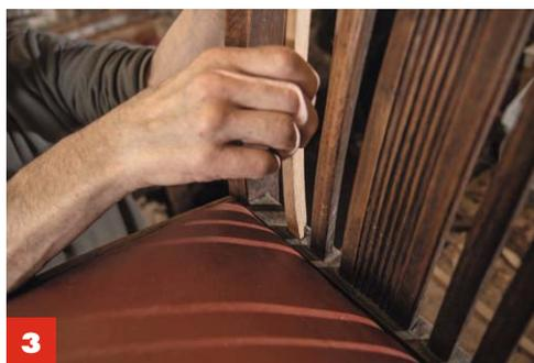
**3** Ein erster Passversuch: Noch ist der Zapfen zu groß, um in den Schlitz zu passen. **So ginge die Shift-Verbindung nicht zu.**
