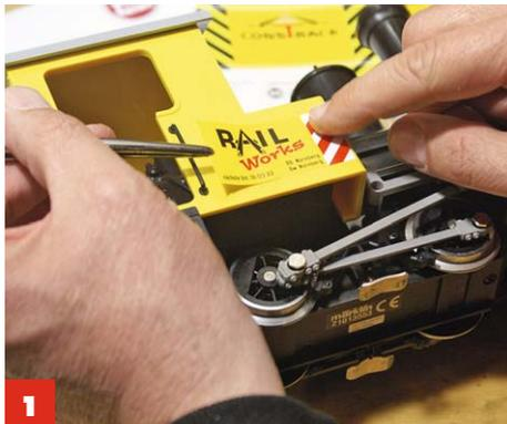
**1** Wichtig ist, dass Sie die Aufkleber nicht einfach abziehen und draufkleben: besser mit der Pinzette präzise aufbringen.
