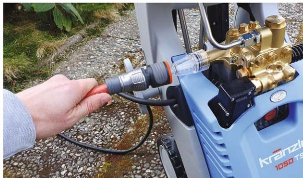
Hochwertig: Der Pumpenkopf ist aus Messing, das Stecksystem der Lanzen aus Edelstahl
