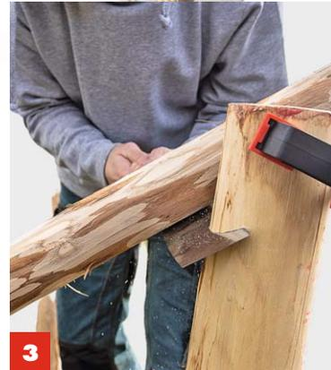
**3** Am oberen Ende sägen Sie so weit ein, dass die Schnittbreite der Breite der Verstrebung entspricht.
