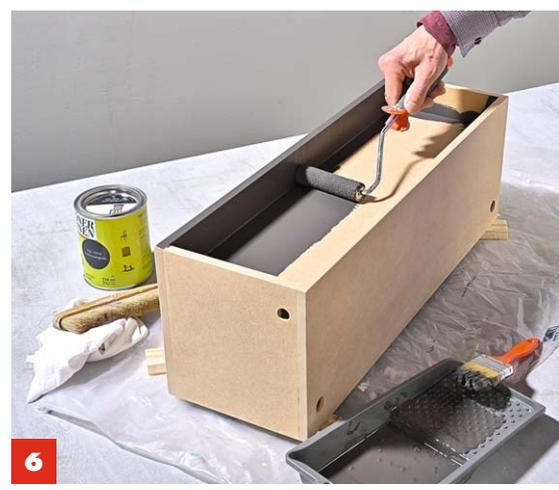
**6** Lackieren, durchtrocknen lassen, mit 150/180er-Körnung schleifen. Entstauben. Dann ein zweites Mal **lackieren**.
