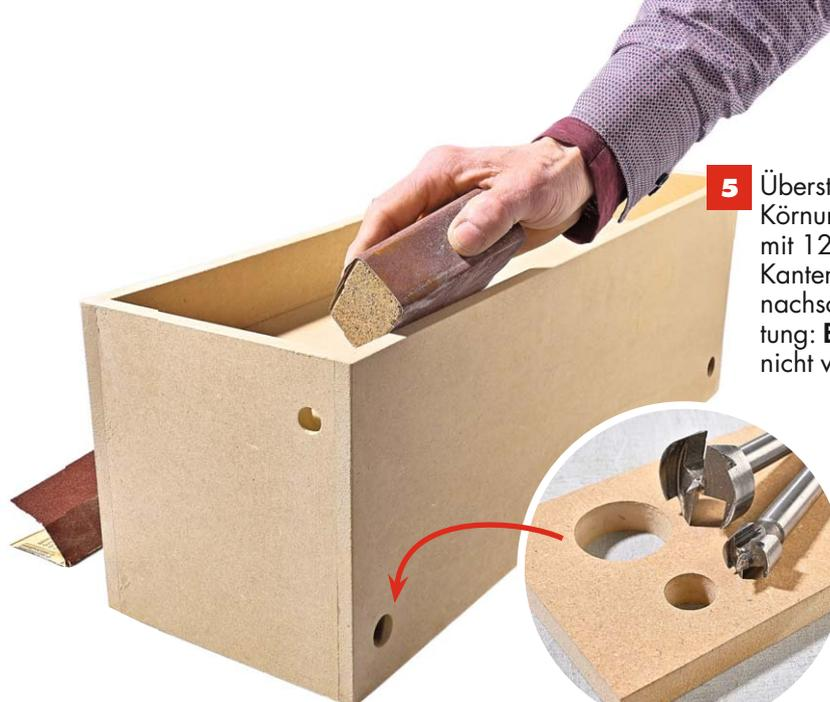
**5** Überstände mit 80er-Körnung **schleifen**, mit 120er-Körnung Kanten brechen und nachschleifen. Achtung: **Entstauben** nicht vergessen!
