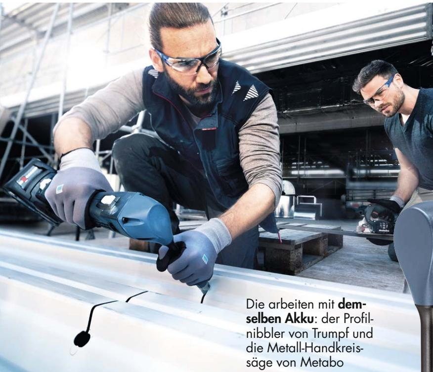
Die arbeiten mit demselben Akku: der Profilnibbler von Trumpf und die Metall-Handkreissäge von Metabo
