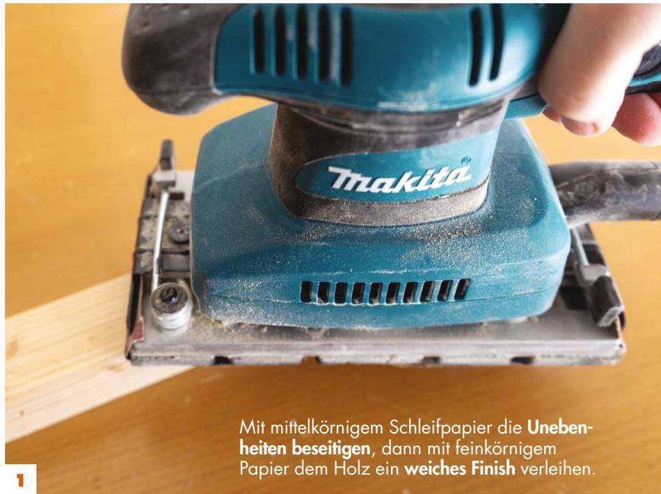
Mit mittelkörnigem Schleifpapier die **Unebenheiten beseitigen**, dann mit feinkörnigem Papier dem Holz ein **weiches Finish** verleihen.
