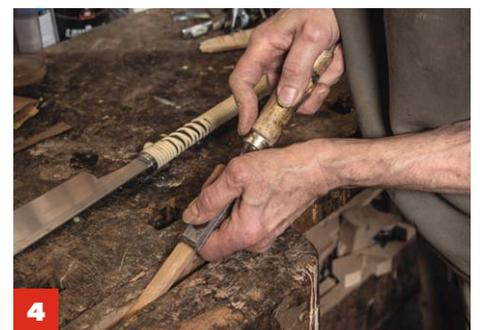
**4** **Mit einem scharfen Stemmeisen** wird der Zapfen angepasst, bis die Sprosse formschlüssig zum Liegen kommt.
