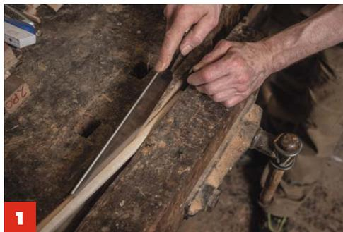
**1** Der Schnitt geht **diagonal über die ganze Länge der Sprosse**. Da diese gebogen ist, wird der Anriss mit Klebeband markiert.
