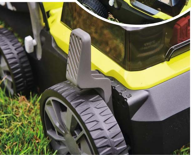
Die Schnitttiefe der Walze des Modells ist in vier Stufen von -2 bis -12 mm verstellbar
