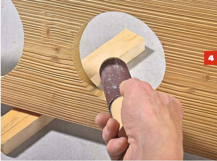
**4** Die Schnittkanten bearbeiten Sie mit dem **Schleifpapier** nach, bis das Holz glatt ist.
