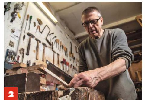
**2** Nun wird gesägt. Die **flache Führung der Japansäge** verhindert, dass der Schnitt über die Länge verläuft.
