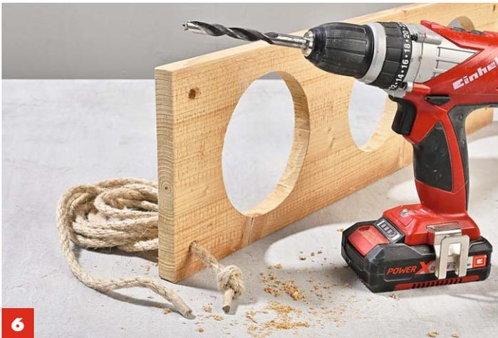
**6** Je 3 cm vom Rand eingerückt, **bohren** Sie vier Befestigungslöcher á 10 mm in die Ecken des Bretts. Das Seil einfädeln. Zuletzt Montagelöcher für die Schraubhaken in die Decke bohren.
