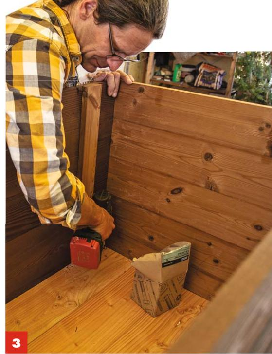
**3** Die Gehrungsleisten werden **an der Unterkante verleimt und geschraubt**. Dann werden die Bodenbretter verschraubt.
