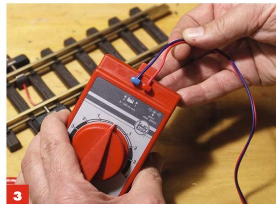
**3** Durch Drücken der Kontaktanschlüsse am Fahrpult können die jeweils dazu passenden Farben eingesteckt werden.
