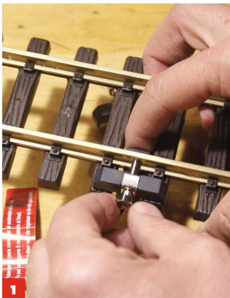
**1** Den Gleiskontakt mit der Hand an beiden Gleissträngen von außen einhängen und mit der Schraube festdrehen.
