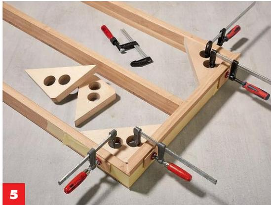
**5** Alle Teile verbinden und mit **Malerkrepp und Zwingen** fixieren. Die Verbindungen auf **Rechtwinkligkeit** prüfen.
