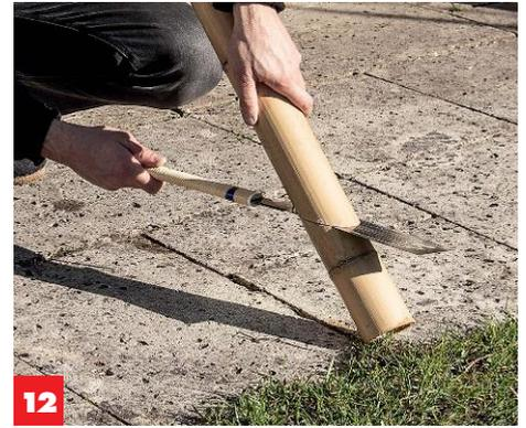
**12** **Bambus zerfasert leicht** und wird splittig. Verwenden Sie eine scharfe Japan-säge und sägen Sie, ohne zu forcieren!
