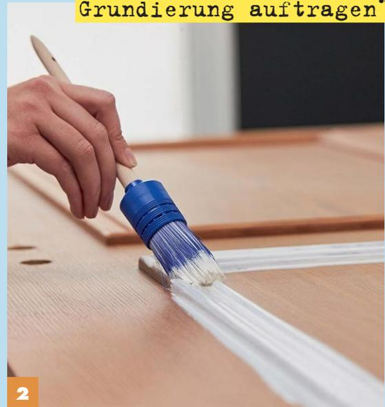
**2** Die Oberfläche mit *Home Grundierung* für Holz und MDF-Platten **grundieren**. Nachdem sie getrocknet ist, erneut **anschleifen**.
