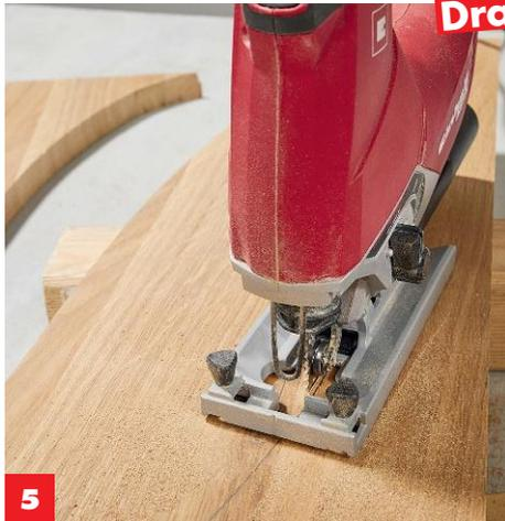
**5** Mit einer Zugabe von circa 2 mm entlang der aufgezeichneten Linien die **Tischbeinhälften** aussägen.
