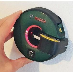
**Rot:** Der Laser ist noch nicht waagrecht, das Gerät muss noch weiter gedreht werden
