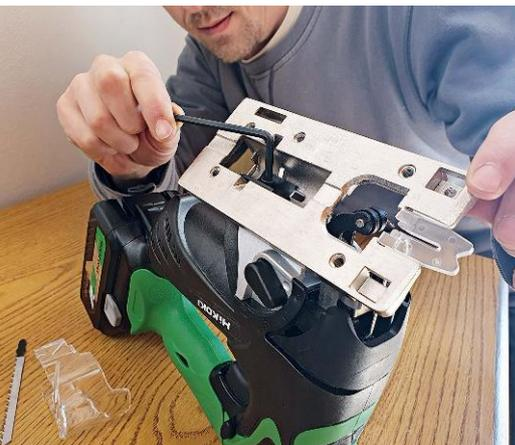
Stabil und verwindungssteif: Die **Grundplatte mit Inbus-Halter** ist aus nickelbeschichtetem Aluminium gefertigt
