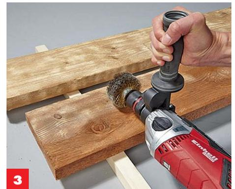
**3** Mit dem Drahtaufsatz der Bohrmaschine das **Holz ausbürsten**. Durch den Abrieb wird ein rustikales Ergebnis erzeugt.
