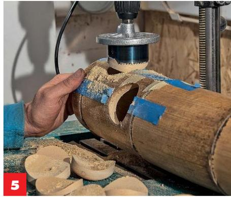
**5** Dank der Pilotlöcher wird die **Lochsäge sauber geführt**. Damit sollten die Bohrungen der Beine sauber fluchten.
