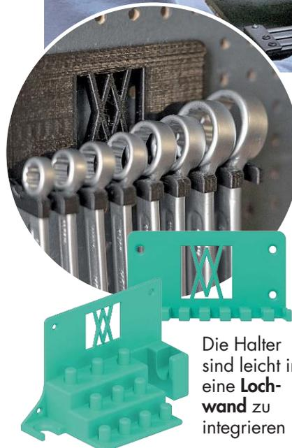
Mit den kostenlosen Druckvorlagen der *Enable-3D*-Serie von Wiesemann 1893 können Sie Werkzeughalter per 3D-Drucker selbst ausdrucken. Die Halter sind aus Kunststoff und speziell auf die Herstellerprodukte abgestimmt. So greift zum Beispiel der Wandhalter für einen zwölfteiligen Steckschlüsselsatz (1/2") Ratsche, Verlängerung und Einsätze. Wer keinen 3D-Drucker besitzt, kann sich einen Halter mit einem frei zugänglichen „Community Printer“ drucken.
