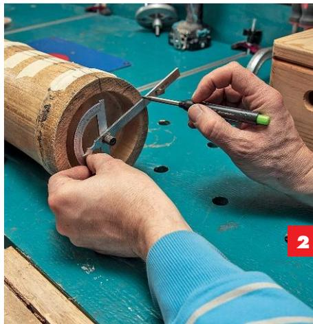
**2** Mit dem **Winkelmesser** wird nun der Beinwinkel von 70° durchgehend und an beiden Enden des Rohrs markiert.
