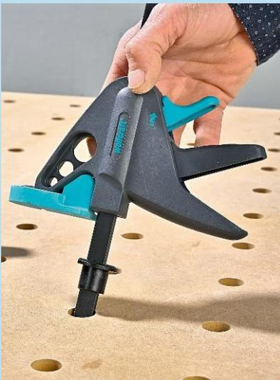
**Super gelöst:** Der Zwingenkopf wird abgenommen und auf der Unterseite des MFT wieder aufgesteckt. So lassen sich die Spanner auch als Einhandzwinde nutzen
