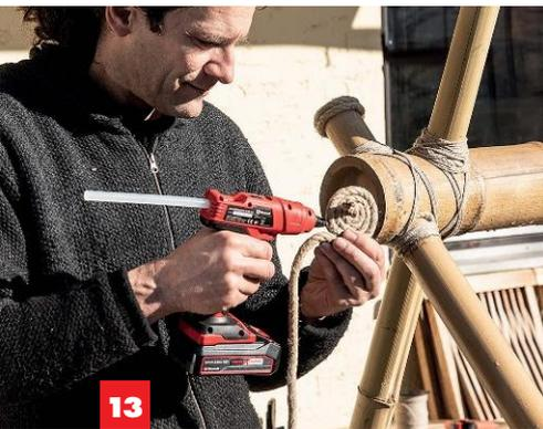
**13** Damit sich in den Rohren **kein Wasser sammelt**, werden die Enden mit Hanfseil verschlossen.
