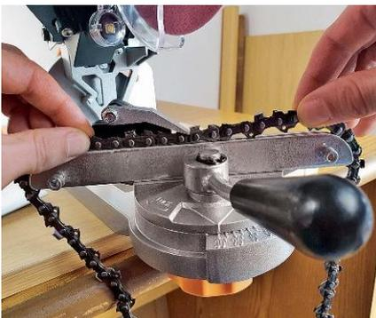
Die Kette wird in die **Führung eingelegt** und der Winkel der Grundplatte unten eingestellt
