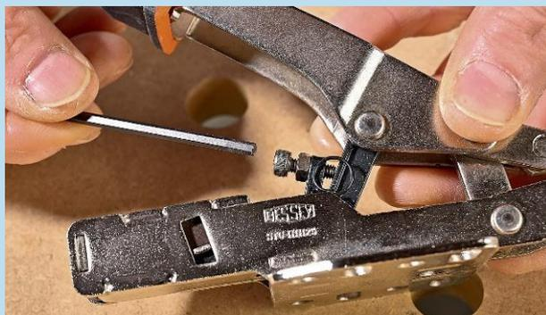
Die Bessey-Kniehebelspanner generieren eine **sehr hohe Klemmkraft**. Dadurch läuft aber auch die Feineinstellung nicht ganz leichtgängig und werkzeuglos
