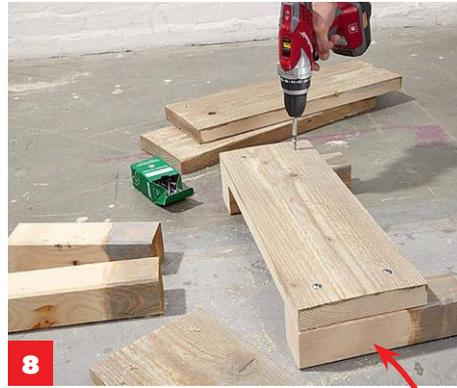
**8** Die Bretter an die Rahmenhölzer **montieren**. Schrauben aus Edelstahl passen gut zur Holzfärbung.
