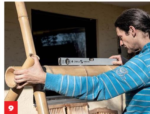
**9** Wenn alle Beine passen, das Querrohr mit der **Wasserwaage ausrichten** und die Beine mit Heißleim heften.
