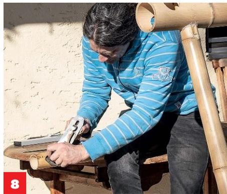
**8** Sollte ein **Bambusknoten** zu breit sein, um durch die Bohrung zu passen, lässt sich dieser **glatt hobeln**.
