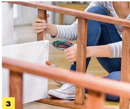
**3** Leitern so auf den Boden legen, dass sie nach oben schräg zulaufen. **Vorbohren, senken, Bretter anschrauben.**
