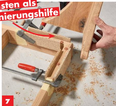
**7** Auf der Unterseite des Rahmens die **Löcher für die Holzdübel** bohren. Dübelmarkierer in die Löcher stecken.
