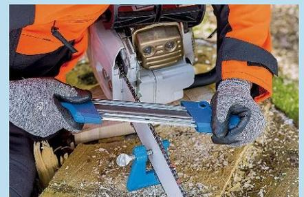
Ein Handschleifgerät (hier: von Pferd, um 25 Euro) benötigt keinen Strom und man kann es überall schnell einsetzen. Die Handhabung ist einfach und es werden gleichzeitig Zähne geschärft und die Tiefenbegrenzer der Kette justiert. Aber man benötigt für jeden Kettentyp eine passende Feilengröße.
