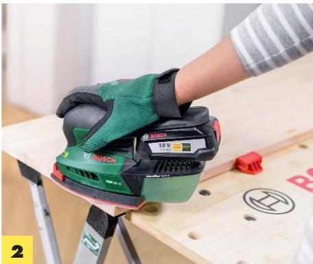
**2** **Flächen glätten**, Kanten brechen. Lack-schicht auftragen, trocknen lassen, mit 240er-Schleifpapier schleifen, lackieren.
