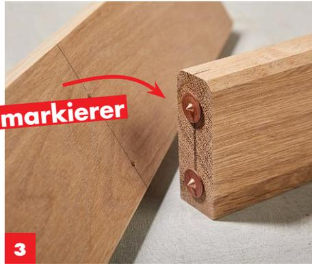
**3** An der **Kopfleiste** die Mitte anzeichnen. Mit den Markierern die Position der Bohrlöcher auf die Linie übertragen.
