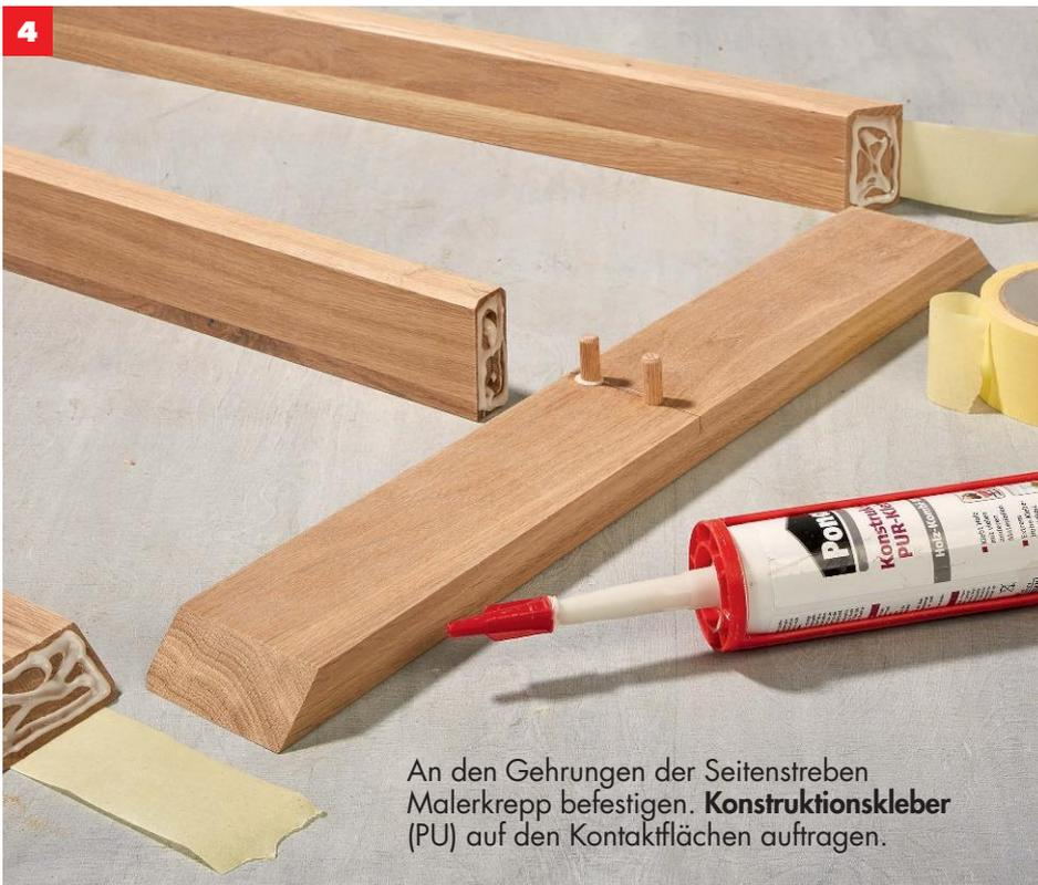
**4** An den Gehrungen der Seitenstreben Malerkrepp befestigen. **Konstruktionskleber** (PU) auf den Kontaktflächen auftragen.
