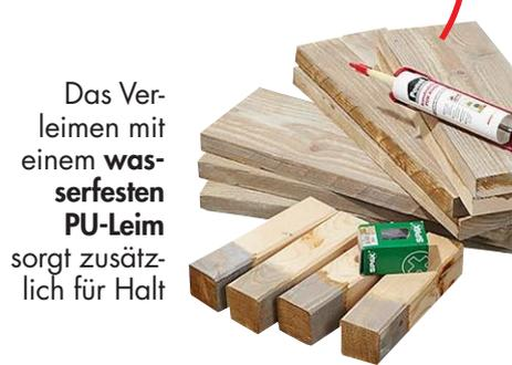
Das Verleimen mit einem **wasserfesten PU-Leim** sorgt zusätzlich für Halt
