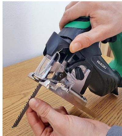
Leichter Wechsel: Der schwarze Kippschalter zum **Sägeblattwechsel** ist in das Gehäuse integriert
