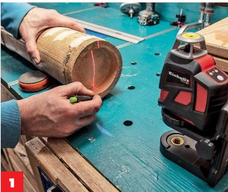
**1** Das Querrohr so ausrichten, dass der **Linienlaser** an den Enden den höchsten Punkt trifft, und die Lotrechte markieren.
