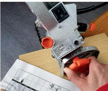
Der **Schleifkopf** wird in den richtigen Winkel gebracht. Die Skala ist etwas grob, hier muss man genau hinsehen
