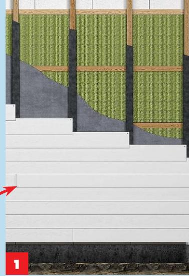
**1** Spezielle Unterspannbahnen verhindern eine Durchfeuchtung der Dämmung und des Holzes.
