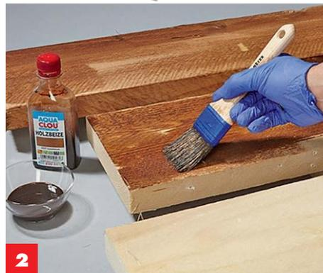
**2** Eine **dunkelbraune Beize** in Laufrichtung der Maserung satt auftragen. Das Holz danach gut durchtrocknen lassen.
