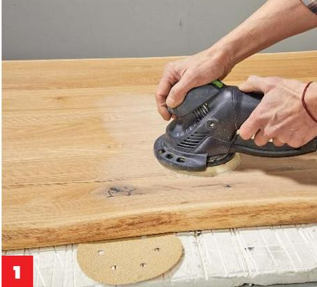
**1** Die vorgeschliffene **Eichenholzplatte** von beiden Seiten mit 100er-, dann mit 120er-Körnung schleifen. Entstauben.
