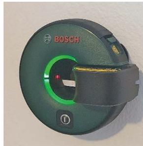
**Grün:** Die Laserlinie ist waagrecht ausgerichtet. Genau so funktioniert auch die senkrechte Ausrichtung nach oben und unten
