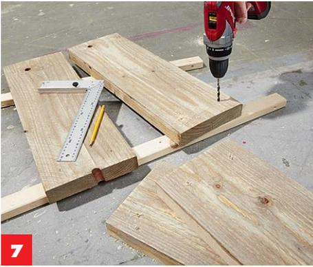
**7** Für die Montage der Seiten 6-mm-Löcher **vorbohren**. Eine untergelegte Holzleiste schon die Arbeitsfläche.
