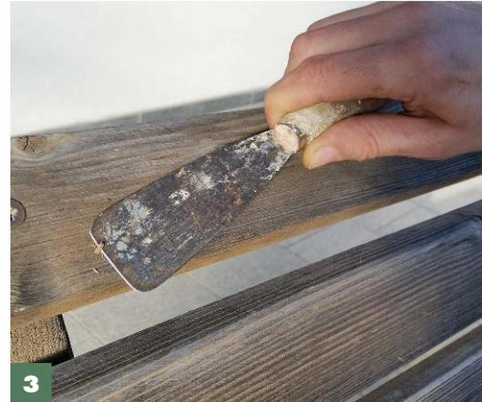
**3** **Grobe Splitter** und lose Teile, beispielsweise an den Stirnseiten der Bretter, zuerst mit der Spachtel entfernen.
