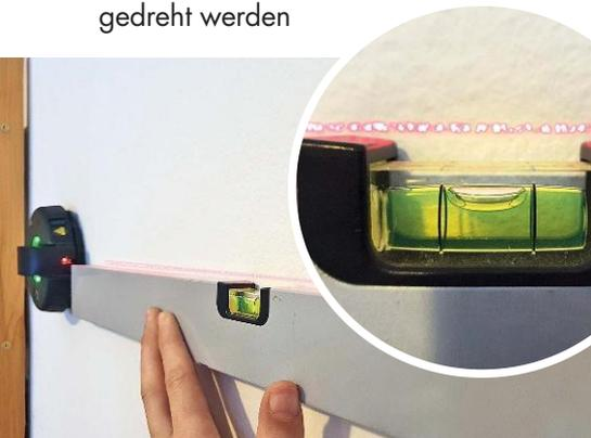
**Kontrolle mit der Wasserwaage:** Der Laser ist hundertprozentig waagrecht, die Ergebnisse werden exakt
