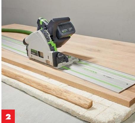
**2** An einer Längsseite die **Baumkante** entfernen (1. Schnitt). Dazu eine Handkreissäge mit Führungsschiene verwenden.
