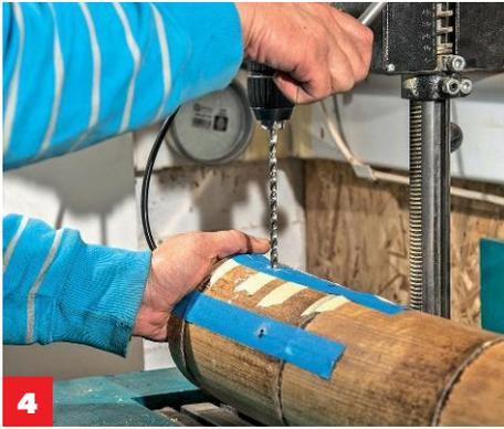
**4** Das Zentrum der Beine anreißern, dann mit einem langen Bohrer **Pilotlöcher** durch das Bambusrohr bohren.
