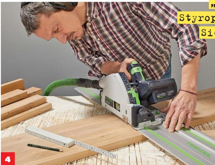
**4** Schneiden Sie die Einzelteile präzise zu. Dabei sollten Sie die **Schnittkanten** zunächst mit 80er- und anschließend mit 100er-Körnung-Schleifpapier sorgfältig brechen und fein schleifen.
