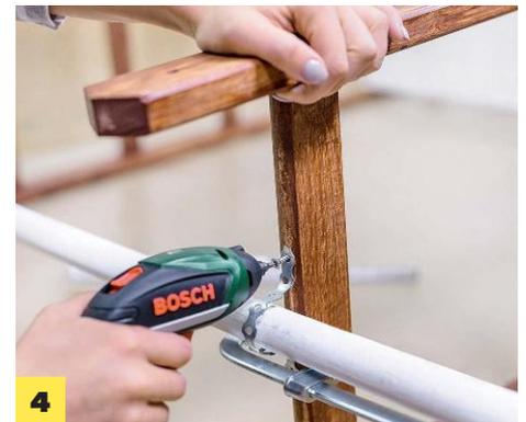
**4** Per Seitenschneider das **Lochband in zwei Hälften teilen**. Die Kleiderstange mit Lochbändern auf der obersten Sprosse fixieren.
