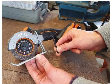
Der verstellbare Schutzbügel dient auch als Schnittführung und wird für Freihandschnitte abgenommen
