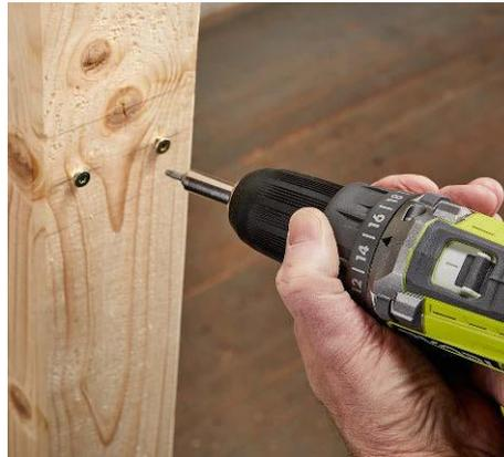
... den voreingestellten Wert erhöhen, bis das passende Drehmoment erreicht ist und der Schraubenkopf sauber abschließt
