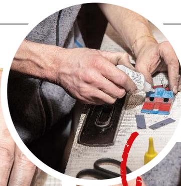
Mit Abdeckband und Superkleber wird Schleifpapier unter dem Frosch befestigt
