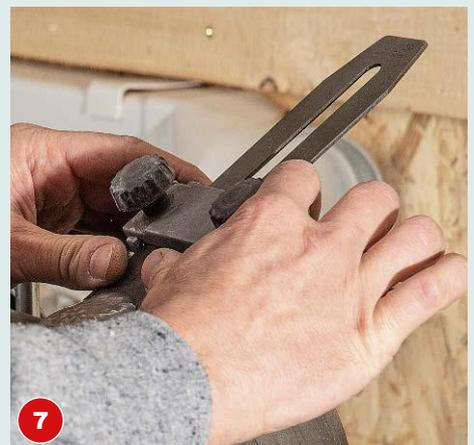
Führen Sie das Eisen zum Schärfen von rechts nach links und üben Sie mit den Daumen Druck auf die Außenseiten aus.
