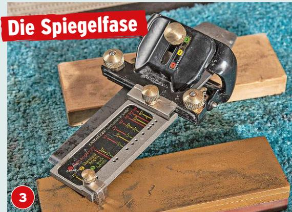
Mit der Spiegelseite nach unten wird das Eisen in die Schärffhilfe eingespannt. Den flachsten möglichen Winkel von 5° einstellen.
