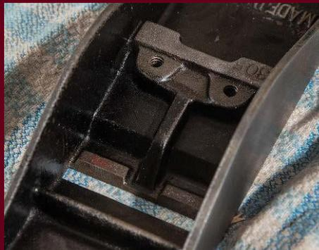
Im Hobelbett wurden die Kontaktflächen zum Frosch nicht plan geätzt - hier ist der Grauguss leicht ballig.
