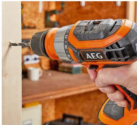
Gangstufe 2: Die höhere Geschwindigkeit eignet sich für das Bohren mit kleinen und mittelgroßen Holz- und HSS-Bohrern
