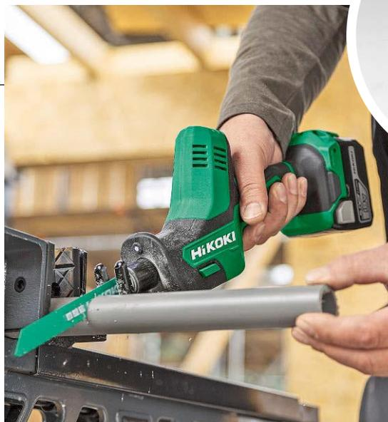
Die Schnittgeschwindigkeit stellt man mit einem Gashebeschalter materialgerecht ein
