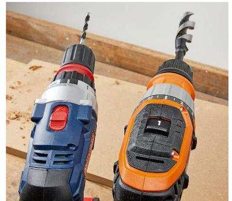
Regel beim Bohren: kleiner Bohrer mit hoher Geschwindigkeit (Stufe 2), großer Bohrer mit geringer Geschwindigkeit (1)
