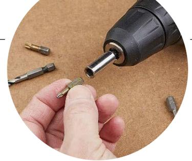
Ein magnetischer Bithalter ermöglicht den schnellen Wechsel der Einsätze
