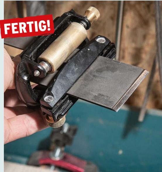
Eine leicht konvex angeschliffene Mikrofase reduziert beim Hobeln die Gefahr eines Verkantens der Schneide im Holz.
