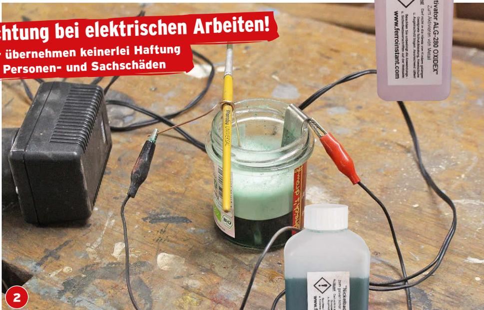
Nach der Behandlung mit dem Aktivator machen wir uns ans Vernickeln des Werkstücks: Hierfür brauchen wir eine 10-V-Stromquelle (Gleichstrom), ein Gefäß und eine Nickel-Anode. Wie das genau geht, lesen Sie im Kasten auf Seite 47.
