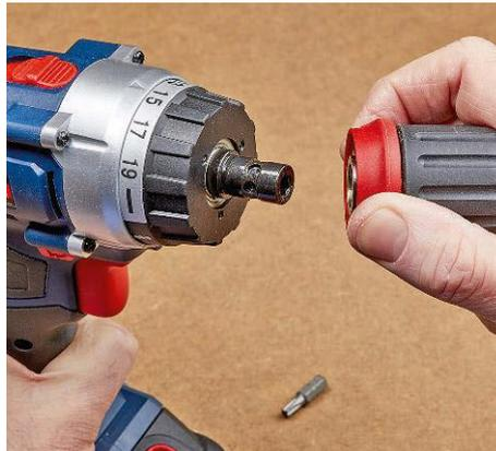
Den ringförmigen Verschluss am Bohrfutter durch Ziehen nach vorne entriegeln, das Bohrfutter entfernen. Den Bit kann ...
