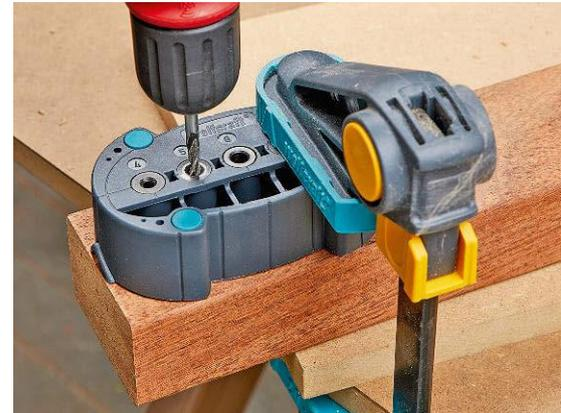
Lotrechtes Bohren ist frei Hand kaum zu erreichen. Hilfe bietet eine Bohrlehre für Bohrdurchmesser bis 10 mm (Wolfcraft)
