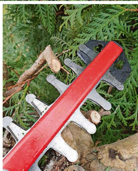
Das Gerät schneidet Zweige bis 1,8 cm Durchmesser. Der Messerschutz vorne hat Aufhängeösen
