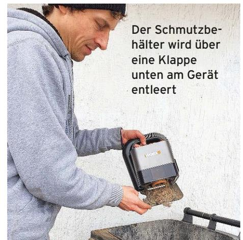
Der Schmutzbehälter wird über eine Klappe unten am Gerät entleert
