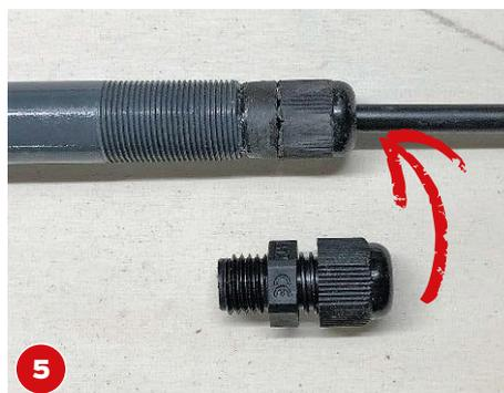
5 Das Kabel führen wir durch den Kanal der zusammenschraubten Lampe. Am Ende kleben wir einen Zugentlaster an.
