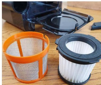
Der Staubfangbehälter enthält Vorfilter und Faltenfilter. Das Entnehmen und die Reinigung sind umständlich.
