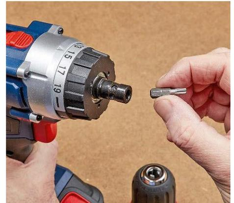
... man jetzt direkt aufstecken. Vorteile: kompakterer Schrauber, reduziertes Gerätegewicht, gute Sicht auf Einsatzstelle
