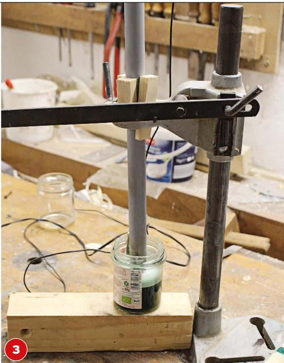
3 Auch der Aufnahmering am Stab des Dreibeins wird vernickelt. Dafür fixieren wir das Dreibein kopfüber am Bohrständler. Nach dem Vernickeln abspülen.
