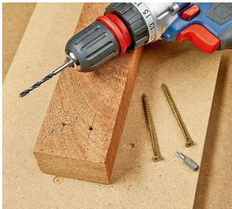
Schrauben in Hartholz kann Bohrschrauber überfordern. Ein Vorbohren mit einem Holzbohrer schont Gerät und Werkstück
