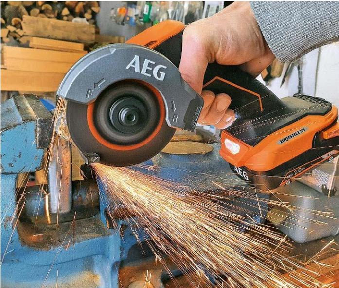
Kompakt, leicht und mit einer Hand bedienbar: Der AEG-Trennschleifer wiegt mit 2-Ah-Akku nur 1,2 kg
