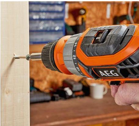
Gangstufe 1: Der Bohrschrauber bietet beim Anfahren das höchste Drehmoment – ideal für das Arbeiten mit Schrauberbits
