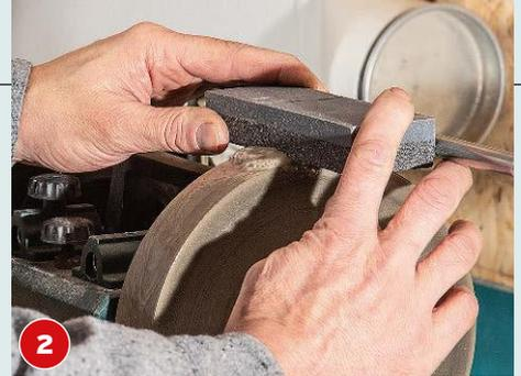
Der Stein wird bei Bedarf abgerichtet. Das Glätten reinigt den Stein und verhindert so, dass sich Scharten einschleifen.
