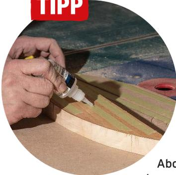
Abdeckband auf Schablone und Werkstück, dann mit Sekundenkleber fixieren
