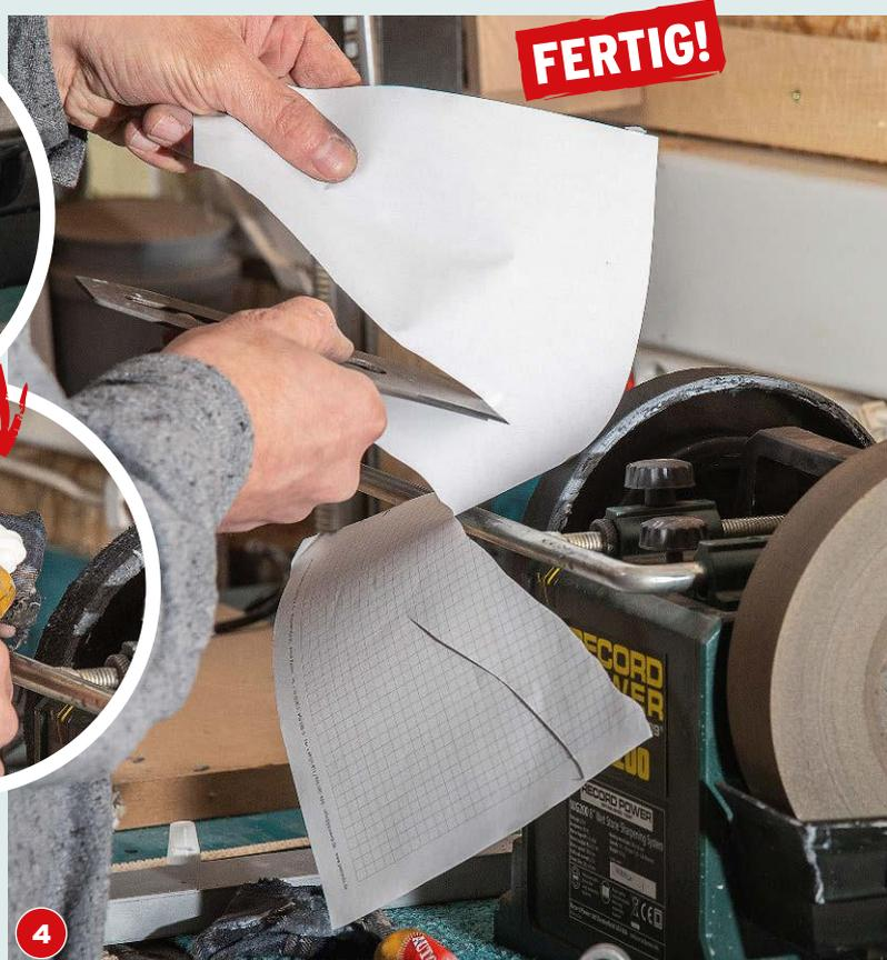
Das so behandelte Eisen ist bereits rasiermesserscharf und kann verwendet werden. Doch da geht noch viel mehr!
