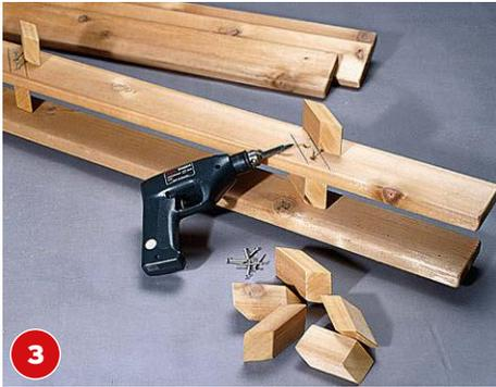
**3** Die Schraublöcher vorbohren und ansenken. Die Teile auf den Boden legen, denn das erleichtert die Montage.
