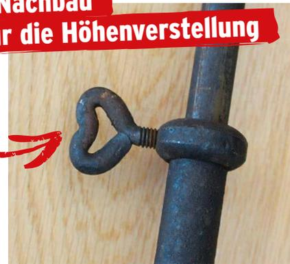
An die Stelle der herzförmigen Feststellschraube am Stab soll die zugeschleifene Fenstervorreibe kommen
