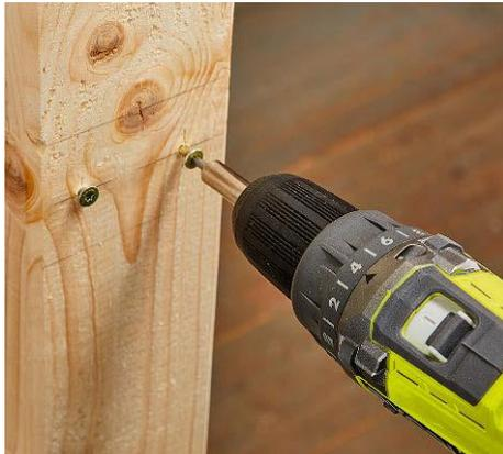
Für flächenbündiges Einbringen von Schrauben mit niedriger Einstellung der Drehmomentvorwahl starten und ...
