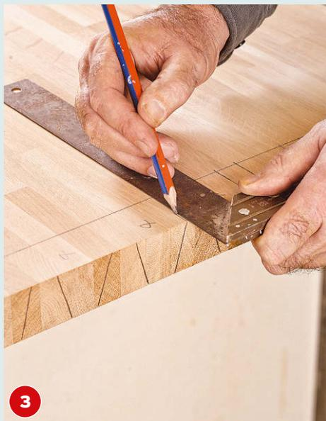
3 Nun die Schnitttiefe anzeichnen, den Riss auf die Frontseite übertragen und auf der Verschnittseite der Linien sägen.
