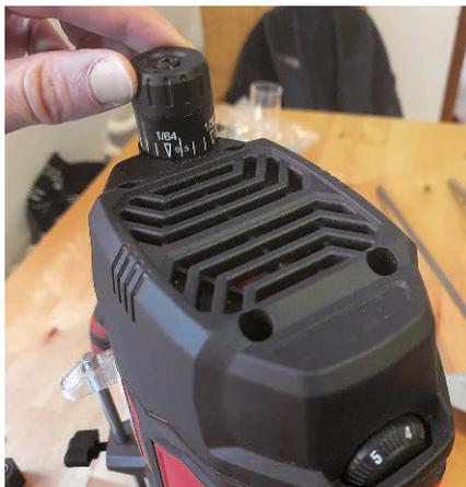
Oben am Gerät wird die Tiefeneinstellung fein justiert. Die Drehzahl ist regulierbar bis 28.000 min<sup>-1</sup>
