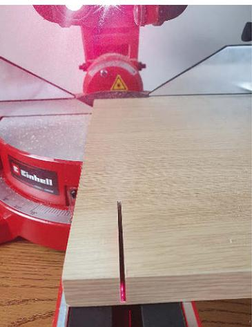
Laser und Arbeitslicht unterstützen den Heimwerker bei präzisen Schnitten
