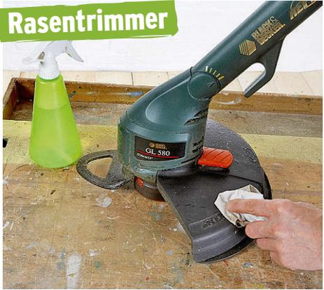
Reinigen Sie alle beweglichen Teile und schmieren Sie alle Metallteile mit Sprühöl.
