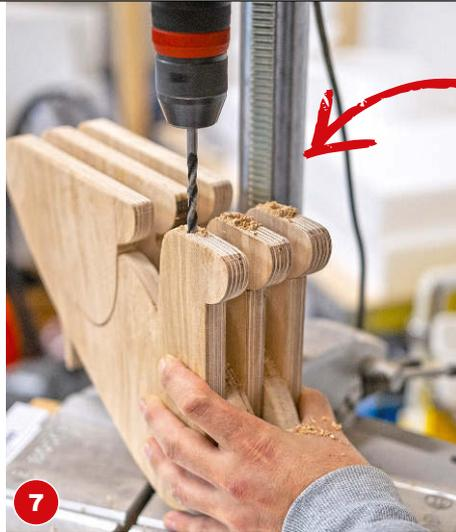
**7** Löcher übertragen und bohren. Leim in die Bohrlöcher und auf Klebeflächen geben, die Dübel einstecken und aufstecken.
