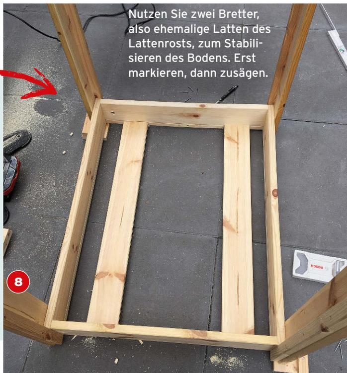
Nutzen Sie zwei Bretter, also ehemalige Latten des Lattenrosts, zum Stabilisieren des Bodens. Erst markieren, dann zusägen.
