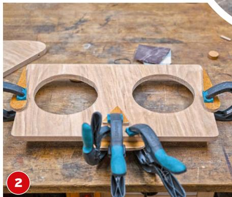
**2** Die Einzelteile mit Holzleim auf dem Kopfteil platzieren, mit Klemmzwingen andrücken, den Leim trocknen lassen.
