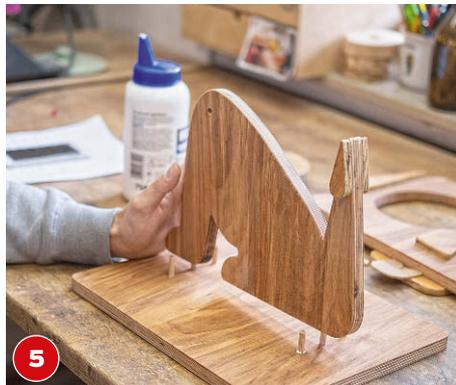
**5** Die drei eingelassenen Körperteile mit Holzleim einstreichen, auf die Dübel der Bodenplatte setzen und aufdrücken.
