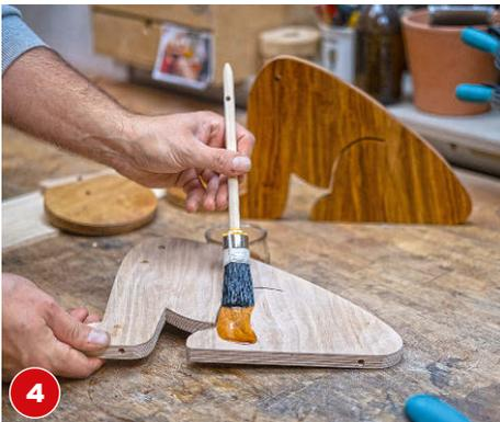
**4** Alle Teile mit einem Pinsel oder Lappen und Holzöl behandeln, die Klebeflächen auslassen. Schützt vor Feuchtigkeit.
