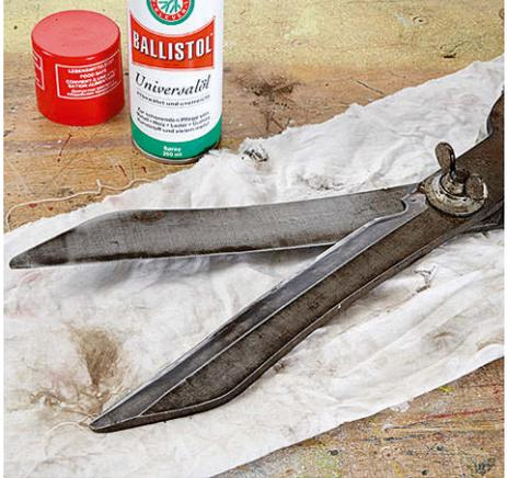
Zum Abschluss der Wartung die Schneiden und das Gelenk mit Sprühöl konservieren.
