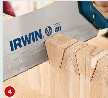
4 Mit einer Japansäge sägen Sie nun die Schwalbenschwänze auf der Seite der Markierung, die der Nut zugewandt ist.
