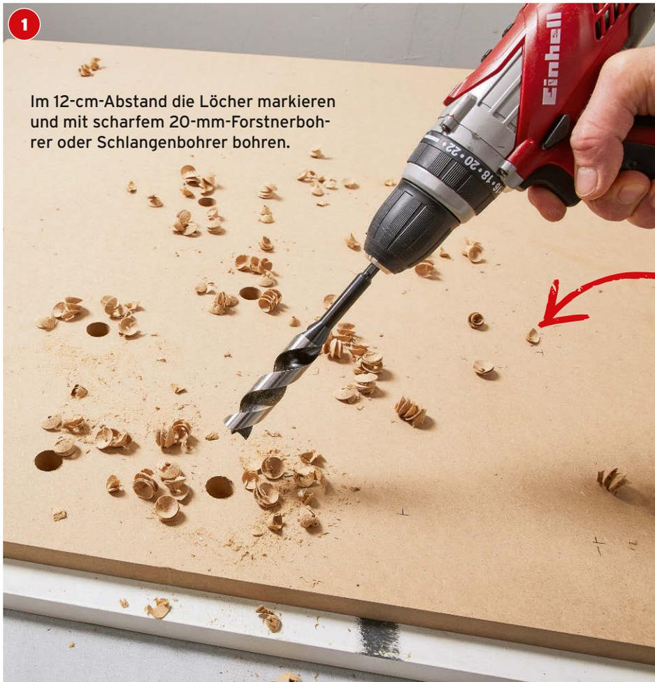
Im 12-cm-Abstand die Löcher markieren und mit scharfem 20-mm-Forstnerbohrer oder Schlangenbohrer bohren.
