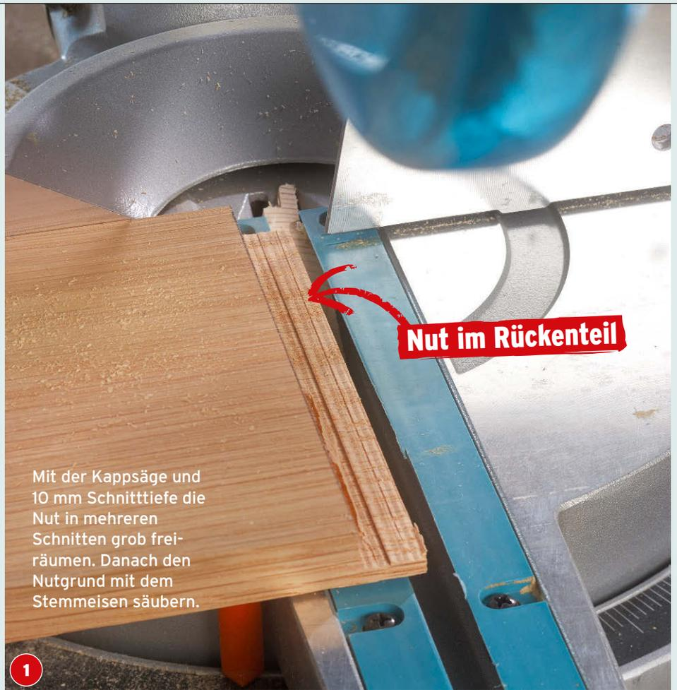
Mit der Kappsäge und 10 mm Schnitttiefe die Nut in mehreren Schnitten grob freiräumen. Danach den Nutgrund mit dem Stemmeisen säubern.
