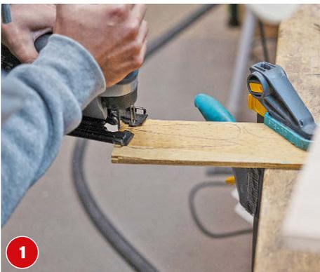
**1** Die Schlappohren, Nase und Mund auf Sperrholz anzeichnen, mit der Stichsäge aussägen und die Kanten schleifen.
