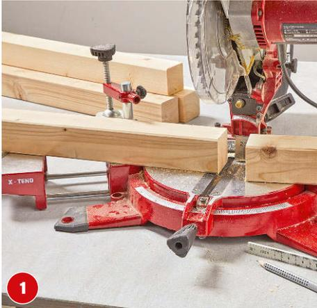
**1** Alle Holzelemente mit der Kappsäge ablängen. Die Maße entnehmen Sie Zeichnung und Projektliste (Seite 24 und 28).
