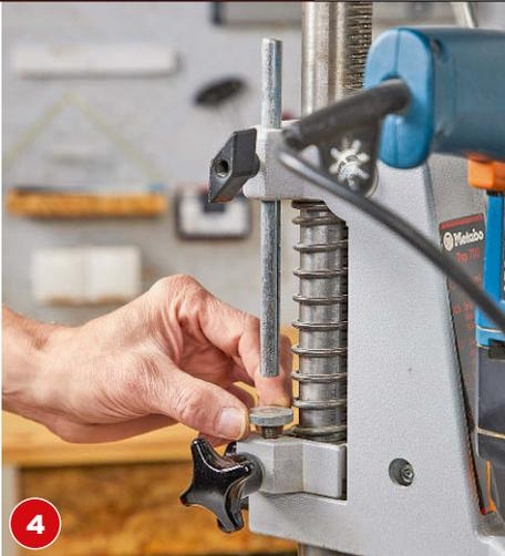
**4** Die Nut für die Führungszapfen soll 4 mm tief werden. Dazu die Bohrtiefe am Bohr­ ständer auf 4 mm einstellen.
