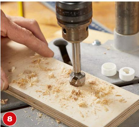
**8** Die Löcher der Aufhängungen an der Rückseite des Brettes mit einem 20-mm-Forstnerbohrer 12 mm tief bohren.
