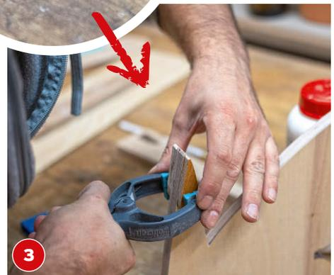
**3** Die ausgeschnittenen, abgeschliffenen Teile ebenfalls mit Holzleim und Klemmzwingen fixieren und trocknen lassen.
