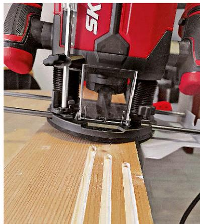
Ergebniskontrolle: Die Nuten sind sauber gefräst, die Geräteeinstellungen sind ziemlich präzise
