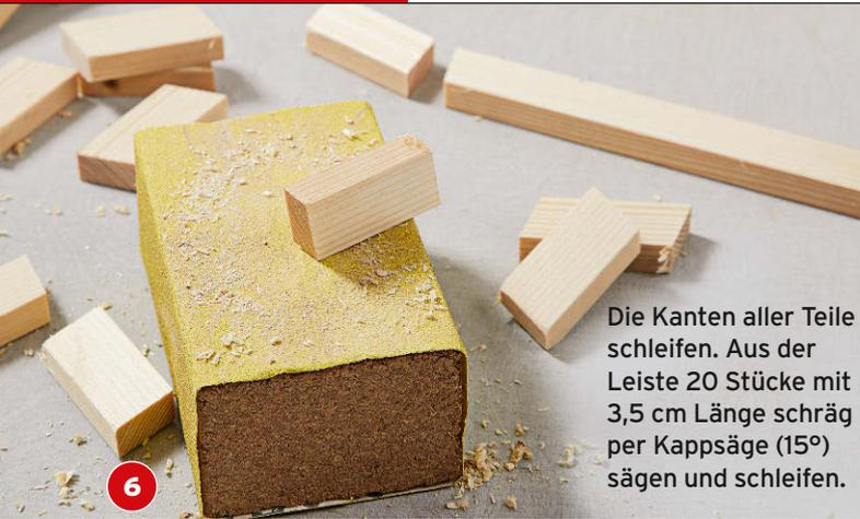
Die Kanten aller Teile schleifen. Aus der Leiste 20 Stücke mit 3,5 cm Länge schräg per Kappsäge (15°) sägen und schleifen.
