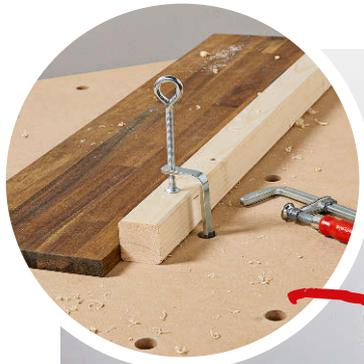
Mit speziellem MfT- (Multifunktions)-Zubehör kann man Werkstücke und Anschläge fixieren
