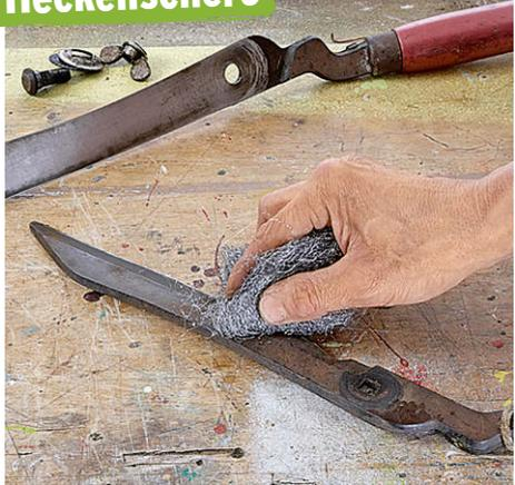
Eine Demontage erleichtert die Wartung und reduziert die Verletzungsgefahr.
