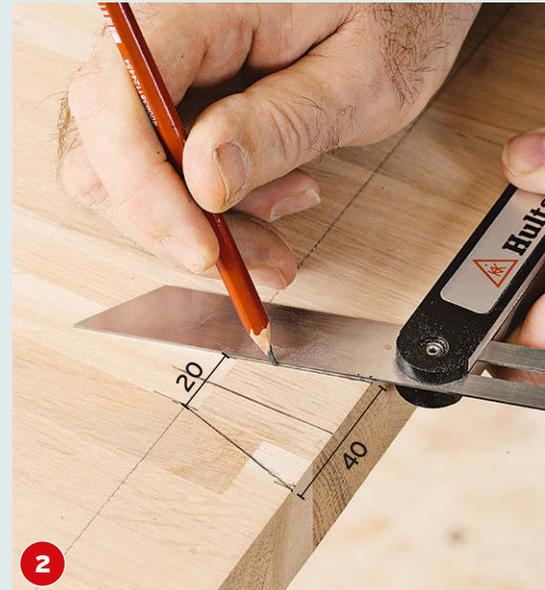
2 Von der Brettmittle ausgehend, werden nun die Schwalbenschwänze in beide Richtungen bis zur Brettseite markiert.
