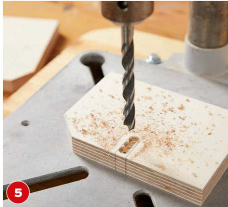
**5** An den Trenn- und Seitenwänden mit dem 8-mm-Bohrer innerhalb der Markie­ rungen die Nut 4 mm tief ausbohren.
