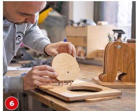
**6** Die Löcher bohren, die Dübel einleimen und in die Löcher setzen. So verbinden wir gleich Kopf und Körper miteinander.
