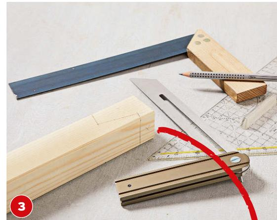
**3** ... mit Gehrungslade und Winkel eine Aussparung anzeichnen. An der oberen Seite der Beine die Mitte markieren, ...
