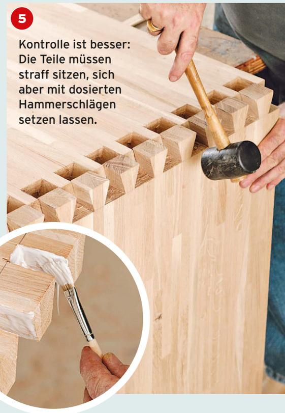
5 Kontrolle ist besser: Die Teile müssen straff sitzen, sich aber mit dosierten Hammerschlägen setzen lassen.
