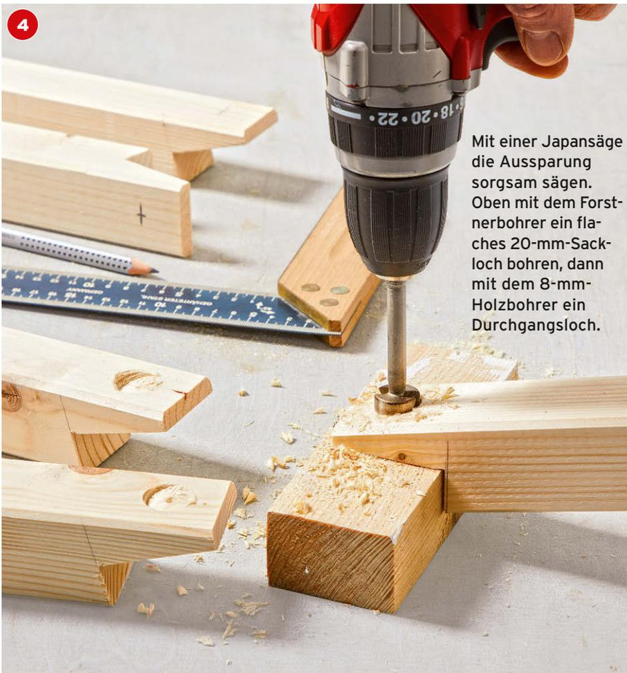
**4** Mit einer Japansäge die Aussparung sorgsam sägen. Oben mit dem Forstnerbohrer ein flaches 20-mm-Sackloch bohren, dann mit dem 8-mm-Holzbohrer ein Durchgangsloch.
