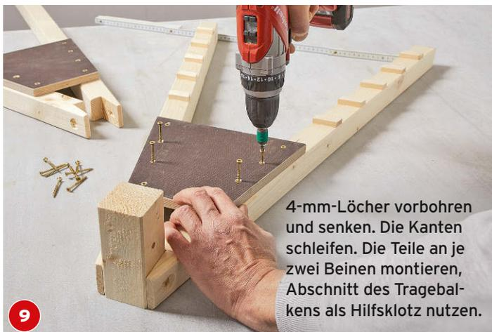
4-mm-Löcher vorbohren und senken. Die Kanten schleifen. Die Teile an je zwei Beinen montieren, Abschnitt des Tragebalkens als Hilfsklotz nutzen.
