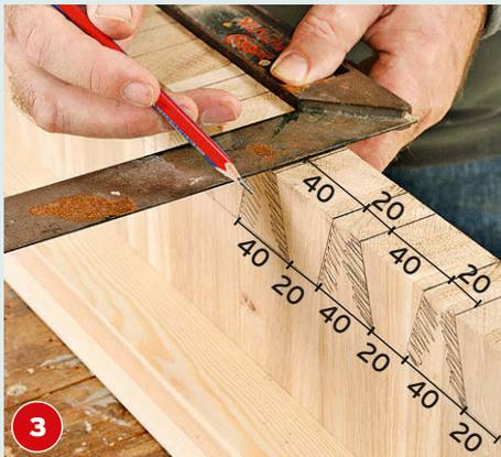
3 Nun die Anrisse über die Brettseite ziehen und die zu entfernenden Bereiche auf der Flach- wie Stirnseite markieren.
