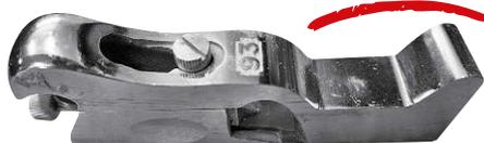
Das Messer des Simshobels ist bündig mit der Hobelöffnung, sodass man gut in die Ecken kommt
