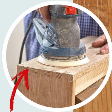
Nach dem Trocknen werden alle Leimreste sowie der Überstand sauber abgeschliffen
