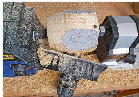
Die Auflage lässt sich in jede Richtung bewegen. Beim Testmodell war die Fixierschraube leider schnell durchgedreht.
