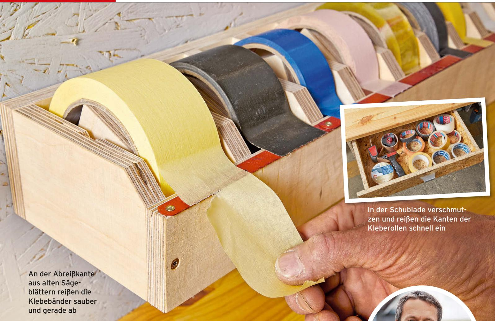
An der Abreißkante aus alten Sägeblättern reißen die Klebebänder sauber und gerade ab
