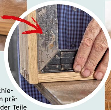
Nach dem Zusammenschieben hilft ein Winkel beim präzisen Ausrichten der Teile
