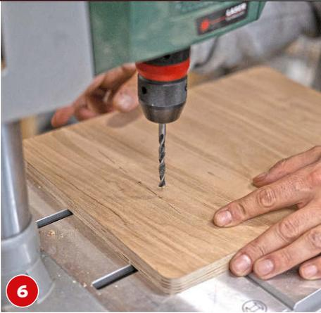
**6** Bohrlöcher auf Bodenplatte anzeichnen: 2 mit je 6 cm Abstand von vorne und hinten auf der Mittellinie der Längsseite. Links und rechts in einer parallelen Linie von 3 cm zur Mittellinie 4 weitere Bohrlöcher markieren und bohren (Tauchtiefe 1 cm).
