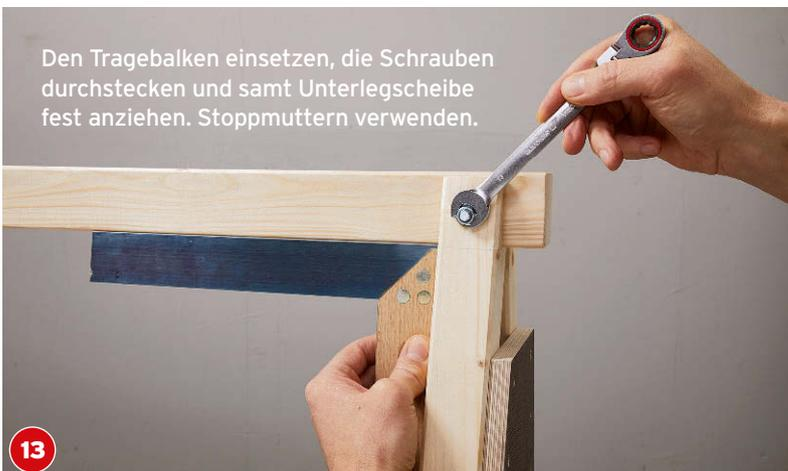
Den Tragebalken einsetzen, die Schrauben durchstecken und samt Unterlegscheibe fest anziehen. Stopmuttern verwenden.
