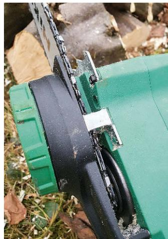
Der Kettenfangbolzen ist bei HiKoki absolut sicher, dieser ist durchgehend von der Abdeckung zum Gehäuse
