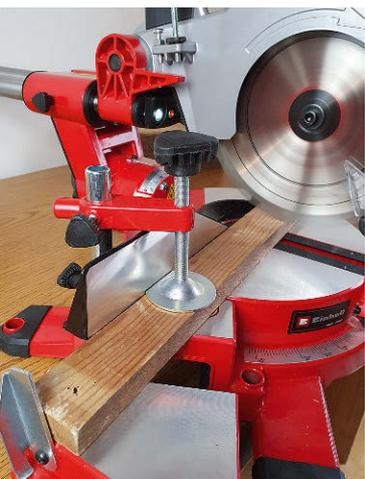
Es gibt eine einfache Spannvorrichtung zur Fixierung des Werkstücks und ausziehbare Auflagen
