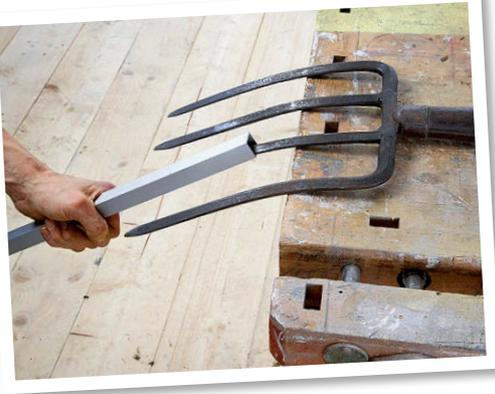
Verbogene Zinken lassen sich mit einem aufgeschobenen Rohr leicht wieder richten.
