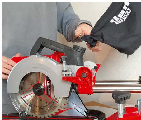
Für Staubfangsack oder Saugschlauch: Der Absauganschluss hat einen Durchmesser von 36 mm
