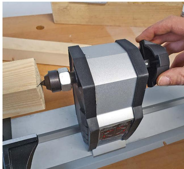
Der Reitstock mit mitlaufender Spindelspitze fixiert das Werkstück. Beim Verschieben klemmte er öfters
