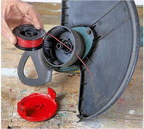
Kontrollieren Sie, ob sich auf der Fadenspule noch genügend Schneiddraht befindet.
