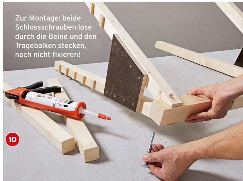
Zur Montage: beide Schlossschrauben lose durch die Beine und den Tragebalken stecken, noch nicht fixieren!
