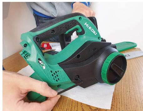
Die Kettenrad-Abdeckung ist hier zusätzlich mit einer Schraube gesichert – das haben nur wenige Modelle.
