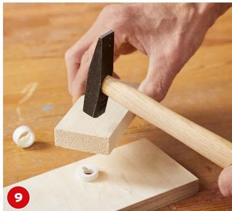
**9** Die Schrank-Aufhängungen in die Löcher einpressen. Dank des Holzstücks kann man die Teile einfach plan einschlagen.
