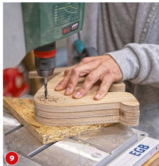
... die Stelle markieren und die Teile gleichzeitig mit der Standbohrmaschine bohren. Die Bohrung dient der Kopfhalterung.
