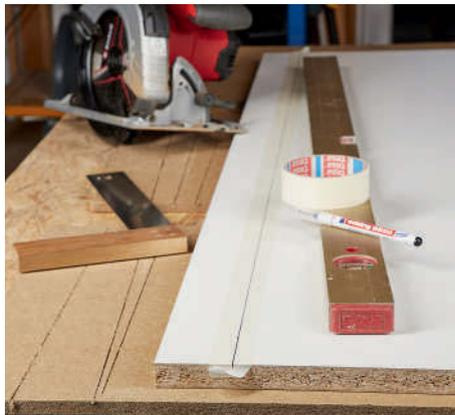
Malerkrepp auf der Schnittlinie bewahrt kunststoffbeschichtete Platten vor größeren Ausrissen an der Sägefuge
