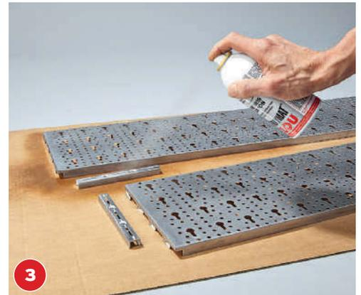
**3** Anschließend besprühen Sie die Oberfläche mit Zaponlack. Wichtig: wegen der Lösemittel gründlich lüften!
