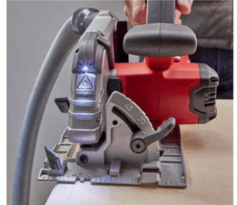
Die Beleuchtung der Sägestelle ist bei Einhell vorbildlich: Die Position des LED-Lichts ist klug gewählt, die Lichtausbeute hoch
