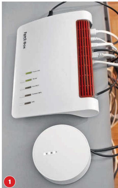
Als Erstes wird das Gateway mit einem LAN-Kabel an den WLAN-Router angeschlossen. So kann es online gehen.
