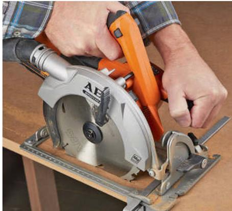
Passt, passt nicht? Die Positionen des Handgriffs mit Sicherheitsschalter und Taster sowie dem Zusatzhandgriff (AEG)
