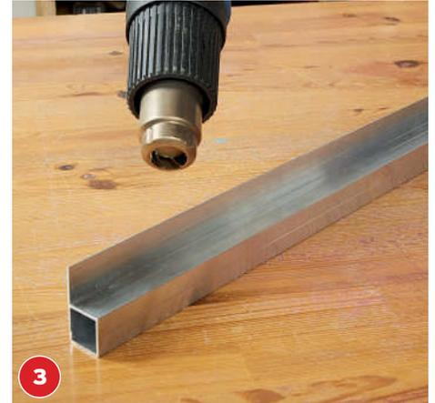
Vor dem Aufkleben das Profil mit Heißluftfön anwärmen. Sonst führt das Alu die Hitze des Bügeleisens zu schnell ab.
