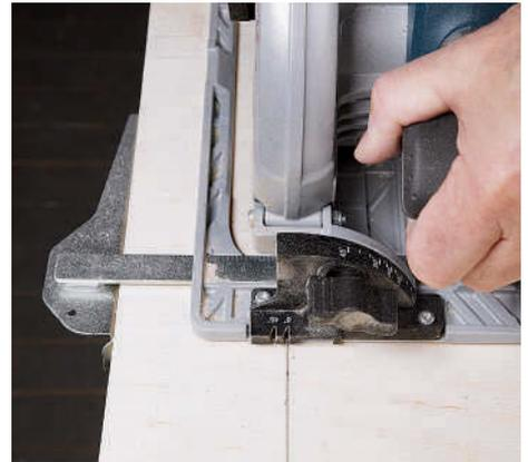
Mit Parallelanschlag: sinnvoll, wenn es nicht auf höchste Präzision ankommt. Die abgetastete Kante muss gerade sein.
