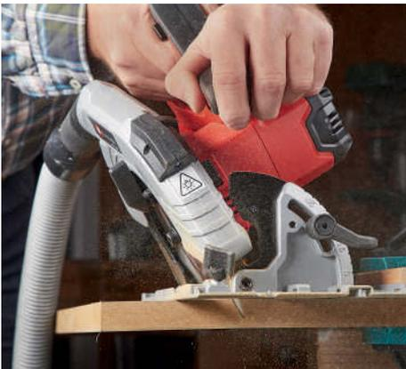
Der Schrägschnitt ist, je nach Gerät, bis mindestens 45° möglich. Die mögliche Schnitttiefe ist beim Sägen geringer.
