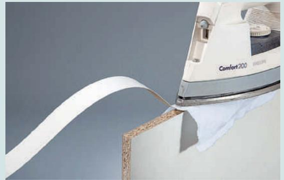
Schnittkanten kann man einfach selbst mit aufgebügelten Kantenumleimern versehen
