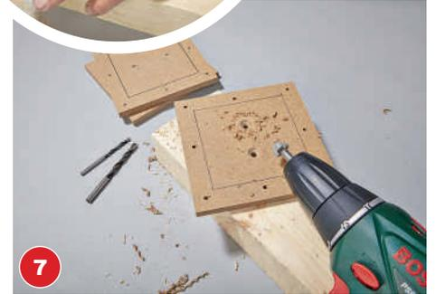
7 Mit einem 6-mm-Bohrer zwei Löcher, dann am markierten Rand 4-mm-Löcher bohren und rückseitig absenken.
