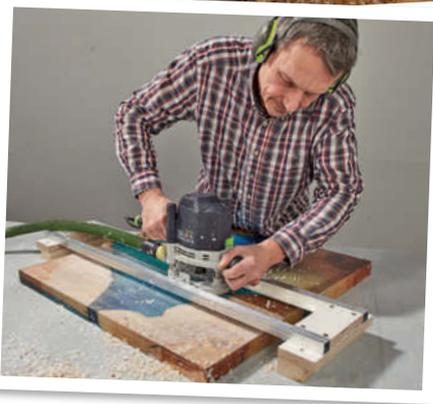
Die Oberfräse trägt das Material gleichmäßig auf die eingestellte Tiefe ab
