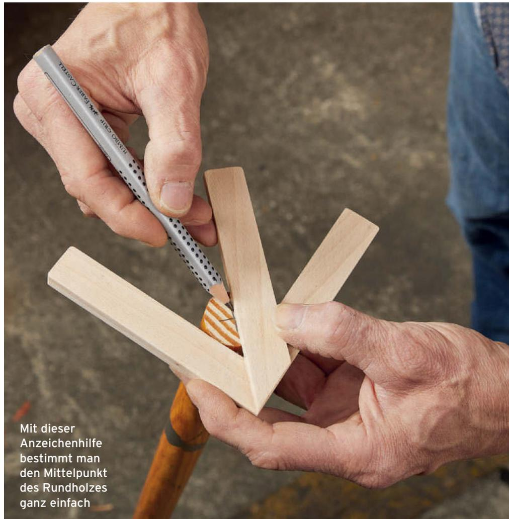
Mit dieser Anzeichenhilfe bestimmt man den Mittelpunkt des Rundholzes ganz einfach
