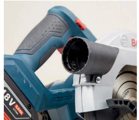
Alle Geräte bieten einen Anschluss für eine Absaugung, eventuelle Kopplungsprobleme lösen Adapter (siehe unten)
