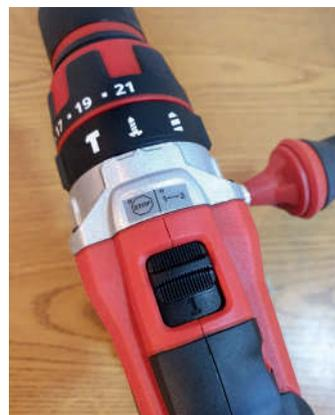
Der Schieber zur Gang-einstellung ist schwergängig, die Ganganzeigen sind nur aufgeklebt
