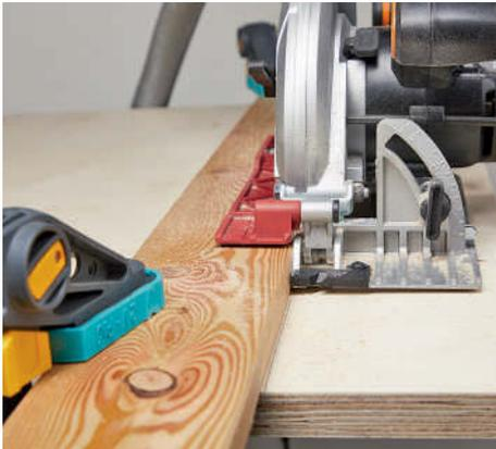
Anzeichnen, Leiste fixieren: Der feststehende Teil des Schlittens wird Anschlag, der bewegliche liegt auf Leiste (Worx)
