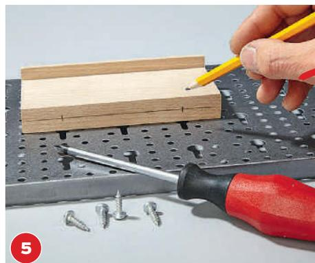
**5** Übertragen Sie die Positionen der Befestigungsschrauben auf die Ablage und schrauben Sie diese bündig ein.
