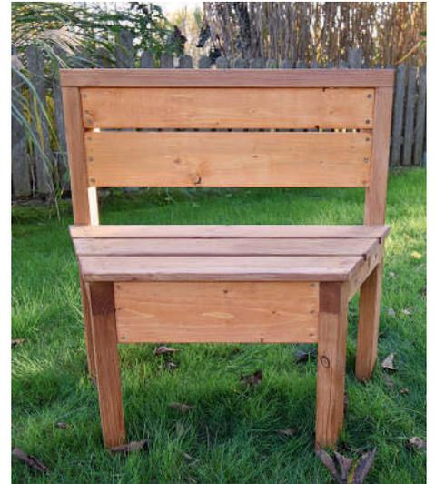
Die Sitzelemente verschraubte er mit M6-Gewindestangen, sodass alle vier FüÙe aufliegen
