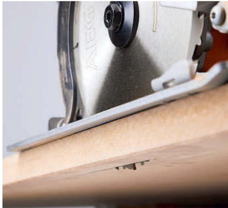
Das Sägeblatt wird in der Tiefe so eingestellt, dass der Sägezahn etwa zur Hälfte aus dem Werkstück hervorlugt
