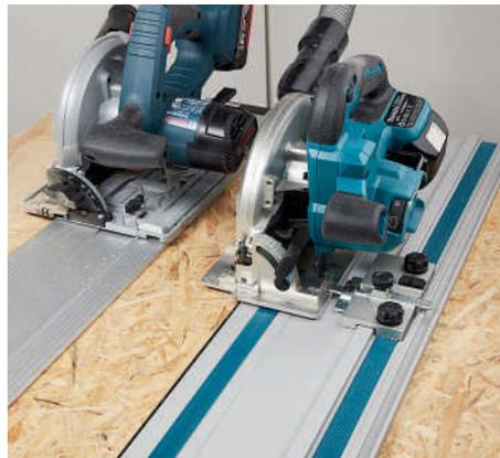
System-Führungsschienen: Die Bosch (links) wird nur aufgesetzt, die Makita benötigt zusätzlich noch einen Adapter
