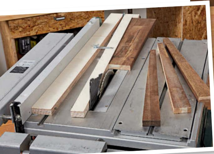
Mit der Schneidhilfe erhalten alle Bretter exakt die gleiche Schräge
