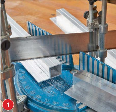
Das Aluprofil mit einer Metallsäge auf die gewünschte Länge (zwei Stück à 700 mm) zuschneiden. Sägegrate entfernen.
