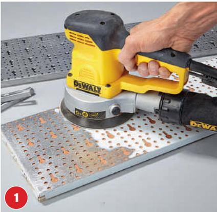
**1** Die pulverbeschichteten Rasterplatten mit dem Exzentrerschleifer (80er-Körnung) blank schleifen.
