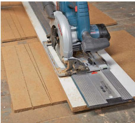
Lose auf dem Boden ausgelegte Weichfaserplatten bewahren den Untergrund vor Beschädigungen durch das Sägeblatt
