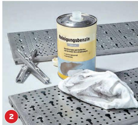
**2** Die blanken Metallteile mit einem Tuch und Reinigungsbenzin sorgfältig entfetten und reinigen.
