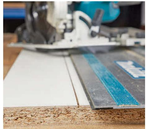
Ein Vorritzen mit nur leicht abgesenktem Blatt und Trennen im zweiten Durchlauf garantiert perfekt geschnittene Kanten
