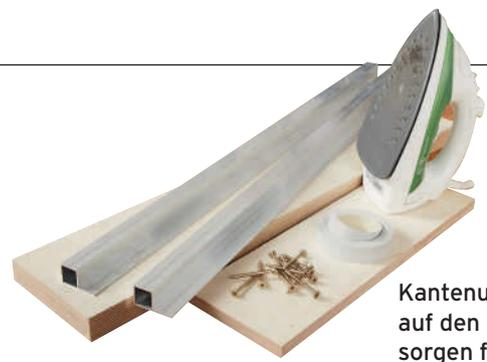
Kantenumleimer auf den Aluprofilen sorgen für glatte Laufflächen
