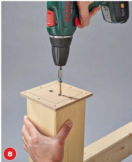
8 Die Montageplatten aus MDF als Verbindung zwischen Tischgestell und Platte mittig auf die Beine schrauben.
