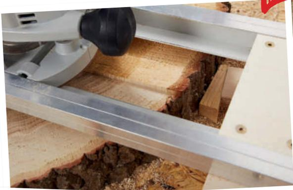
Besonders bei hartem Stirnholz ist die Fräse das ideale Werkzeug für größeren Materialabtrag
