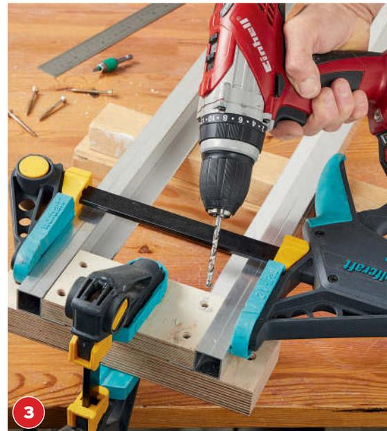
**3** Komponenten fixieren. Löcher durch das Alu bohren. Abstandhalter durch die Profile mit Distanzplatten verschrauben.
