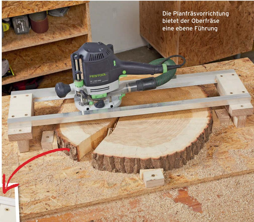
Die Planfräsvorrichtung bietet der Oberfräse eine ebene Führung
