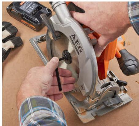
Zum Wechseln des Sägeblatts die Innen-Sechskantschraube lösen. Die Antriebswelle wird mit einem Riegel blockiert
