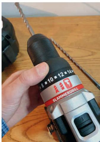
An dem gummierten Rad wird das Drehmoment eingestellt, die Funktion (Schrauben, Bohren, Schlag) dahinter
