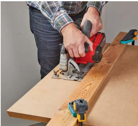
Helfer aus dem Holzvorrat: Eine auf dem Werkstück mit Zwingen fixierte Leiste übernimmt die Führung der Kreissäge
