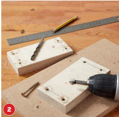
**2** Zwei Abstandhalter (hier: 60 x 130 mm) aus 20 mm starkem Multiplex zusägen. Befestigungslöcher bohren und senken.
