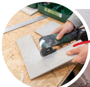
Mit Multitool oder Winkelschleifer mit Diamant-Trennscheibe das Eckstück ausklinken
