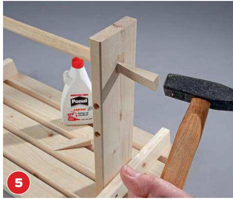
Stabilisierendes Rundholz an der Schnittkante per Feinsäge 2 cm einsägen, einsetzen; mit Leim und Holzkeil verkeilen.
