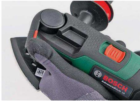
Das **AutoClic-System (Starlock) von Bosch** ist das einfachste und schnellste, wenn es um den Werkzeugwechsel geht. Hierzu den Hebel drücken, das Werkzeug abnehmen, Hebel zurück, neues Werkzeug draufsetzen, klicken und fertig!
