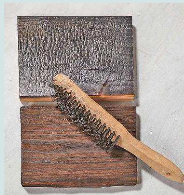
Bearbeitet man das Holz mit einer Messingbürste, entsteht eine strukturierte Oberfläche.
