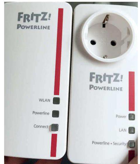
Zwei Powerline-Adapter verbinden sich per Stromkabel wie mit einem Netzwerk-Kabel
