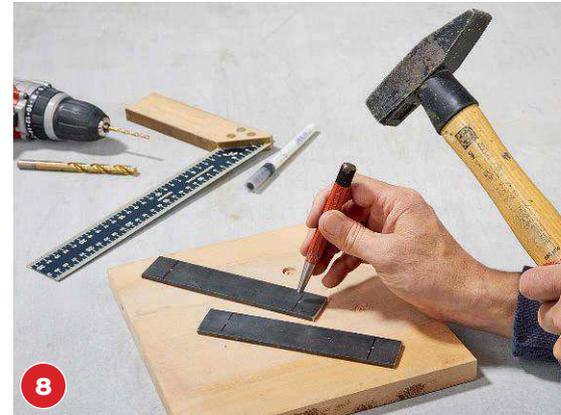
**8** Die Bohrlöcher mittig auf dem Flachstahl anzeichnen (2 cm vom Rand) und mit dem Körner markieren.
