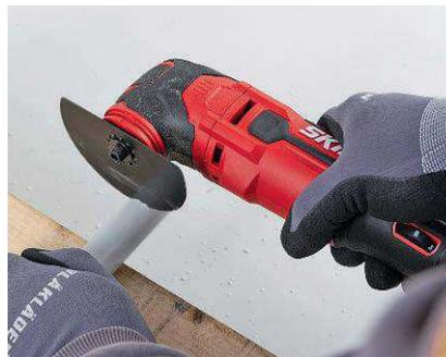
**Arbeitsfortschritt:** Um Rohre lotrecht zu schneiden, sollte man sie gut festhalten oder gar fixieren. Beim Ablängen des Rohrs waren die Multitools richtig schnell: Einhell, Güde, Worx und Skil schafften es in unter zehn, Bosch in unter 20 Sekunden
