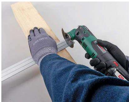
**Arbeitsfortschritt:** Aluminium schneidet man mit hoher Drehzahl, aber nicht zu schnell und nicht mit zu viel Druck. Sonst springt das Gerät am Anfang leicht. Worx, Skil, Einhell lagen unter einer Minute, die anderen unter zwei
