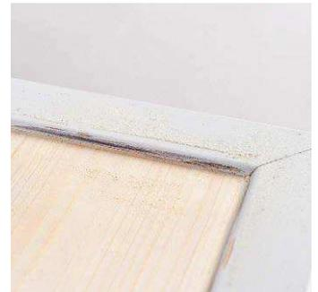
**Schleifbild:** Alle Geräte befreiten die Fläche der Bretter in kurzer Zeit völlig vom Lack. Das Schleifbild in den Ecken erforderte meist etwas Nacharbeit
