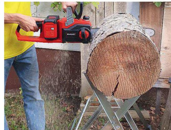
Die maximale Schnittleistung von knapp 35 cm (Fichte) war im Test kein Problem für die Säge
