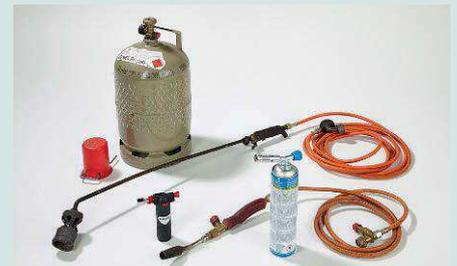
Als Brenngerät eignet sich ein Handlöt-brenner, angeschlossen an eine Gasflasche
