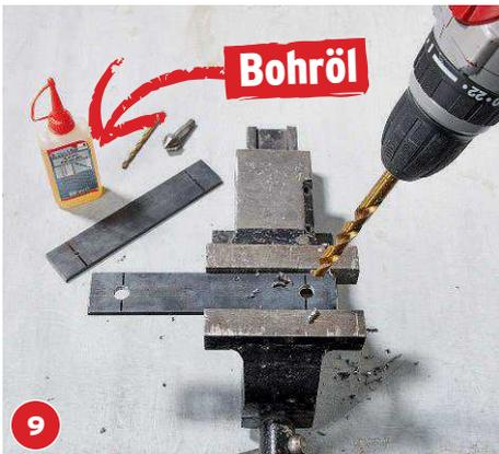
**9** Den Stahl fest einspannen. Mit einem kleinen Metallbohrer die Löcher vor- und mit dem 9-mm-Bohrer nachbohren.
