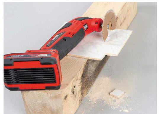
**Schnittergebnis:** Wir präzise und frei von ausgerissenen Stellen sind die Fliesen nach Anwendung des Multitools? Die Ergebnisse waren fast durchweg positiv: Vier Geräte waren „gut“, das Gerät von Güde „befriedigend“
