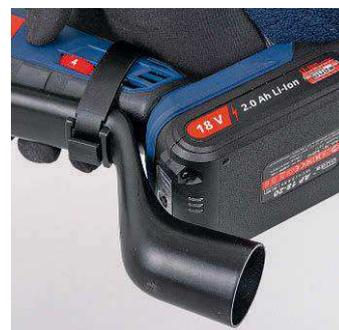
Insbesondere beim Schleifen ist eine **Staubabsaugung** für unkompliziertes, gesundes Arbeiten wichtig. Nur Güde und Skil haben eine Staubabsaugung, bei Bosch und Einhell kann man sie nachrüsten.
