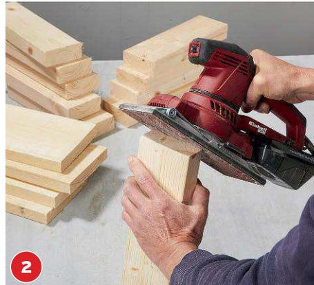
**2** Grobe Sägesplitter an den Kanten mit der Schleifmaschine entfernen. Schleifmittel mit 80er-Körnung verwenden.
