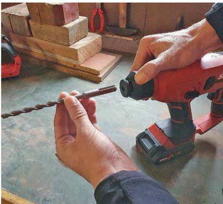
Das Bohrfutter ist für alle SDS-Plus- und Sechskantbohrer geeignet und gut zu bedienen
