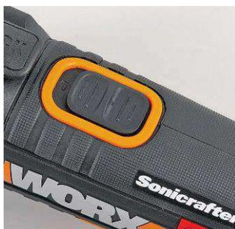
Der **Einschaltknopf** war bei allen Geräten leicht zu betätigen. Beim Werkzeugwechsel sollte man zur eigenen Sicherheit vorher immer den Akku entfernen
