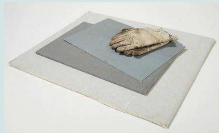
Platten aus Stein, Gipskarton oder Metall sorgen dafür, dass der Arbeitsplatz nicht brennt
