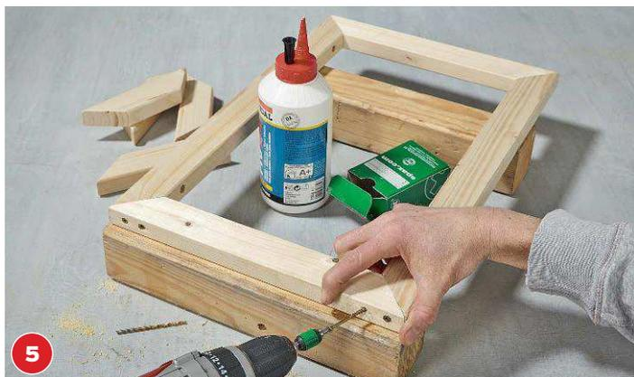
5 Die Rahmenhölzer verleimen und zusätzlich verschrauben. Je Ecke zwei Schrauben schräg von der Seite einsetzen. Die innere Schraube ist länger (4 x 70), die äußere kürzer (4 x 50).
