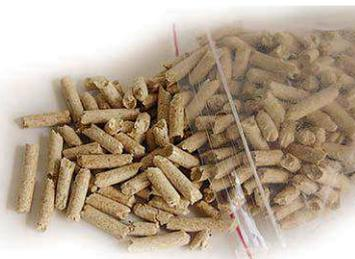
Holzpellets sind hochverdichtete Holzfasern in Wurmform. Zu Pellets werden die unbehandelten Abfälle der Holzverarbeitenden Industrie zerkleinert, mit Bindemitteln (Kartoffelstärke) vermischt und gepresst. Von allen Holzbrennstoffen bieten die Pellets den höchsten Heizwert, Anlieferung und Lagerung sind kein Problem. Verfeuert werden können sie in allen so gekennzeichneten Kaminen und Kaminöfen, allerdings sind die ausgewiesenen Pelletöfen am einfachsten zu handhaben und zu reinigen.
