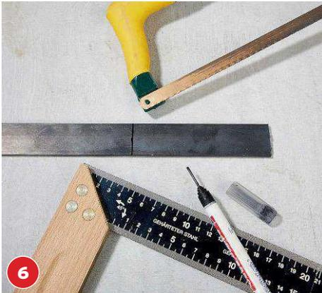
**6** Auf dem Flachstahl zwei Stücke von 16 cm Länge abmessen und mit einem Winkel anzeichnen.
