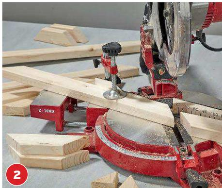
2 Vier Leisten für die Rahmenkonstruktion (500 x 330 mm) zuschneiden. Die Enden mit 45°-Gehrungsschnitten versehen.
