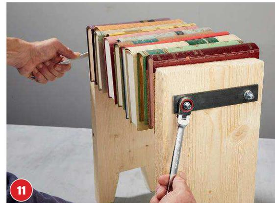
**11** Abschließend mit zwei Schlüsseln rechts und links, die Bücher komprimieren. Das sorgt für die nötige Stabilität.
