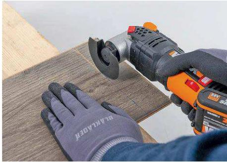
**Ausrisse Ober-/ Unterseite:** Das Laminat haben wir mit maximaler Drehzahl geschnitten. Das beste Ergebnis erzielten Bosch und Skil, danach kamen Worx, Einhell und Güde
