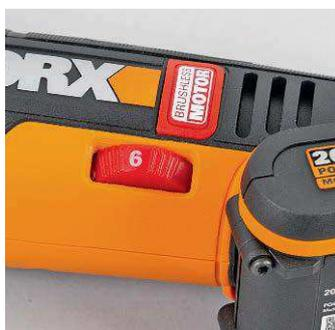
Der **Drehzahlregler** ist wichtig, um die Geschwindigkeit und Intensität der Werkzeuge an das Material anzupassen. Vier Geräte hatten eine Drehzahleinstellung von den Stufen 1 bis 6, Einhell von -1 bis 5.
