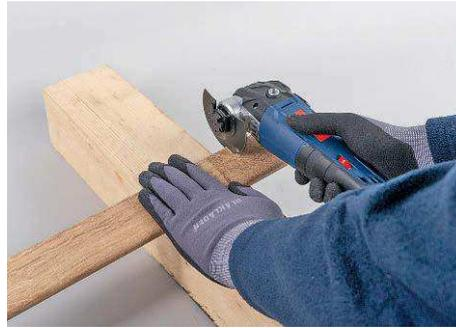
**Spurtreue:** Für einen geraden Schnitt muss man das Werkstück gut und gerade halten. Sehr gute Spurtreue gab es bei Worx, Bosch und Skil, gute Spurtreue bei Einhell und Güde
