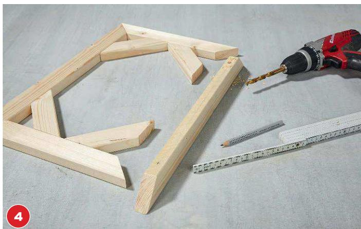
4 An der Unterseite des oberen Rahmenholzes im Abstand von 400 mm zwei Löcher mit je 10 mm Durchmesser bohren. Hier werden später die Haken der Wandbefestigung eingehängt.
