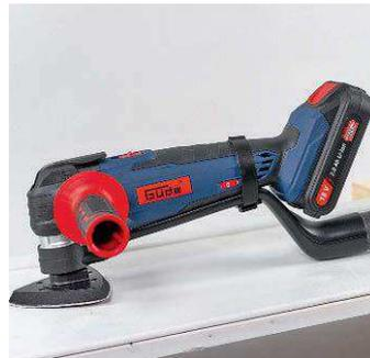
**Staubentwicklung:** Mit Absaugadapter und gelochtem Schleifpapier hält man den Staub gering. Für vier Geräte gab's eine 1, für Bosch eine 2
