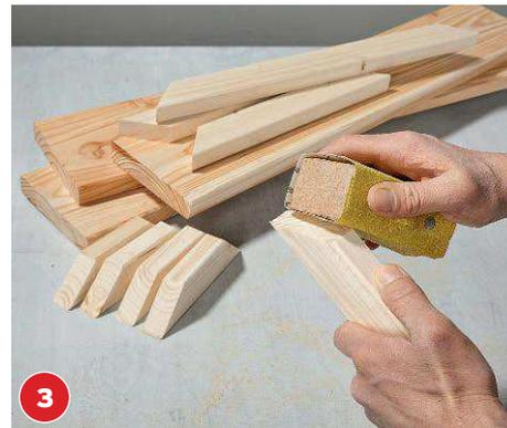
3 Die Eckelemente von 200 mm Länge mit 45°-Gehrungswinkeln versehen. Alle Kanten mit 80er-Schleifpapier brechen.
