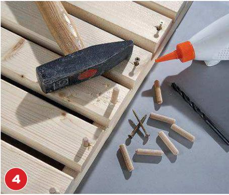
Ist der Leim fest, die Schrauben entfernen. Die entstandenen Löcher mit 6-mm-Bohrer aufbohren und mittels Dübel füllen.
