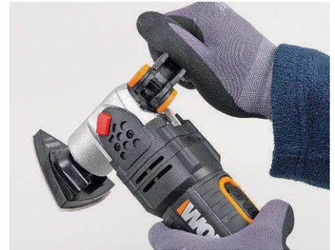
Das **Schnellspannsystem (Worx)**: Hebel hochdrücken, entriegeln, gegen den Uhrzeigersinn aufdrehen, Werkzeug tauschen, festdrehen, Hebel zurück - fertig. Güde: Hebel vor, Aufsatz wechseln, Hebel zurück
