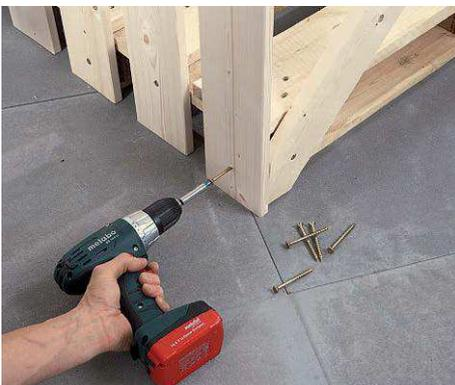
Die Seitenwandbretter mit oberer und mittlerer Querleiste verbinden und dann seitlich an die Palette schrauben.
