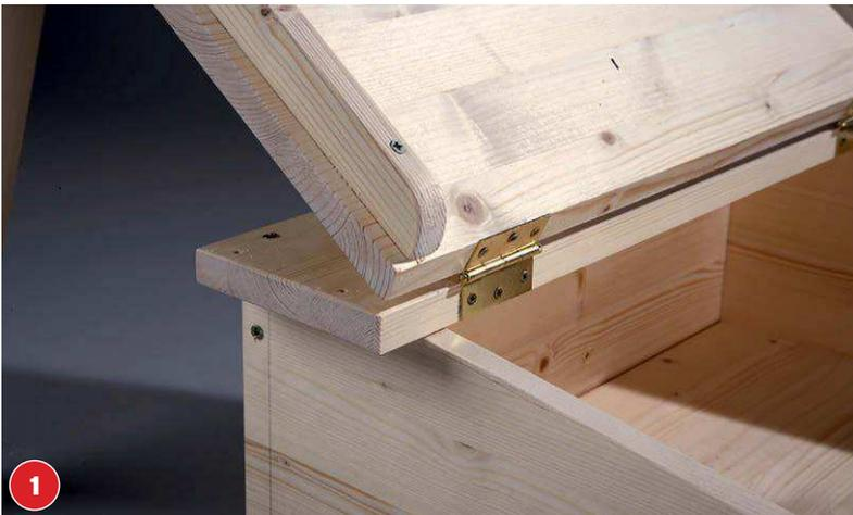
Sind alle Teile zugesägt, abgeschliffen und zusammengefügt, die Schreibplatte mit Anschraubcharnieren an der schmalen Ablage fixieren.
