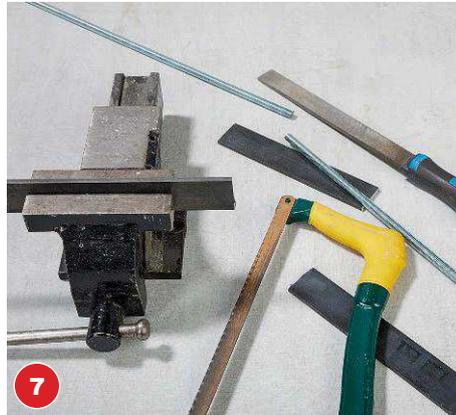
**7** Mit der Eisensäge die Stücke vom Flachstahl abschneiden. Die Gewindestange halbieren und entgraten.
