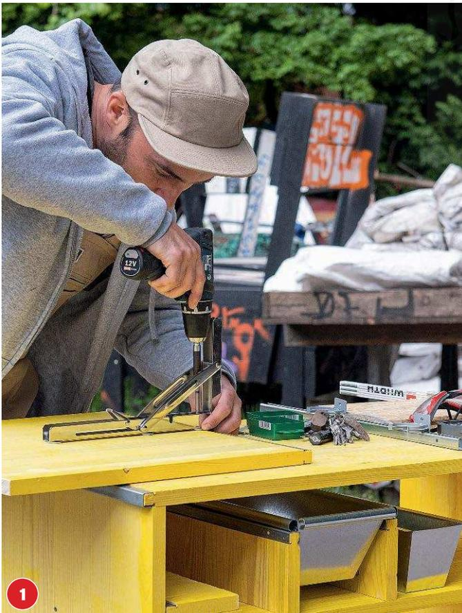
6 cm von den Außenkanten Positionen der Winkel markieren und diese mit 15-mm-Linsenkopf-Schrauben fixieren. Damit die ausklappbare Fläche auf derselben Höhe ist wie die Arbeitsplatte, unter die horizontale Gelenkseite Unterlegscheiben bringen.
