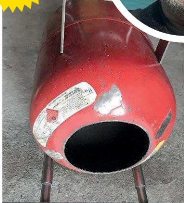
Eine ausrangierte Propangasflasche bietet die ideale Basis für die selbst gebaute Gasesse
