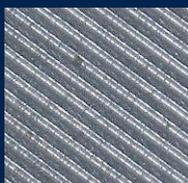
**Einhieb:** Hier gibt es das einfachste Rillennmuster, was aber eine sehr gleichmäßige und glatte Bearbeitung ermöglicht. Die Feile eignet sich am
