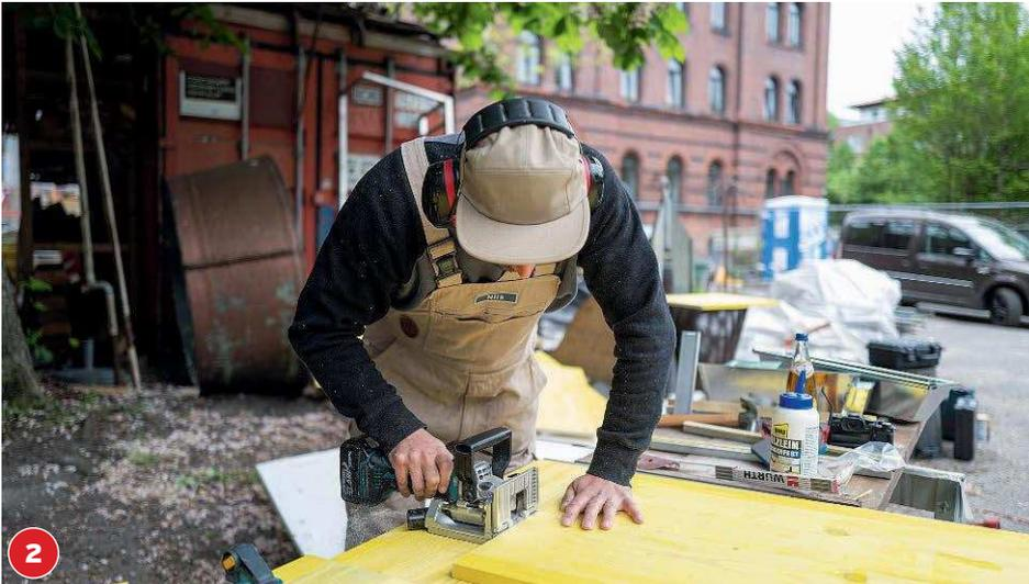
Anschließend zeichnet man die Positionen für die Flachdübel mit einem Abstand von je 10 cm zu den Außenkanten an und stellt mit der Flachdübelfräse Nuten her. Durch die hohe Drehzahl der Fräse entsteht ein sauberes, ausrissfreies FräsBild.
