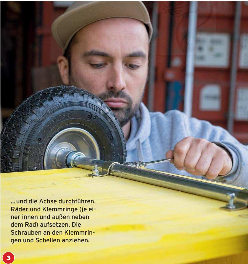
3 ... und die Achse durchführen. Räder und Klemmringe (je einer innen und außen neben dem Rad) aufsetzen. Die Schrauben an den Klemmringen und Schellen anziehen.
