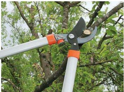
Die Astschere hat eine maximale Schnittstärke von 43 mm. Ab 25 mm wird es anstrengend
