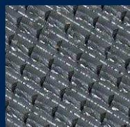
**Kreuzhieb:** Die Hiebart hat einen zusätzlichen Hieb quer zum ersten. Sie entfernt mehr Material und das Muster eignet sich für grobe und mit-
