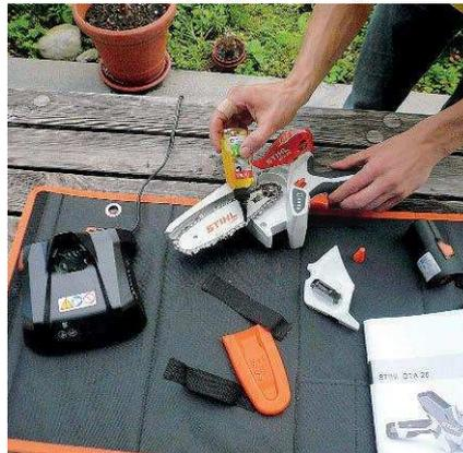
Kettenschmierung: Das Kettenöl muss man direkt auf die Schiene aufbringen
