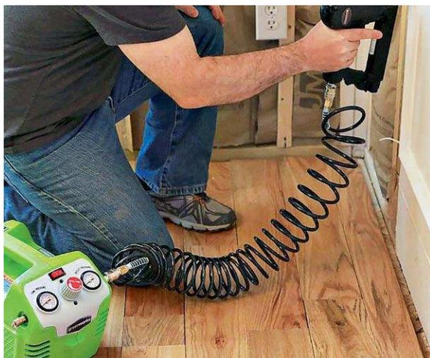
Mit dem 4-Ah-Akku läuft der 40-V-Kompressor bis zu 40 Minuten lang
