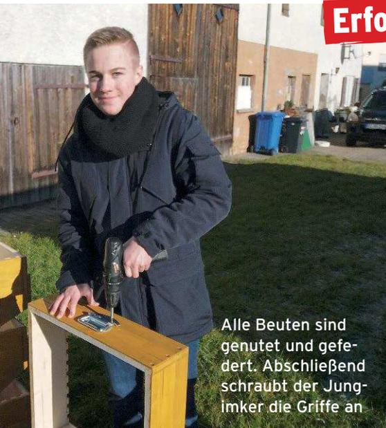
Alle Beuten sind genutet und gefedert. Abschließend schraubt der Jungimker die Griffe an
