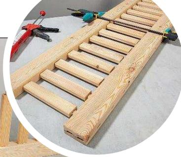
Achten Sie darauf, dass alle Abstände gleich sind (45 mm), sonst ausrichten
