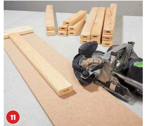
**11** Fräsen Sie die Stirnseiten der 28 zugesägten Sprossen die Löcher für die 5-x-40-mm-Dominodübel. Mit einer Fräshilfe aus einem Brett mit Anschlag geht es leichter.
