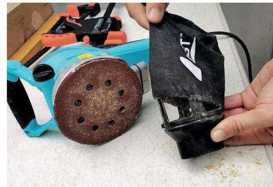
Der Staubfangbeutel besteht nur aus einfachem Stoff. Der Staubsauger passt nicht
