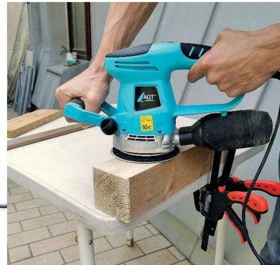
Robust, aber schwer: Der untere Teil des Gehäuses ist aus Metall gefertigt
