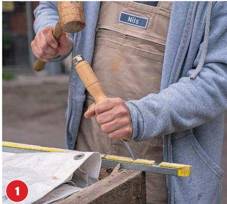
**1** Aus zwei abgeschnittenen Metallleisten mit Hammer und Stemmeisen Holz lösen, sodass Kantenprofile übrig bleiben.
