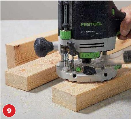
**9** Alle 8,5-x-4,2-cm-Bretter werden nun mit einer Oberfräse und einem Fasenfräser mit Anlaufring an allen Seiten gefast. Die Fase sollte etwa 4 mm breit sein.
