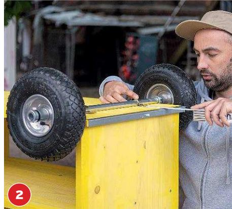
2 10 cm von der Kante Löcher für Schellen vorbohren und ansenken. Schellen locker anschrauben ...
