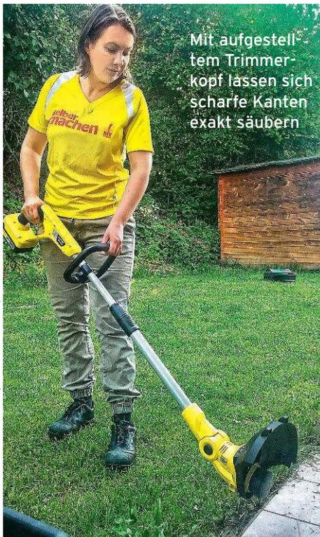
Mit aufgestelltem Trimmerkopf lassen sich scharfe Kanten exakt säubern
