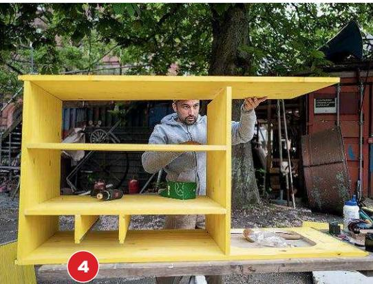
Flachdübel einleimen, Klebeflächen mit Leim einstreichen, Deckplatte wieder aufsetzen und von oben verschrauben.
