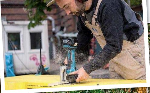
Mit einer Flachdübelfräse werden Nuten für die Flachdübel hergestellt
