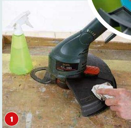
**1** Groben Schmutz abschaben, mit einem feuchten Lappen reinigen. Bei Akkugeräten: Akku unbedingt entfernen.
