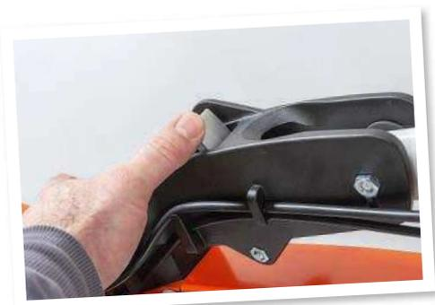
Winkel und Holmlänge werden bei Makita und Einhell an einer Schraube eingestellt
