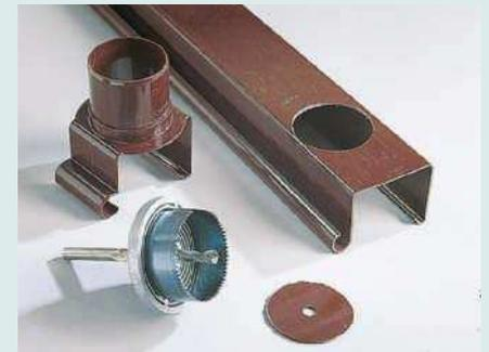
**2** Das Ablaufloch kann mit einer Lochsäge für Holz ausgeschnitten werden. Der Stutzen rastet passgenau ein, sollte aber auch verklebt werden.
