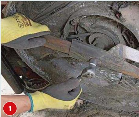
**1** Wenn das Messer stumpf oder schartig geworden ist, muss es ausgebaut werden. Das Mähdeck von unten reinigen.
