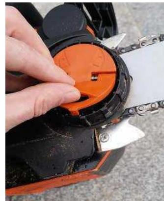
Nerviges Detail: Der Plastik-Drehgriff verklemt sich öfters beim Einklappen
