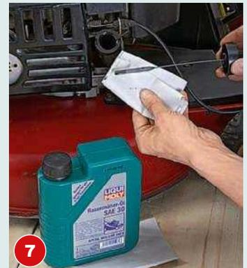
**7** Das Motoröl wechseln: Nutzen Sie spezielles Mäher-Öl (30/40/50er-SAE-Klasse).
