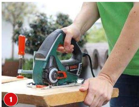
**1** Bestimmen Sie die Länge der Bohle, indem Sie die Leuchtmittel darauf verteilen. Bei Bedarf mit der Stichsäge kürzen.
