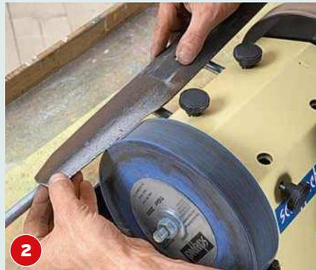
**2** Die Schneiden der Messer nachschleifen. Ungleichmäßiger Schliff führt zu Unwuchten, was man ausgleichen muss.
