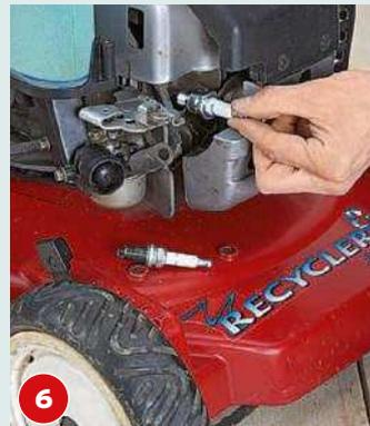
**6** Zündkerze kontrollieren. Bei Bedarf mit Sandpapier reinigen, nicht mit der Drahtbürste.
