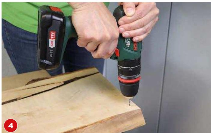
**4** Für das Drahtseilssystem vier Löcher in die Ecken der Bohlen bohren. Mit Schleifgerät und 180er-Schleifpapier schleifen Sie die Bohle in Richtung Holzmaserung an und entstauben sie.
