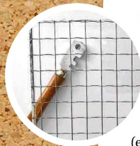
Drahtglas können Sie mit einem herkömmlichen Glasschneider „schneiden“. Besser gesagt wird es angeritzt. Dann wie bei normalem Glas an der Ritzkante brechen (etwas unterlegen oder an der Tischkante). Die Drähte brechen entweder direkt mit ab oder Sie müssen vorsichtig etwas hin und her wackeln. Alternativ können Sie den Draht mit dem Seitenschneider oder dem Winkelschleifer zerteilen.
