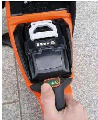
Der Eco-Modus (grüne Taste) reduziert die Leistung bei leichten Sägearbeiten
