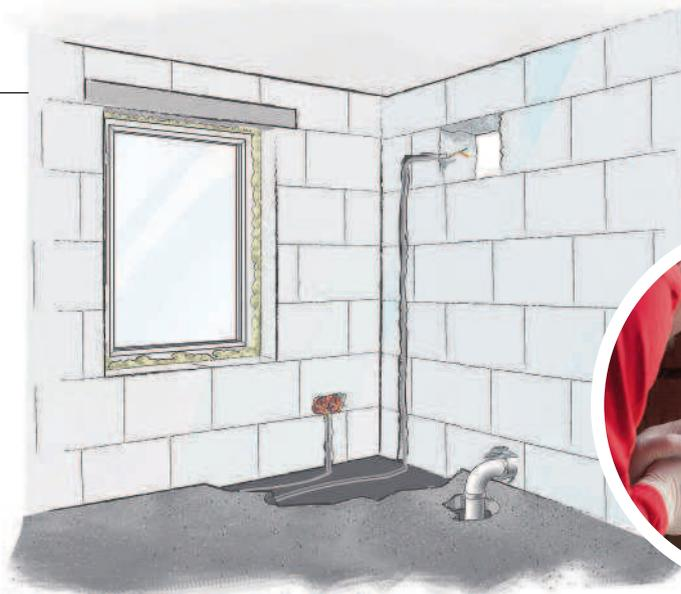
Tipp: den Untergrund sowie ausgebrachten Schaum mit etwas Wasser befeuchten
