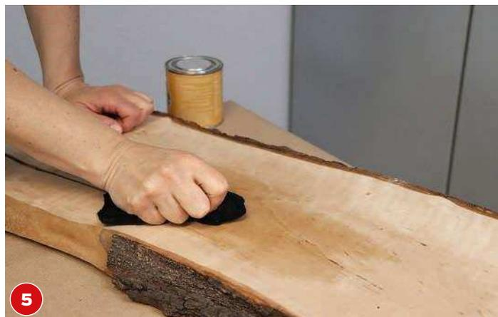
**5** Nun tragen Sie mit dem Lappen einen Öl-Wachs-Anstrich auf. Wischen Sie überschüssiges Öl ab. Trocknen lassen, dann mit Schleifgerät und 220er-Schleifpapier schleifen, wiederholen.
