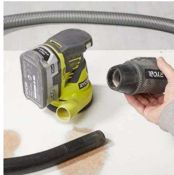
Die Absaugung funktioniert gut, das Entleeren der Beutel mit der kleinen Öffnung weniger
