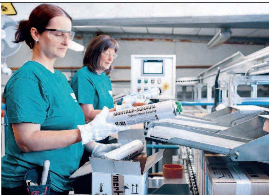
Um nicht nur das Aluminium und das Plastik, sondern auch die Reste chemischer Substanzen zu recyceln, werden aufgebrauchte PU-Schaumdosen nach Ein- und Zweikomponentenschäumen sortiert. Danach geht es in die jeweilige Recyclinganlage
