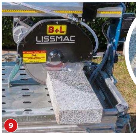
9 Die Lissmac, etwa von B + L, ist eine wassergekühlte Steinsäge. Damit die Kantsteine, wo nötig, zusägen; einbetonieren.
