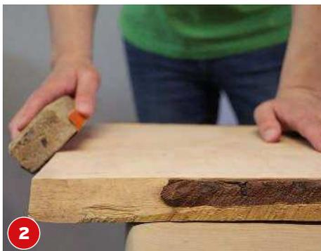
**2** Schleifen Sie nun die Sägekanten mit einem Schleifklotz und Schleifpapier; erst in einer Körnung von 150, dann von 220.
