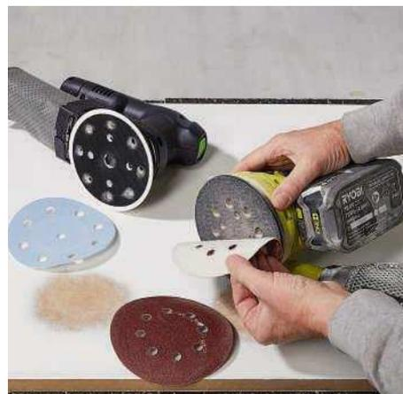
Das Schleifpapier wird aufgeklettet. Es sind Löcher für die Staubabsaugung vorhanden
