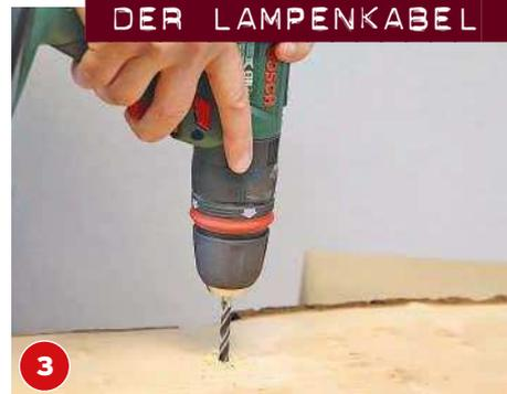
**3** Markieren Sie die Positionen der Lampen auf der Holzbohle mit Bleistift. Bohren und senken Sie die Löcher leicht an.
