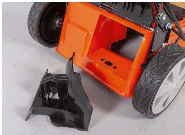
Der Mulchkeil versperrt den Auswurf und das Schnittgut wird fein gehäckselt
