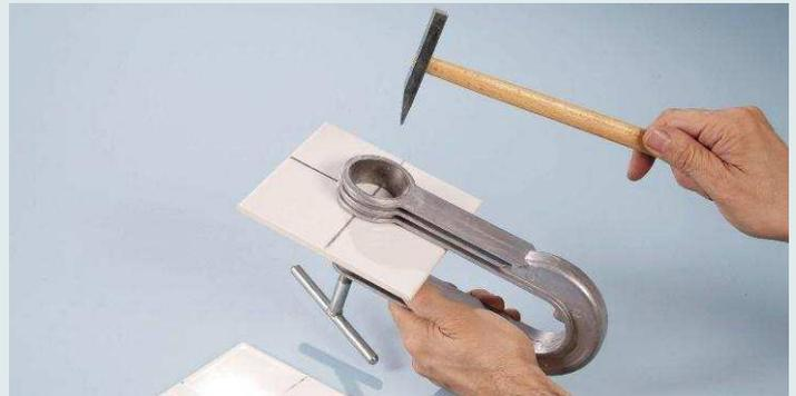
**Mit dem Lochgerät** schlägt man mit der Spitze des Fliesenhammers das Loch. Dazu wird die Fliese fest mittels Drehstempel an das Metallloch gepresst
