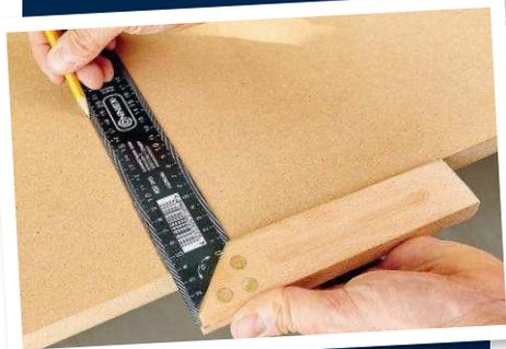
So prüfen Sie Ihren Winkel: Richten Sie den Anschlag des Winkels an einem geraden Brett aus und zeichnen Sie eine Linie entlang des Winkelschenkels. Drehen Sie den Winkel um 180° und richten den Anschlag am Brett und der gezeichneten Linie aus. Liegt nun der Anschlag am Brett gut an und der Winkelschenkel exakt auf dem Strich, dann zeigt der Winkel 90°.
