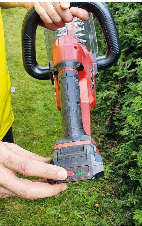
Die Akkus (2-5 Ah) haben eine Ladestandsanzeige. Mit dem 2-Ah-Akku ist die Schere schön leicht
