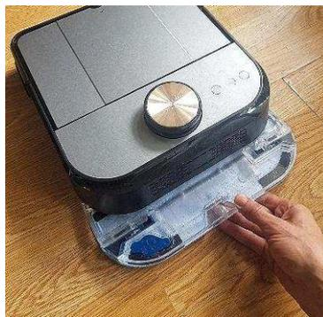
Zum Wischen wird der flache Wassertank mit dem Reinigungspad eingesteckt
