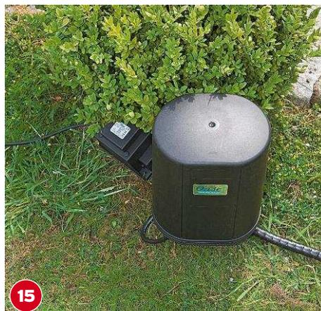
**15** Die Schutzhaube über die Steuerungsbox setzen. Gleich kann die Fernbedienung betätigt werden.
