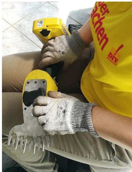
Schneller Wechsel: Das Werkzeug ist rasch aufgesetzt und festgeschraubt
