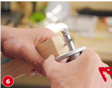
Mit einem Streichmaß die Positionen für die Stirnlöcher übertragen und diese ebenfalls bohren.
