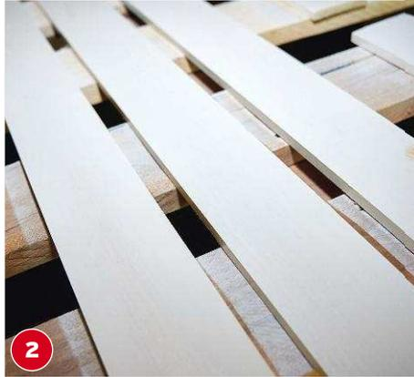
**2** Nach dem Fräsen der Nut die Kanten der bearbeiteten Leisten und vier weitere gleich große Leisten lackieren.
