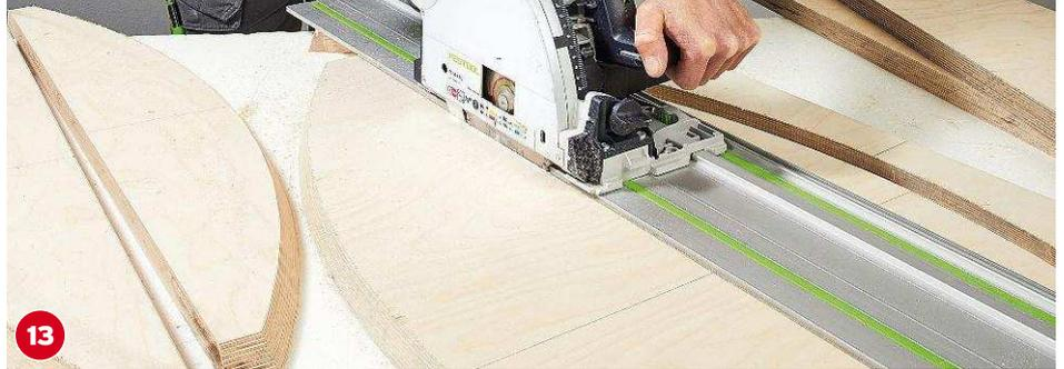
Das Sägen aller übrigen Borde geschieht nach dem gleichen Prinzip: immer erst die schrägen Seiten mit der Stichsäge (für zwei Borde auf einmal - es entsteht zwischen-durch eine Art „Fisch“), dann die Enden kappen und als Letztes die Borde mittig auftrennen.
