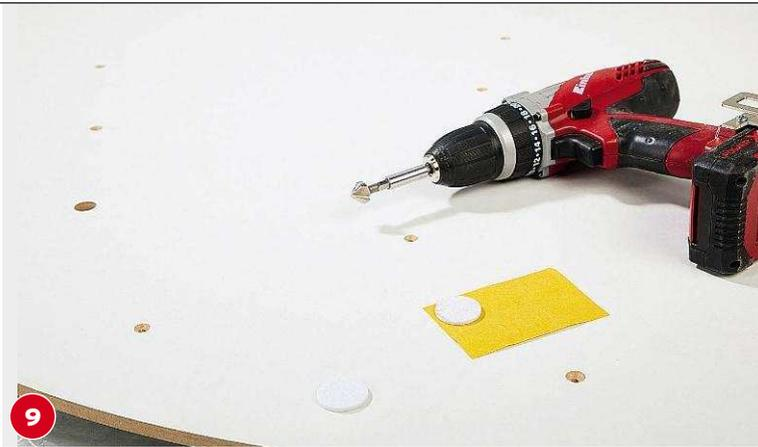
Von hinten senken wir alle Befestigungs-Löcher, damit die Schraubenköpfe bündig in der Oberfläche sitzen. Filz pads aufkleben.
