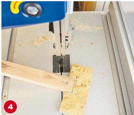
**4** Auf der Bandsäge eine Bohrlehre aus OSB ausschneiden. Auf einer Linie mit dem Abschluss der Lehre wird dann ...
