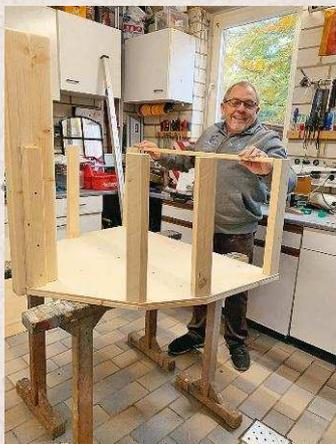
Aus Konstruktionshölzern, Sperrholz und gehobelten Latten entsteht der Bug
