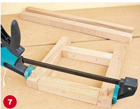
Beine verleimen und mit Zwingen und einem Stück Hilfsholz halten, sodass sie parallel werden. Die Teile ineinander stecken und verleimen.
