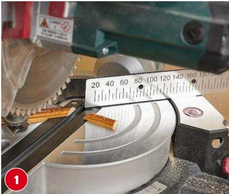
**1** Zierleisten zwei Mal auf 60 cm Länge und zwei Mal auf 22 cm Länge zusägen. Mit der Kappsäge je auf Gehrung sägen.
