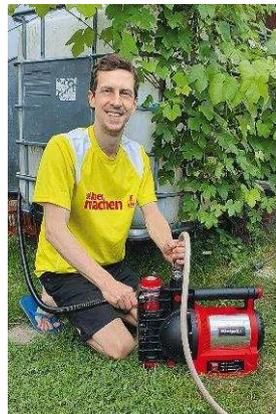
Über den schwarzen Schlauch wird Wasser angesaugt. Oben sitzt der Druckschlauchanschluss
