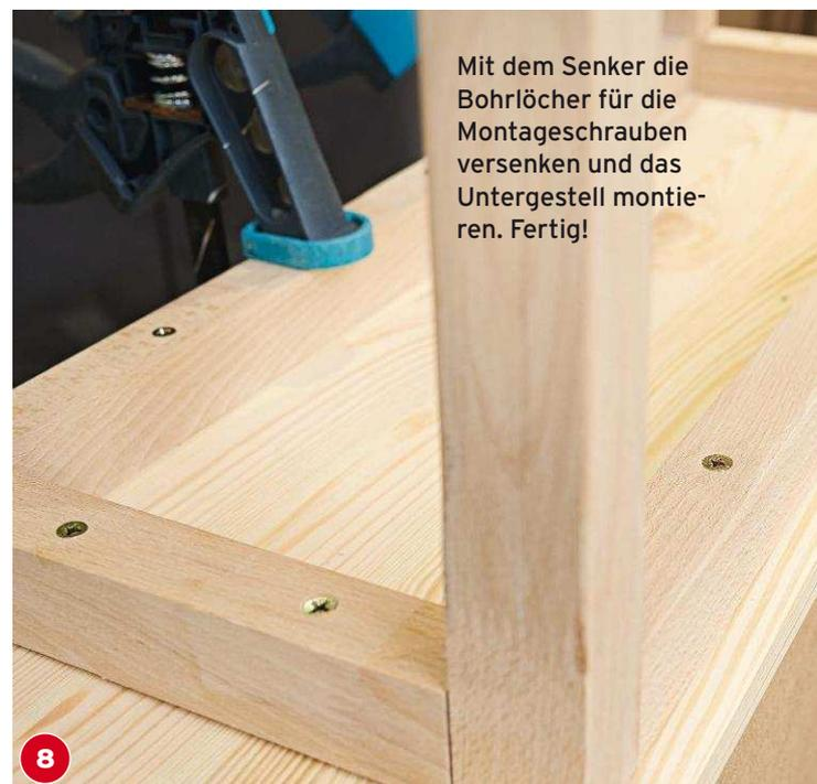
Mit dem Senker die Bohrlöcher für die Montageschrauben versenken und das Untergestell montieren. Fertig!
