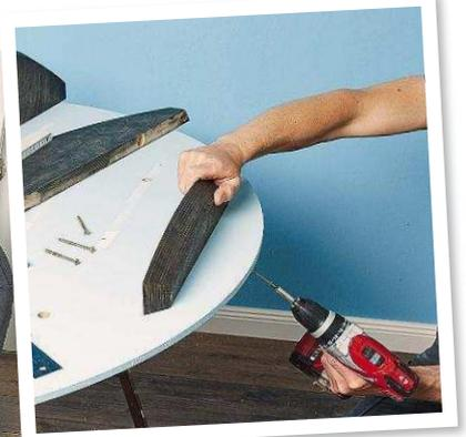
Hierbei kontrollieren wir noch mal ganz genau die Positionen und die Ausrichtung der Borde
