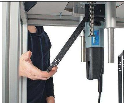
Mit dem Spannhebel spannt man von unten den Fräsmotor in den Frästisch
