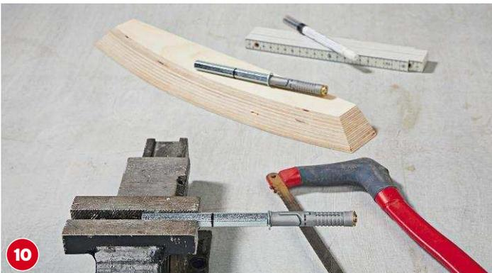
**10** Für die Borde 1 und 8 (oberstes und unterstes) werden die Tablarträger mit der Metallsäge gekürzt.
