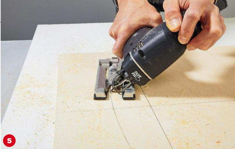
Nun sägen wir den schrägen Rand der kleinen Borde. Dies geschieht frei Hand mit der Stichsäge mit schräg gestelltem Sägeblatt.
