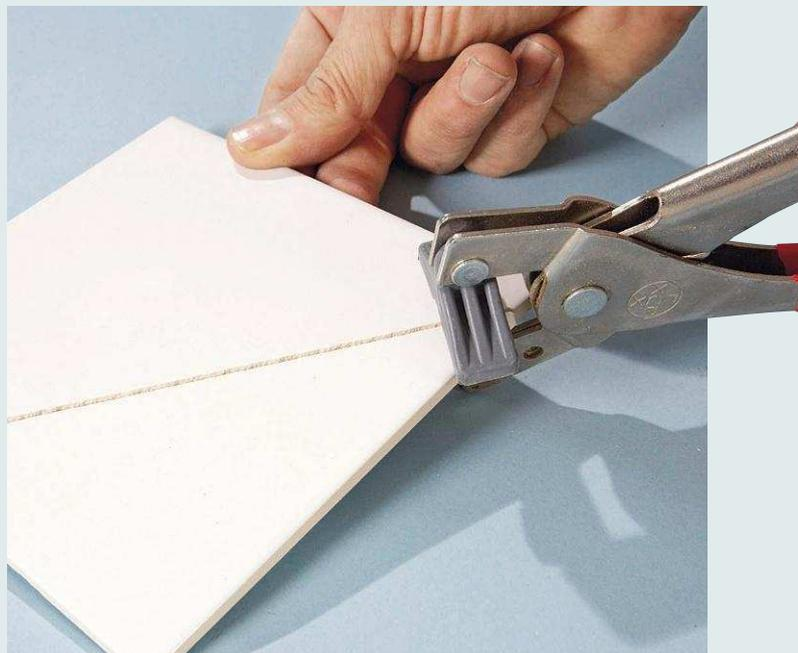
**Die Brechzange** wird bei der Bearbeitung per Hand benötigt. Auf der Risslinie angesetzt, bricht die Fliese durch den Druck des abgewinkelten Oberteils
