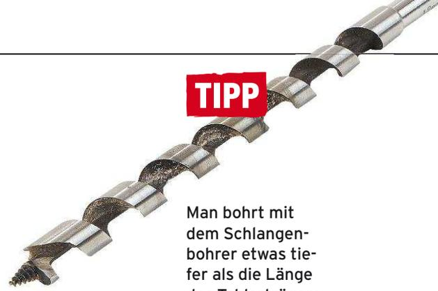
Man bohrt mit dem Schlangenbohrer etwas tiefer als die Länge des Tablarträgers.
