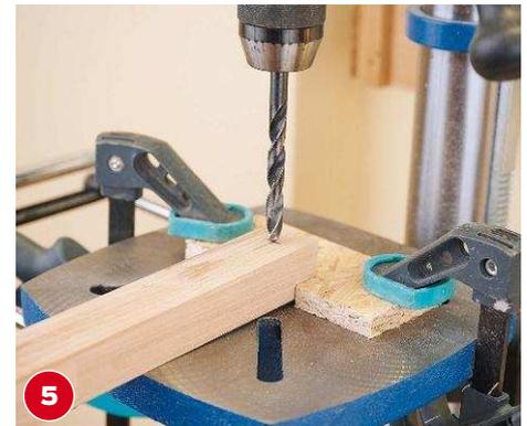
**5** ...das Loch für die Holzdübel der 28 cm langen Füße gebohrt: mit der Ständer-Bohrmaschine und einem 10-mm-Bohrer.
