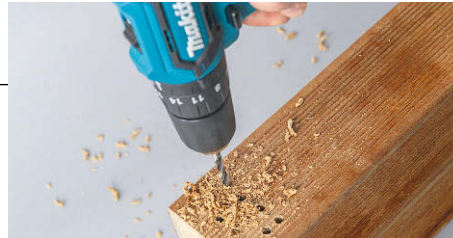
Mit dem 6-mm-Bohrer haben wir Löcher in Bangkirai-Hartholz gebohrt
