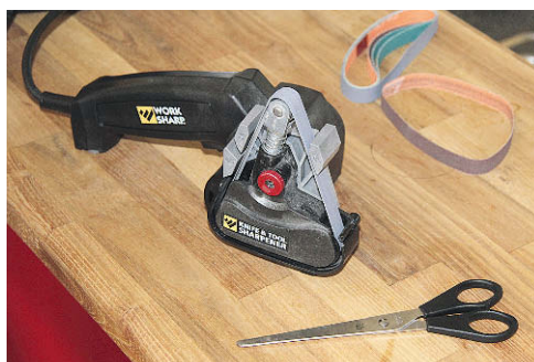
Es lassen sich auch Scheren und Messer mit Wellenschliff schärfen. Führungen für die richtigen Klingenwinkel sind mit dabei.
