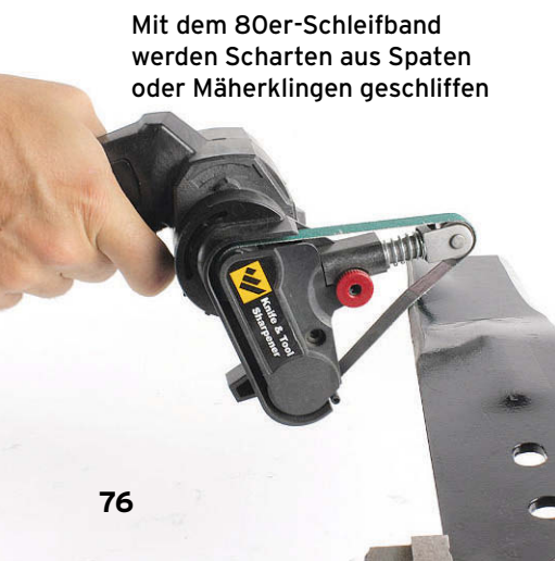
Es lassen sich auch Scheren und Messer mit Wellenschliff schärfen. Führungen für die richtigen Klingenwinkel sind mit dabei.
