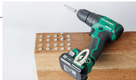
Die 6-x-80-mm-Schrauben in Hartholz haben außer AEG alle gut gemeistert
