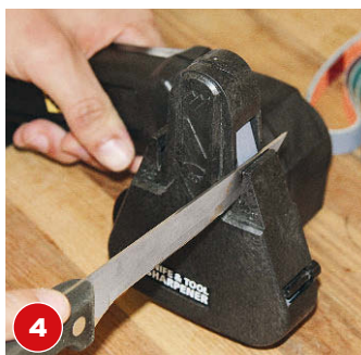
Der zweite Durchgang dient dem Feinschliff der Klinge. Nach je 10 groben und feinen Schleifdurchgängen sind Messer wieder gut geschärft.
