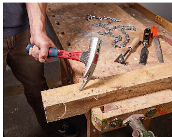
Das Holz mit diversen Werkzeugen malträtieren und verschiedene Macken zufügen.
