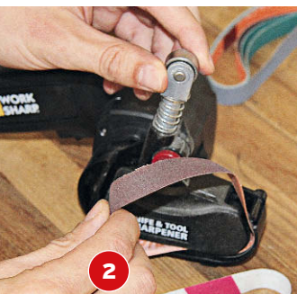
Schleifband wechseln: Messerführung abnehmen und die Bandführung nach unten drücken.
