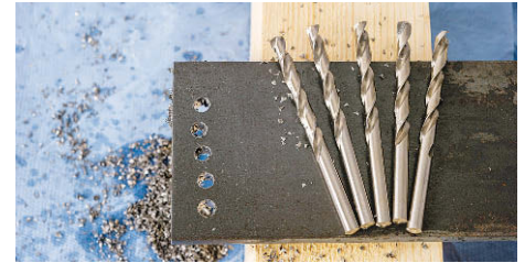
Das schnellste 8-mm-Loch im Baustahl: 17 Sekunden mit dem HiKoki-Gerät
