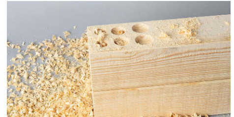
Mit Forstnerbohrern (25, 30 und 35 mm) haben wir die Leistungsgrenzen getestet
