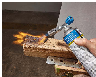
Die gesamte Oberfläche gleichmäßig mit einem Lötbrenner abflammen
