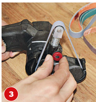
Das neu eingelegte, feine Schleifband mit 6.000er-Körnung wird mit dem roten Drehknopf bei vollem Lauf zentriert.
