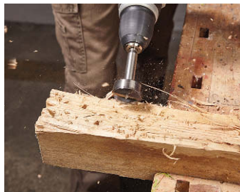
Ausprobieren: Der zweckentfremdete Forstnerbohrer hat sich als effektiv erwiesen
