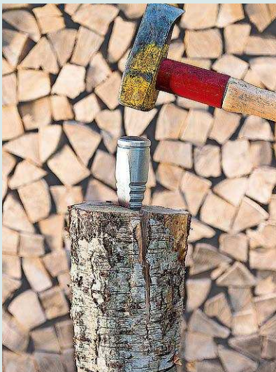
Spaltkeile, etwa aus Aluminium, erleichtern die Arbeit. Nie mit Stahl auf Stahl schlagen, denn dabei können gefährliche Splitter entstehen
