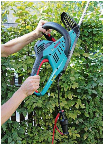
Die Zugentlastung ist direkt über dem Stecker angebracht, der dann etwa hüfthoch hängt
