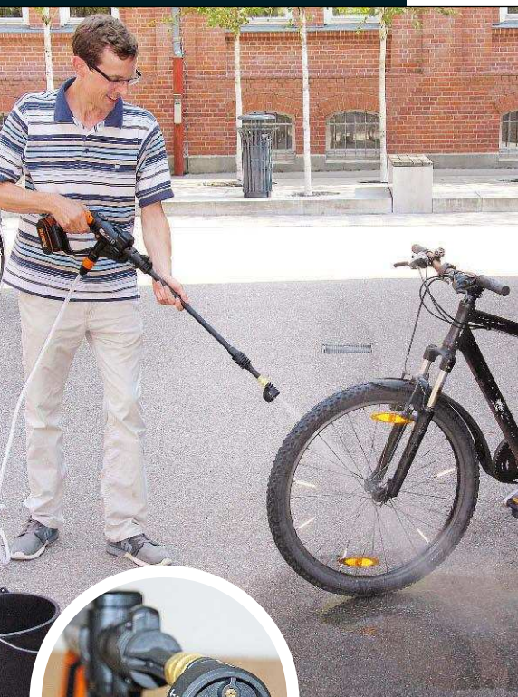
Die Düse hat vier Strahlstärken und einen „Gießmodus“
