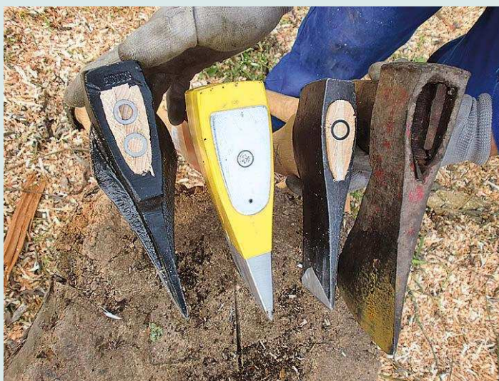
Längliche Keile aus Holz und Eisen oder moderne Ringkeile verspreizen den Stiel im Ohr
