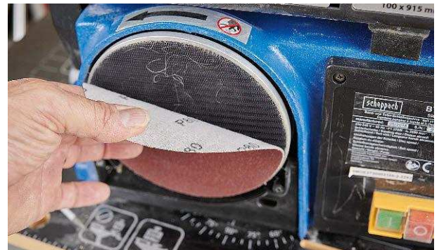
Die Schleifscheiben werden einfach leicht aufgedrückt
