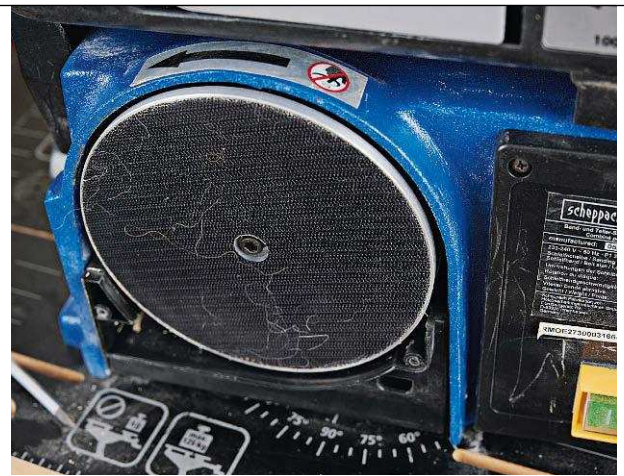
Es gibt leider keine im Teller integrierte Staubabsaugung. Die Klettfläche gibt es als Ersatzteil
