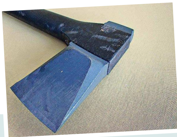
Eine Beschichtung des Axtkopfes schützt vor Rost – jedoch nur bis zum ersten Nachschärfen
