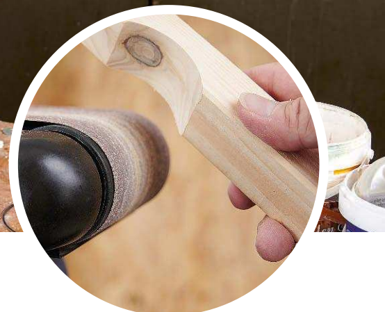
Konkave Rundungen lassen sich am Ende des Bandschleifers formen
