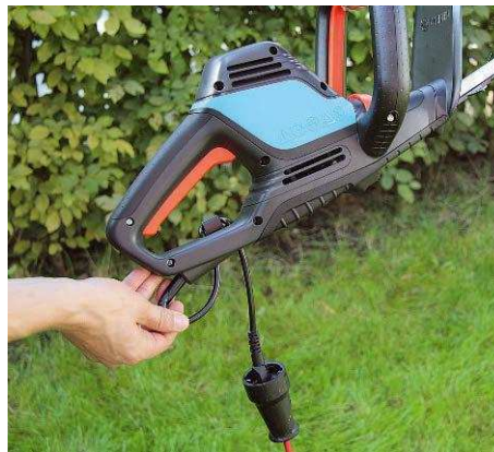
Die Zugentlastung ist unter dem Griff, der Stecker baumelt etwas unpraktisch daneben
