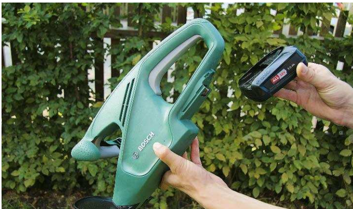
Den Bosch-Akku kann man für alle anderen 18-V-Werkzeuge nutzen. Leider haben weder Akku noch Gerät eine Ladeanzeige und das Einsetzen ist hakelig
