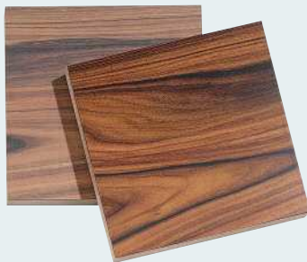
Das Kernholz von Santos-Palisander hat schwarz-violette Streifen. Der Splint ist hell
