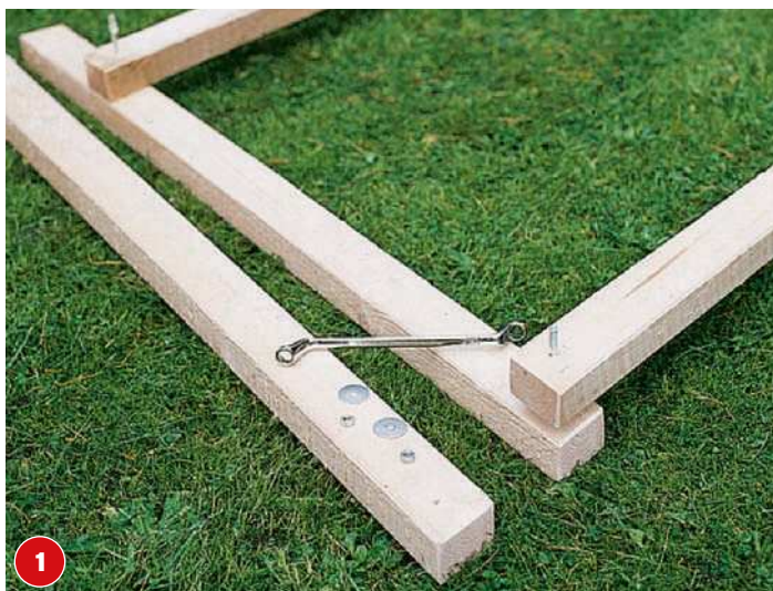
Die senkrechten Leisten klemmen zwischen je zwei Querhölzern. Für die Verbindung nimmt man 6-mm-Schlossschrauben.
