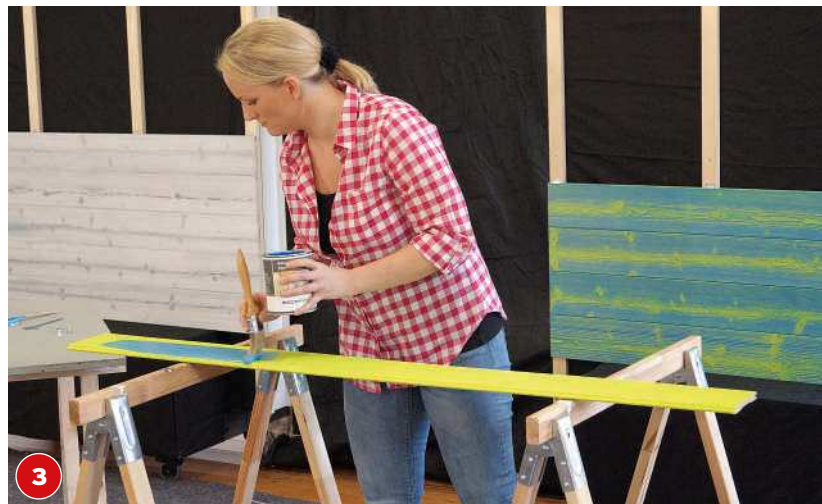
3 Nach mindestens 2 h Trocknungszeit die Zweitfarbe auftragen. Die Farbe zügig und dick angeben.
