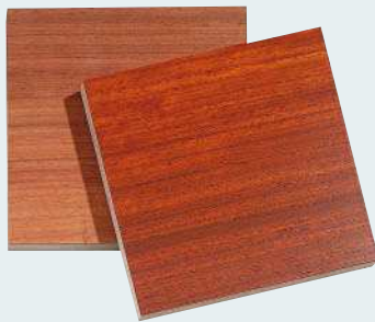
Burma-Padouk: Korallenrotes Kernholz, weißer Splint. Das Holz dunkelt etwas nach
