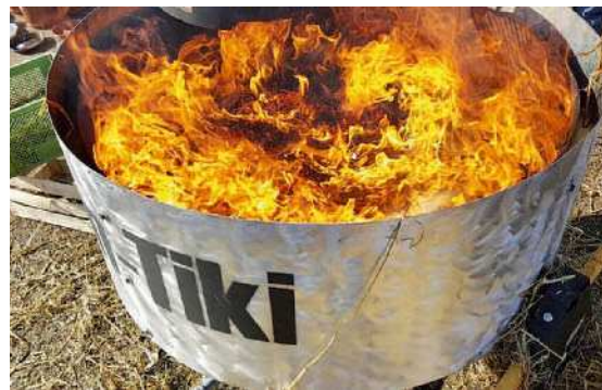
Der Kon-Tiki ist ein kleiner Pyrolyse-Meiler zur Herstellung von Pflanzenkohle
