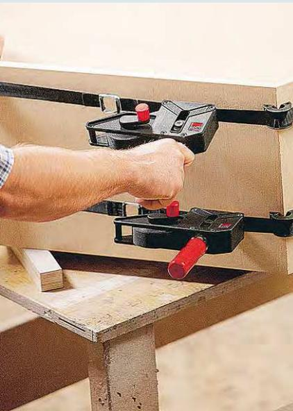
**Bandspanner:** Um Möbel mit komplexeren Formen, etwa einem Sechseck, zu bauen, benötigt man sogenannte Bandspanner. Sie üben gleichmäßigen Druck auf alle Gehrungen aus.
