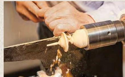
Aus einem Stück Massivholz wird ein Kreisel gedreht
