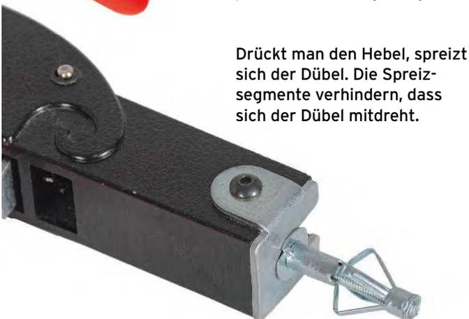
Drückt man den Hebel, spreizt sich der Dübel. Die Spreiz-segmente verhindern, dass sich der Dübel mitdreht.
