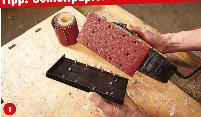
Ein praktisches Zusatztool ist die Lochstanze für die Absauglöcher. Damit kann man sich problemlos das passende Schleifpapier günstig von der Rolle anfertigen.
