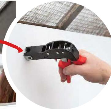
Mit einer speziellen Montagezange ver-spreizt man die Dübel in der Wand
