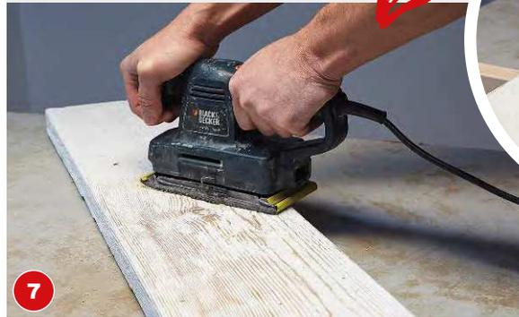
**7** Zuerst das Brett vollflächig deckend lackieren, im zweiten Schritt die Oberfläche beidseitig mit 80er-Körnung abschleifen.
