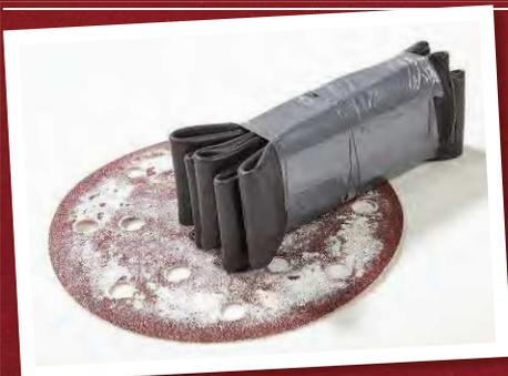
Ein selbst hergestellter Schleifscheiben-Radiergummi aus einem alten Fahrradschlauch funktioniert genauso gut wie ein Gummi-Reinigungsstift und ist gratis!
