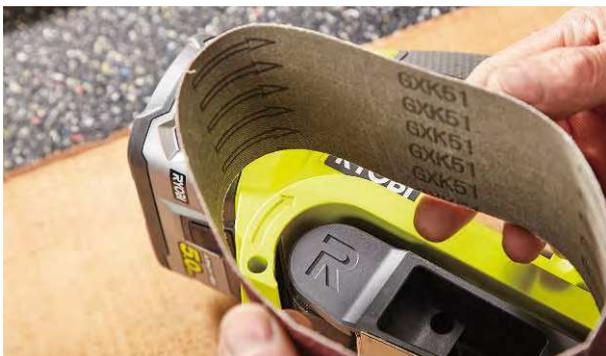
Beim Einlegen des Schleifbandes auf die Laufrichtung achten. Diese ist an der Maschine und auf der Innenseite des Schleifbandes durch Pfeile gekennzeichnet
