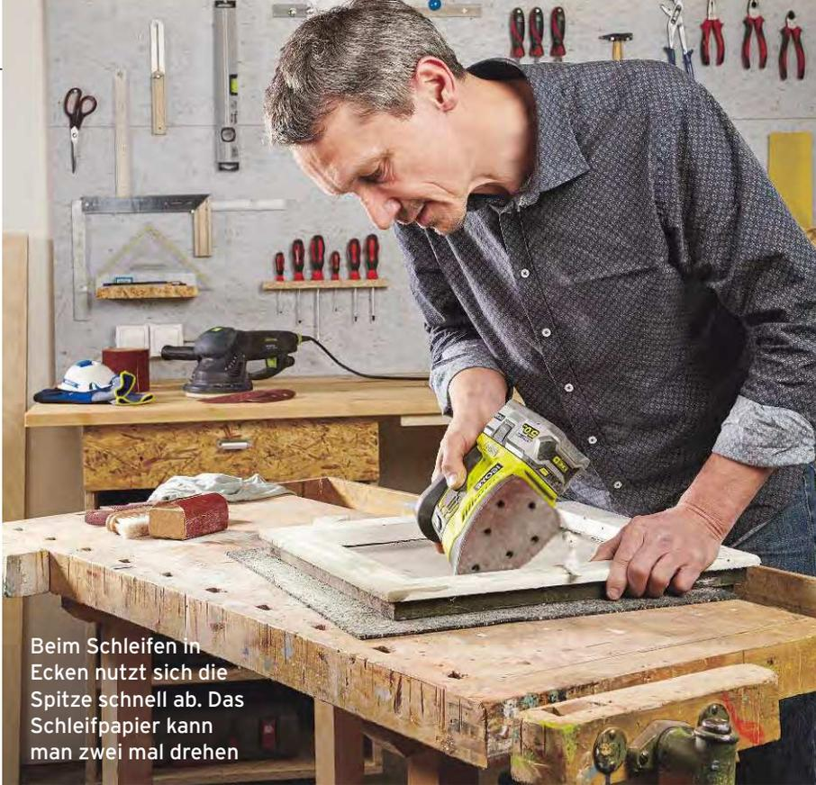
Beim Schleifen in Ecken nutzt sich die Spitze schnell ab. Das Schleifpapier kann man zwei mal drehen
