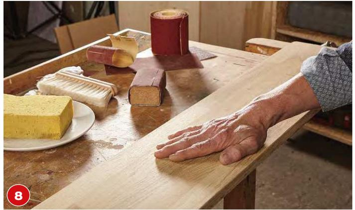
**8 Zum Überprüfen der Oberfläche** fahren Sie mit der flachen Hand langsam über die bearbeitete Fläche. Falls nötig, noch die Kanten mit dem Klotz und feinem Schleifpapier brechen.
