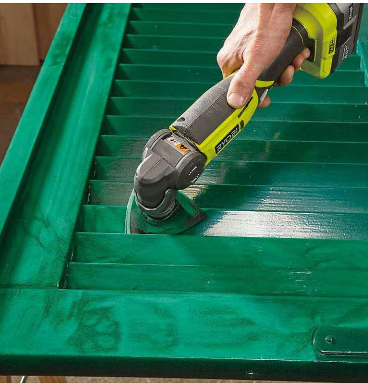
Der flache Schleifkopf kommt auch in enge Zwischenräume und in kleine Ecken
