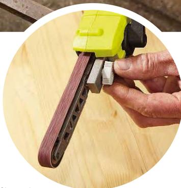
Die Position des Schleifbandes muss man auf der Lauffläche bei laufender Maschine einstellen
