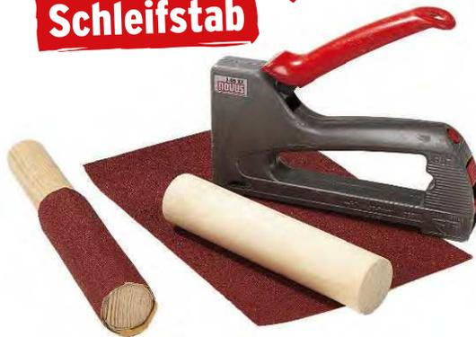
Ein Stück Schleifpapier, auf einem Rundholzstab festgetackert, ergibt ein super Hilfsmittel zum Schleifen von runden Ausschnitten oder speziell geformten Werkstücken
