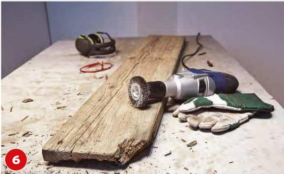
**6** Um die Holzmaserung zu betonen, kommt die Drahtbürste zum Einsatz. Sie entfernt weiches Holz und sorgt so für eine markante Struktur.
