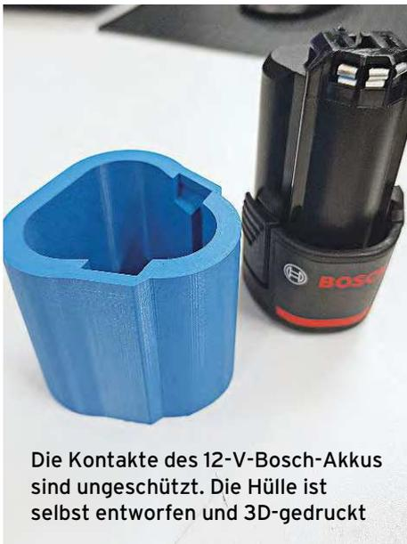
Die Kontakte des 12-V-Bosch-Akkus sind ungeschützt. Die Hülle ist selbst entworfen und 3D-gedruckt
