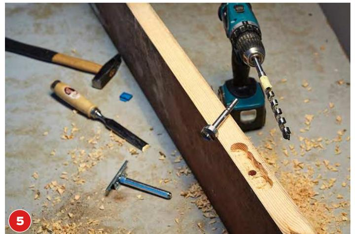
**5** Sackloch (12 mm) bohren. Die Kanten am Brett mit 80er-Korn abschleifen. Für den nächsten Schritt brauchen Sie Schutzbrille und Handschuhe.
