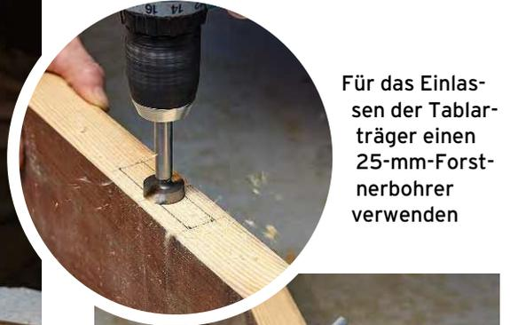
Für das Einlassen der Tablarträger einen 25-mm-Forstnerbohrer verwenden
