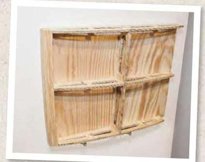
Die Spanten geben die Form vor. Sie sind aus Kiefernsperrholz gefertigt
