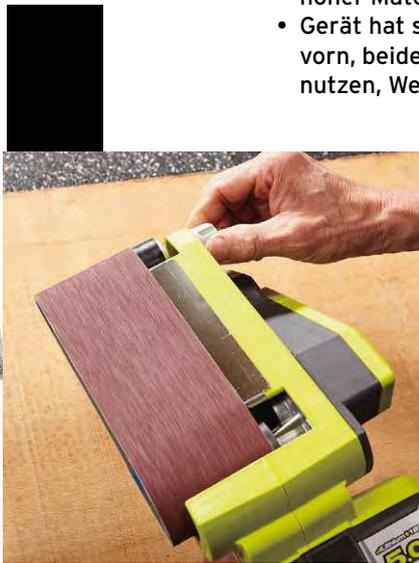
Damit das Schleifband gerade läuft, muss man es bei laufender Maschine zentrieren
