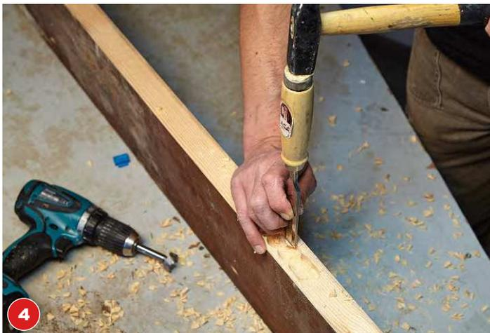
**4** Holzecken mit Stecheisen und Hammer vorsichtig entfernen.
