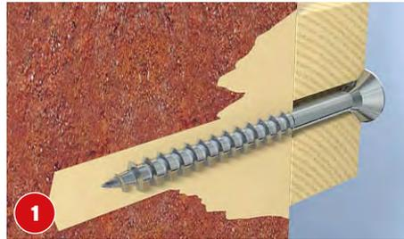
1 Die Masse schäumt nach dem Injizieren leicht auf und bietet Holzschrauben einen ausreichenden Halt.
