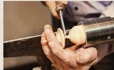
Nach dem Schleifen, Wachsen und Polieren wird das fertige Objekt vorsichtig abgetrennt
