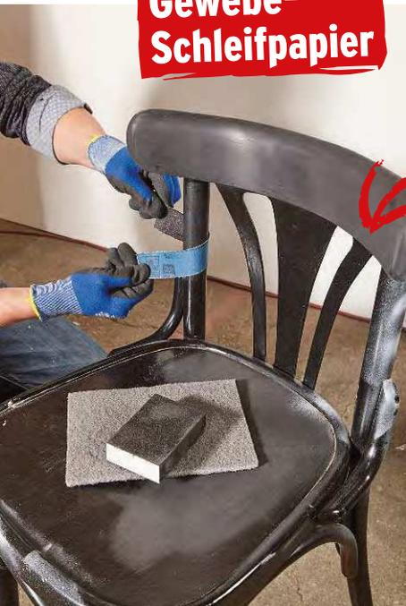
Mit einem Streifen Schleiflein kann man problemlos runde Flächen anschleifen, etwa vor dem Neulackieren. Vollständiges Abschleifen ist mit dieser Methode mühsam und dauert
