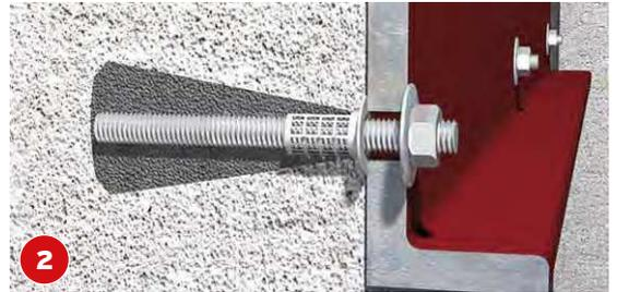
2 Die Ankerstange und der ausgehärtete Mörtelkonus sind untrennbar miteinander verbunden und können belastet werden.
