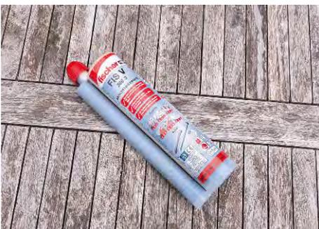
Mit dem Injektionsmörtel *Fis V* von Fischer lassen sich Verankerungen oder Bewehrungsanschlüsse im Mauerwerk befestigen. Er hält die Verankerung im Hochlochziegel genauso gut wie in Porenbeton. Wichtig: Die Verarbeitungszeit des Klebers ist kurz (etwa vier Minuten). Man muss also schnell arbeiten und alles gut vorbereiten. [www.fischer.de](http://www.fischer.de)
