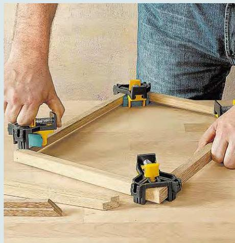
**Winkelspanner:** Zum schnellen und einfachen Fixieren von Brettern und Rahmen im Winkel von 90 Grad nutzt man Winkelspanner. So lassen sich auch Eck- und T-Verbindungen fixieren.
