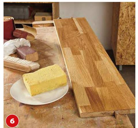
**Zweites Mal anfeuchten:** Für ein richtig feines Endergebnis wird das Werkstück erneut angefeuchtet.
