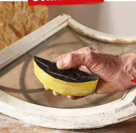
Ein plankonvexer Kunststoffschleifklotz (etwa 3 Euro im Baumarkt) erleichtert das Schleifen von gebogenen Werkstücken. Das Schleifpapier wird einfach eingeklemmt; es passt jedes
