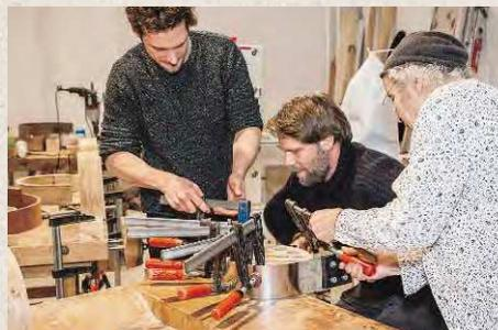
Per Zugband aus Metall und vielen Zwingen wird das heiße Holz in Form gebracht
