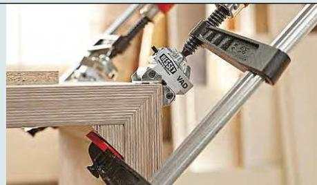
Mit passender Spannklemmer übt die Zwinde gleichmäßig Druck auf die Gehrung aus
