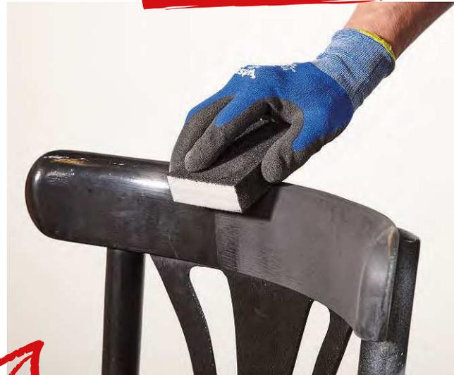
Mit dem Schleifschwamm lassen sich gebogene lackierte Oberflächen gut für das Lackieren vorbereiten und mattieren
