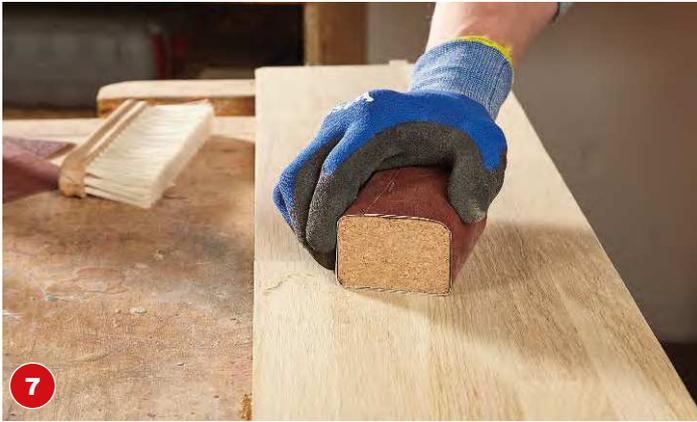
**7 Feinschliff:** Mit feinem Schleifpapier (Körnung 180-240) in Faserrichtung über das Werkstück gehen. Gleichmäßig und nur mit leichtem Druck schleifen.
