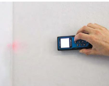
Der Laser-Entfernungsmesser misst Distanzen bis 40 Meter sehr genau
