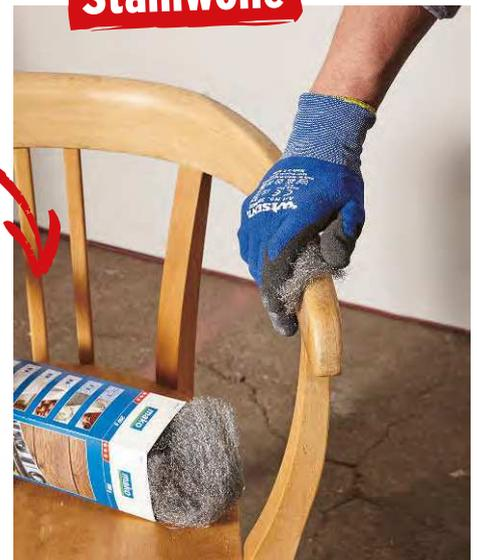
Beim Bearbeiten von gewachsenen oder geölten Oberflächen ist Stahlwolle das richtige Schleifmittel, da es sich nicht so leicht zusetzt und die Oberfläche des Werkstückes nicht verschmiert
