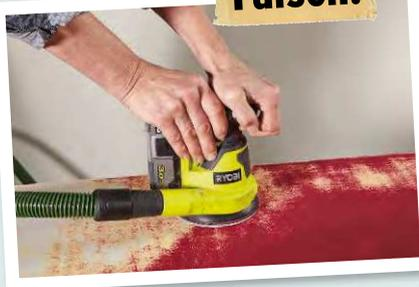
Druck auf das Gerät verschleißt das Schleifpapier schnell und erschwert die Arbeit
