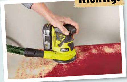
Richtiges Schleifen mit wenig Druck auf das Gerät. Man muss es nur führen
