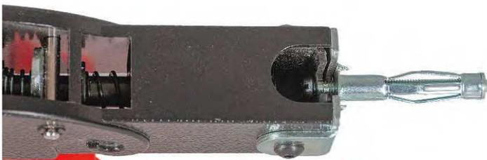
Besonders einfach ist die Montage des Dübels mit der passenden Montagezange.
