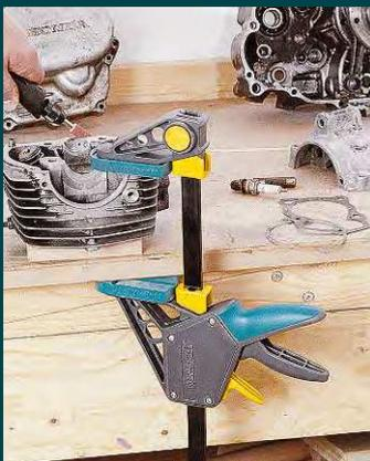
Als normale Einhandzwinde kann die Wolfcraft EHZ Pro dank ihrer 100-mm-Ausladung und einer Kreuznut für das Einspannen runder Objekte auch für besondere Werkstücke genutzt werden. Mit bis zu 120 Kilogramm Spannkraft entwickelt sie dabei genug Anpressdruck für anspruchsvolle Arbeiten.
