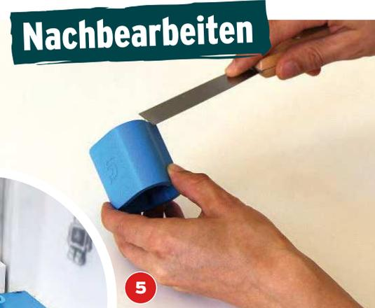
Nach etwa zweieinhalb Stunden ist die Akkühülle fertig und muss noch entgratet werden.
