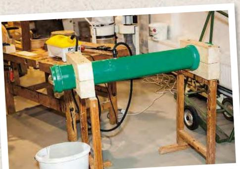
In dieser Kunststoffröhre wird das Holzstück in heißem Wasserdampf erhitzt
