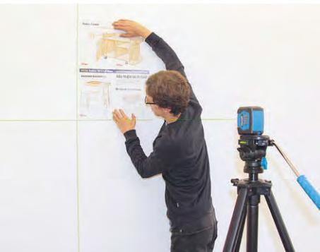
Mit dem Laser können Sie Bilder ohne Wasserwaage ausrichten, die Hände bleiben frei
