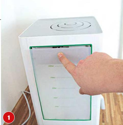
**1** Wasserbehälter auffüllen: auf den eingelasenen Knopf drücken, Behälter entnehmen.
