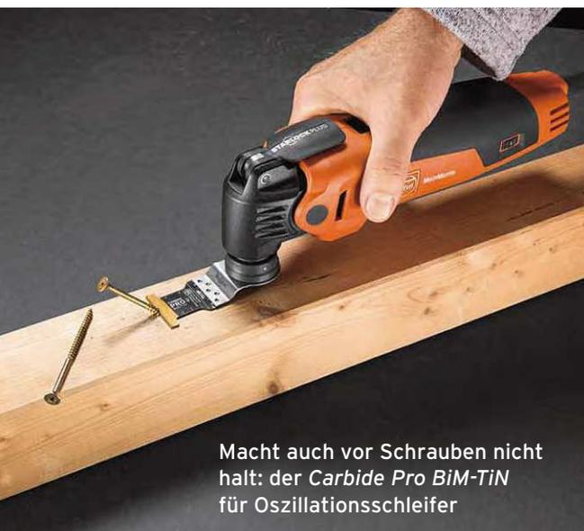
Macht auch vor Schrauben nicht halt: der *Carbide Pro BiM-TiN* für Oszillationsschleifer
