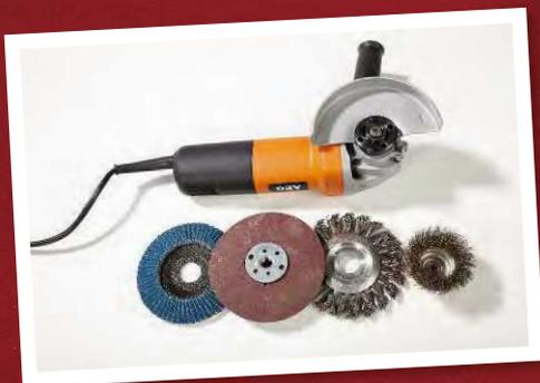
Für Arbeiten an fein strukturierten Teilen aus Holz oder Metall ist die Drahtbürste auf der Flex die richtige Wahl. Eine Fächer-schleifscheibe kann im Notfall ein Schleifgerät ersetzen.
