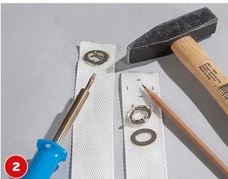
Ösen in den Gurtenden befestigen. Mit einem LötKolben schmelzen Sie die Öffnungen in das Kunststoff-Gurtband.
