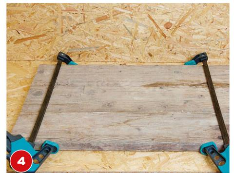
Die Bretter anschließend mit Zwingen fest zusammenpressen. So entsteht eine stabile Verbindung.
