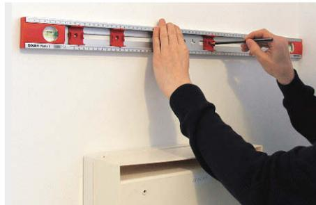
... und durch die Löcher in den Schiebern direkt an Wand oder Werkstück übertragen
