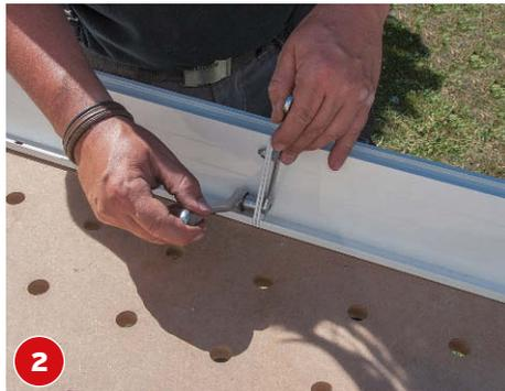
Auch der vordere Querträger besteht aus zwei Teilen. Diese entsprechend verschrauben.
