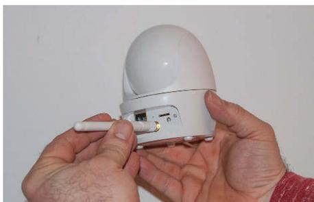
Um eine ideale WLAN-Verbindung herzustellen, schrauben Sie auf der Rückseite die Antenne an
