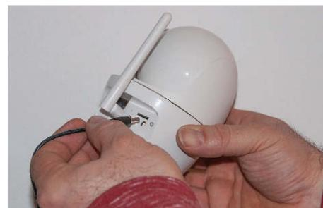
Stecken Sie das Netzteil in die Buchse und setzen Sie eine microSD Karte ein
