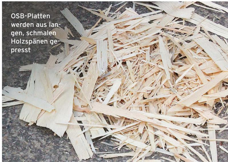
OSB-Platten werden aus langen, schmalen Holzspänen gepresst
