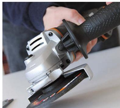
Den Handgriff kann man rechts oder links montieren, die Schutzhaube ist verstellbar
