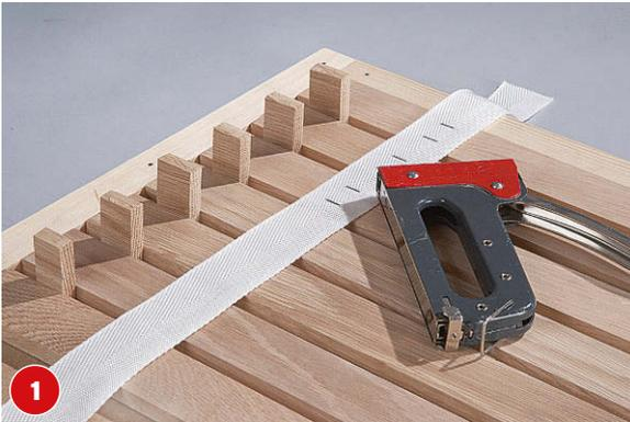
Die Leisten im Abstand von 10 mm auf einen Gurt tackern. Zwei rechtwinklig auf einer Platte fixierte Kanten erleichtern das Ausrichten.
