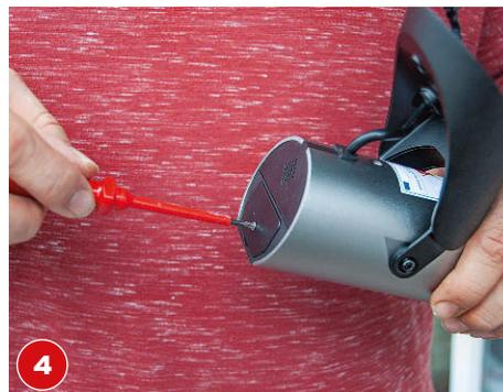
**4** Auf der Unterseite die Verschraubung der wasserdichten Klappe lösen und öffnen.
