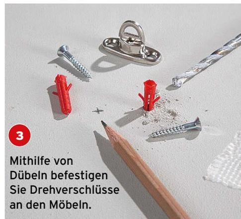
Mithilfe von Dübeln befestigen Sie Drehverschlüsse an den Möbeln.
