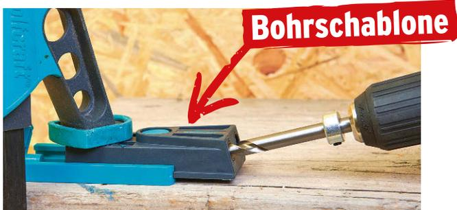
Die Regalbretter werden über verdeckte Verbindungen mit den Seiten verbunden. Die Schraublöcher sitzen an der Unterseite der Bretter und sind nicht zu sehen
