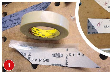
**1** Schleifpapierblätter nach Schablone ausschneiden und faserverstärktes Tape (3M) wie auf dem Bild aufkleben.
