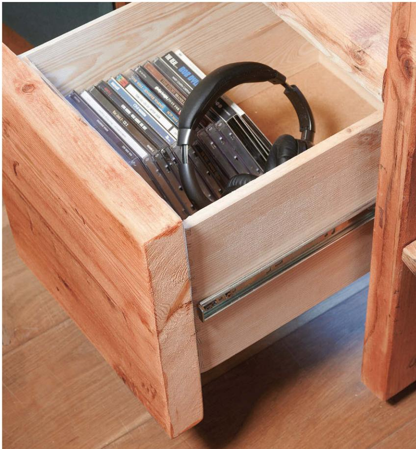
Platz für Kopfhörer, Steckadapter und Kleinkram: Die Frontblende der Schublade besteht aus Altholz, der Korpus wird aus Buchenleimholz gefertigt. Zur platzsparenden Befestigung fräast man für den Auszug eine Nut in die Regalwand. Der Soft-Closing-Auszug öffnet auf Berührung
