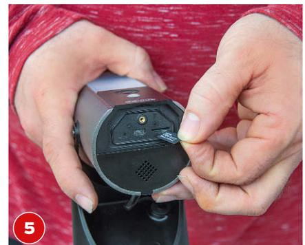
**5** Unter der Klappe liegen der Resetbutton, die USB-Buchse und der Micro-SD-Kartenslot.
