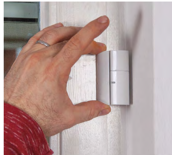
Öffnungsmelder oben am Tür- oder Fensterrahmen aufkleben. So wird auch ein gekipptes Fenster gemeldet
