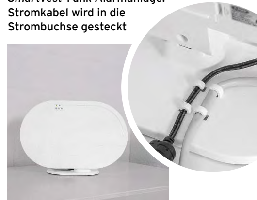
Die Basisstation: Kabel hakt man am Fuß ein – so beugt man Wackelkontakten vor
