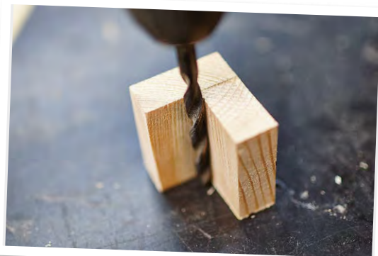
Gerade bohren: Zwei zusammengeleimte Holzblöcke dienen als Führung
