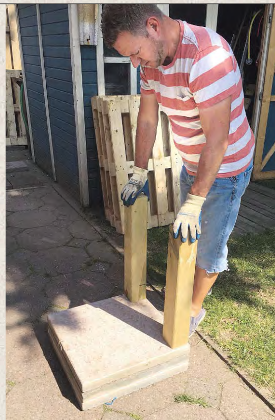
Drei vom Terrassenbau übrig gebliebene Granitplatten bilden den Sockel für den Tisch
