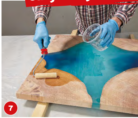
7 Mit Kunstharz (SKresin 72) oben und an den Seiten versiegeln und aushärten lassen. Dann die Unterseite versiegeln.
