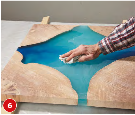
6 Die Tischoberfläche mit einem nebelfeuchten Lappen gründlich entstauben. Staub zeichnet sich leicht unter Lack ab.
