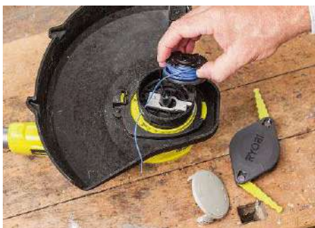
Die Fadenspule befindet sich im Kunststoffkorb. Die lose auf der Welle sitzende Spule nach oben herausziehen
