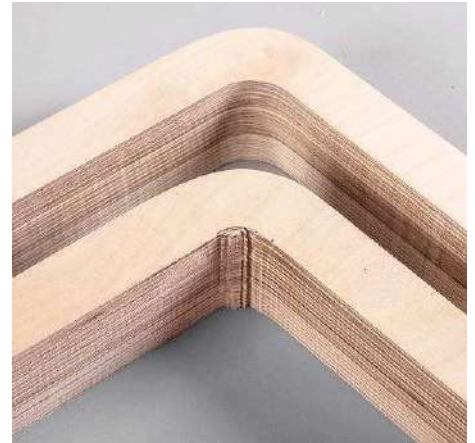
Wenn der Durchmesser der Schleifspindel und die Rundung im Innenwinkel zusammenpassen, wird sie wunderbar eben
