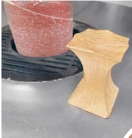
Schachfigur, hergestellt mit dem Spindelschleifer: Konkave Formen sind eine seiner Paradedisziplinen
