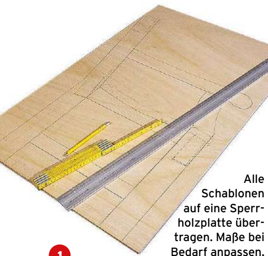
Schablonen auf die gehobelten Sipo-Rohlinge auflegen und übertragen. Zeichnen Sie die Konturen deutlich nach.
