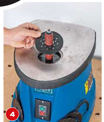
Nach der Montage der Schleifhülse setzt man die passende Tischeinlage ein und kann dann losschleifen.
