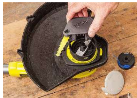
Die Abdeckplatte mit den drehbar gelagerten Messern auf die Welle führen, bis die seitlichen Stege im Korb einrasten
