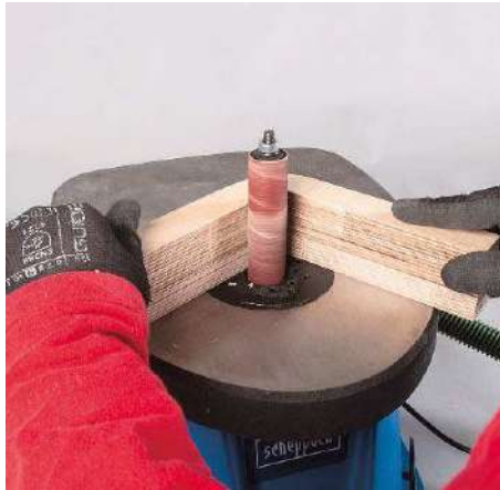
Mit dem Spindelschleifer können Sie Rundungen an Innenwinkeln am besten bearbeiten
