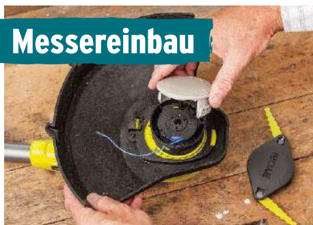
Einige Modelle lassen sich von Faden- auf Messerbetrieb umrüsten, etwa bei Ryobi: Abdeckung entsichern und abnehmen
