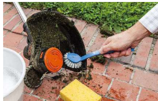
Mechanische Elemente wie den Antrieb und die Fadenspule vorsichtig bürsten und wischen, damit kein Wasser eindringt
