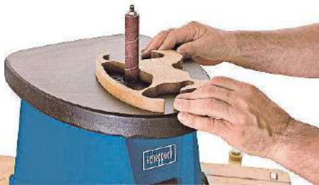
Filigrane Stücke und Ausschnitte in Holz lassen sich mit der Maschine besser als mit allen anderen Schleifern ausarbeiten
