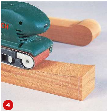
Die Bauteile mit 40er oder 60er Schleifpapier bearbeiten. Bei hohlen Flächen kommt der Bandschleifer zum Einsatz.
