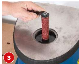
Die obere Spindelscheibe und den Federring aufsetzen und die Mutter mit dem mitgelieferten Schlüssel festziehen.
