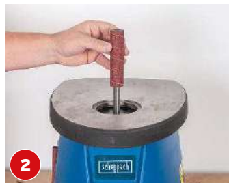
Die Gummihülse mit der passenden Schleifhülse wird auf die Werkzeugspindel der Maschine gesetzt.
