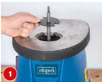
Um die Maschine zu bestücken, muss man zunächst die untere Spindelscheibe einsetzen.
