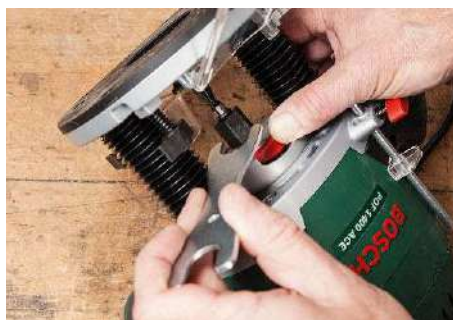
Zum Wechsel des Fräseinsatzes wird mit der Taste die Antriebswelle blockiert und mittels Gabelschlüssel die Mutter bewegt
