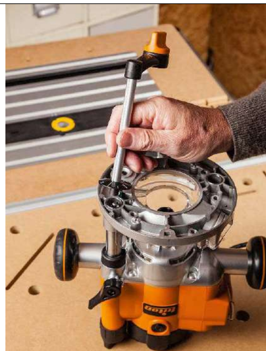
Mit der Kurbel kann die Schnitttiefe der Triton bei Verwendung als stationäre Fräse bequem von oben justiert werden
