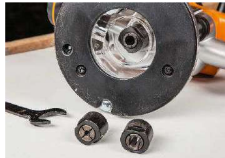
Ein bis drei Spannhülsen gibt es dazu. Die gängige 8-mm-Variante sollte dabei oder zumindest optional erhältlich sein
