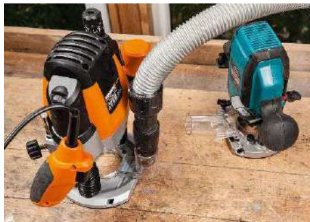
Eine stehende Absaugung (links Worx) belastet den Adapter stark, die liegende Variante ist beim Arbeiten praktikabler
