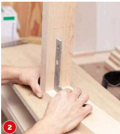
Schmiege und Winkelleisen sind wichtige Werkzeuge zum Anreißen von Winkeln
