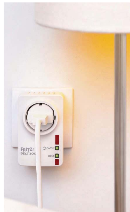
Statt im überfüllten 2,4-GHz-Netz lassen sich die FritzDECT-Adapter per „Telefon-Funk“ schalten
