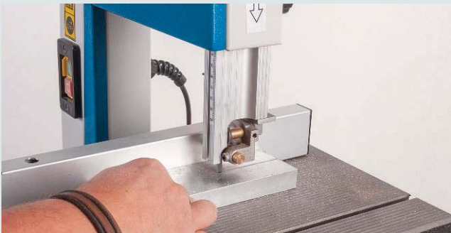
Beim Metallsägen gilt – wie beim Holzzuschnitt auch –, das Material nur langsam und nicht mit zu viel Druck zu schieben, damit das Sägeband nicht zu heiß wird
