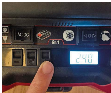
Den gewünschten Druck kann man vorab einstellen (bar, PSI, kPa), die Lesbarkeit des Displays könnte jedoch besser sein
