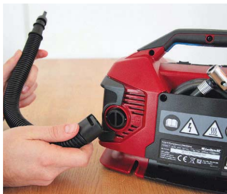
Die Pressanschlüsse für Luftein- und -auslass sind nicht besonders hochwertig, der Luftpumpenschlauch 37 cm kurz
