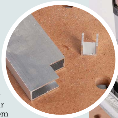
Leicht gemacht: das Ausklinken von Aluprofilen
