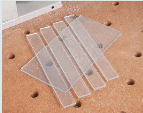
Exakt gleiche Acrylglas-Zuschnitte dank Anschlag
