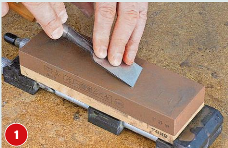
1 Die Fase auf Körnung 1.000 schärfen. Das Eisen leicht diagonal auf den Stein aufsetzen und linear bewegen.
