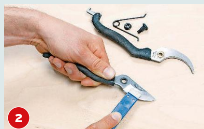
2 Gartenschere: Mit einer groben Abziehfeile werden größere Kratzer und Ausbrüche ausgeschliffen.
