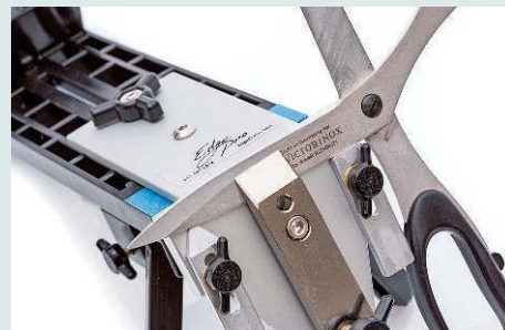
Eine spezielle Schleifführung – hier für Scheren – erleichtert es, den Faserwinkel exakt einzuhalten
