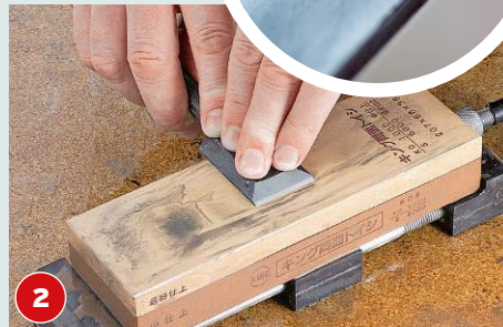
2 Im Anschluss ans Schärfen werden sowohl Spiegelseite als auch Fase auf Körnung 4.000 oder 8.000 abgezogen.
