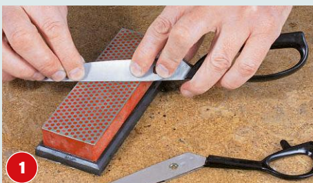
1 Zum Schleifen von Scherenklingen aus hartem Stahl eignen sich robuste Blöcke, auf die Diamantpartikel aufgebracht sind
