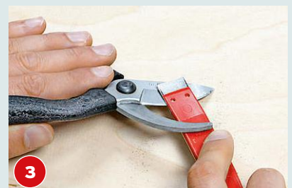
3 Das Abziehen des Grats mit der Abziehfeile kann man mit der wieder montierten Schere vornehmen.
