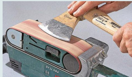
Ein umgedrehter und fixierter Bandschleifer kann ebenso zum Schärfen einer stumpfen Axt verwendet werden
