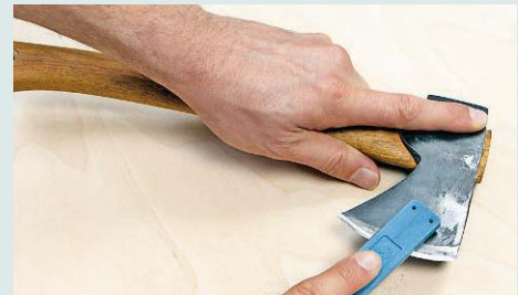
Das präzise und schärfste Ergebnis liefern Abziehfeilen (Seite 79). Zuletzt einen Kombistein 1.000/6.000 nutzen
