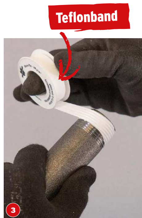
3 Um die Rohre für den Holzscheithalter fest miteinander zu verbinden, wird Dichtband auf das Gewinde gewickelt.
