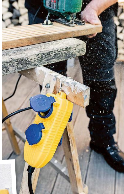
Sicheres Arbeiten mit Elektrowerkzeugen mit einem FI-Zwischenstecker
