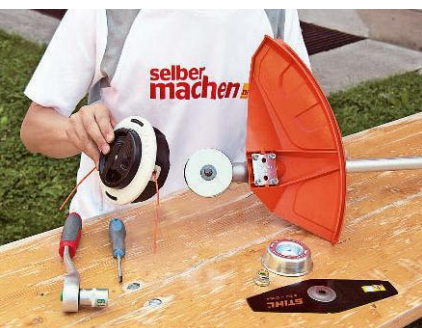
Auf den Mähkopf kann man die Fadenspule oder das Grasschneideblatt montieren
