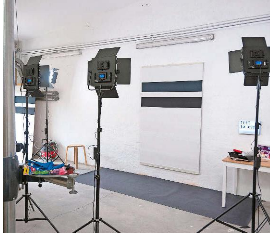
Die Testflächen werden mit LED-Leuchten ausgeleuchtet, die Tageslicht simulieren, um das Ergebnis möglichst genau beurteilen zu können.
