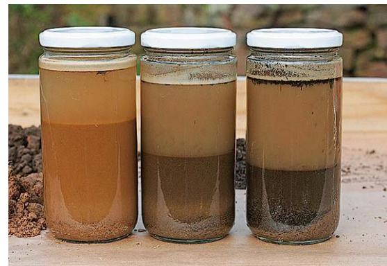
In Wasser gelöst, werden die Bodenbestandteile sichtbar: Sand sinkt schnell ab, Ton dagegen schwebt lange im Wasser
