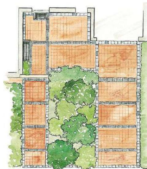
Der Grundriss zeigt deutlich die durchlaufenden Querbander aus doppeltem Granit-Kleinpflaster und die Umrandung aus größeren Granitsteinen, die die Flächen aus roten Pflasterklinkern einfassen
