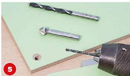
**5** Damit die Löcher nicht ausreißen, mit einem 3-mm-Bohrer vorbohren. Beidseitig ansenken und zuletzt mit einem 8-mm-Bohrer durchbohren.
