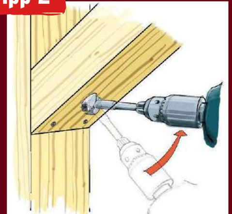
Das schräge Sackloch: Setzen Sie dazu den Forstnerbohrer in einem Winkel von  $90^\circ$  an der Strebe an. Bohren Sie etwa 5 mm tief in die Strebe und neigen den Bohrer während des Bohrvorgangs langsam um  $45^\circ$ , sodass die Bohrung in einem Winkel von  $45^\circ$  durch die Strebe verläuft. Anschließend das Durchgangslloch für die Schraube bohren.
