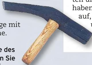
Mit der gebogenen Finne des Pflasterhammers lockern Sie auch die Tragschicht auf
