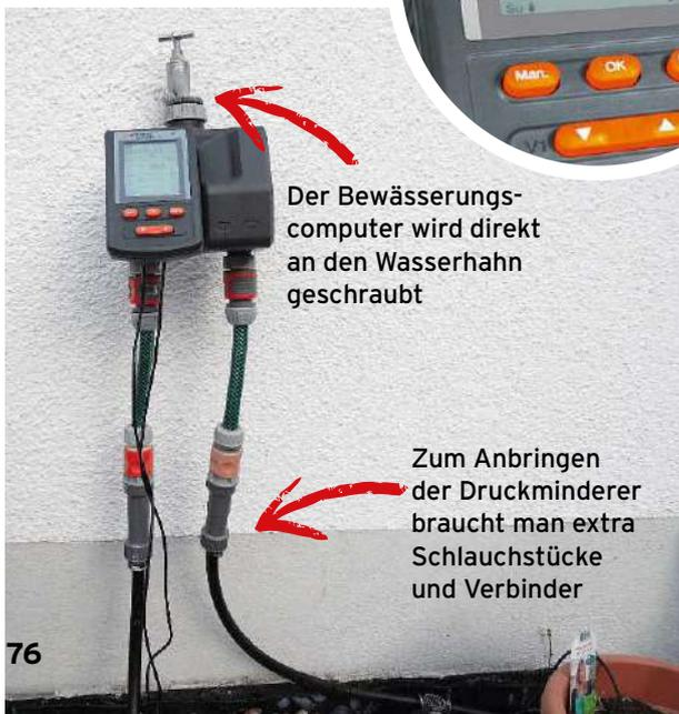
Der Bewässerungscomputer wird direkt an den Wasserhahn geschraubt
