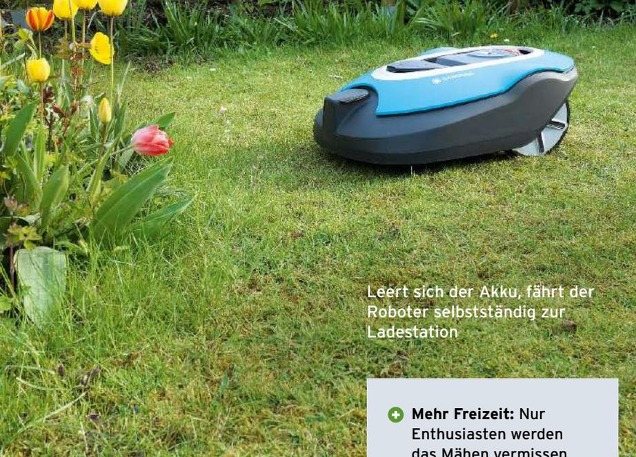
Leert sich der Akku, fährt der Roboter selbstständig zur Ladestation
